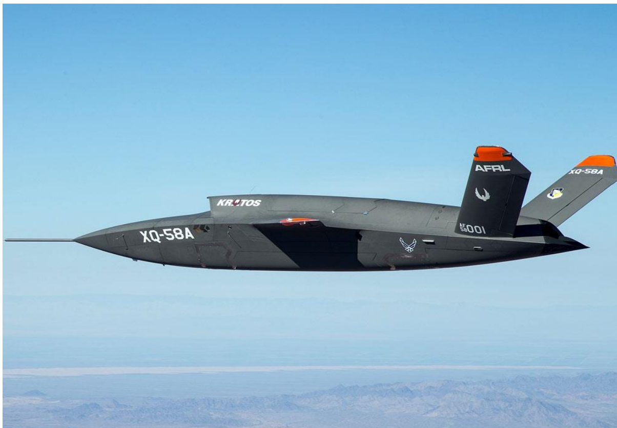
Slika 1.1. Bepilotna letjelica Kratos XQ-58 A [1]
