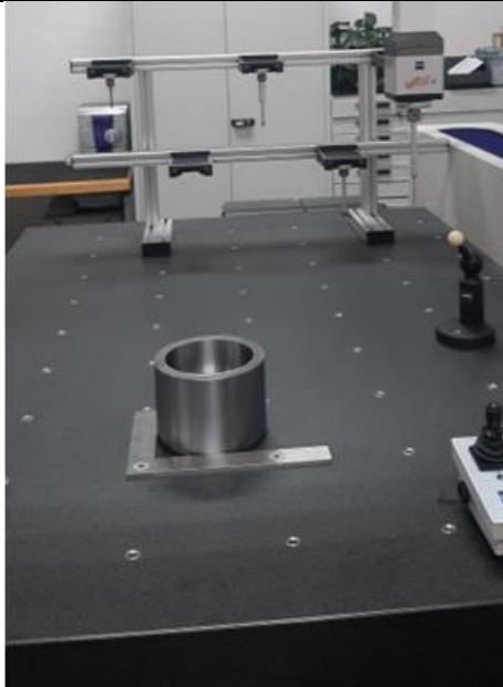
**Slika 7-14 Provjera kvalitete obradene površine**
