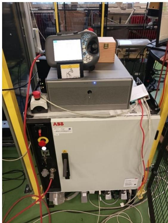
Slika 7. Upravljačka jedinica IRC5 spojena sa operatorskim panelom
