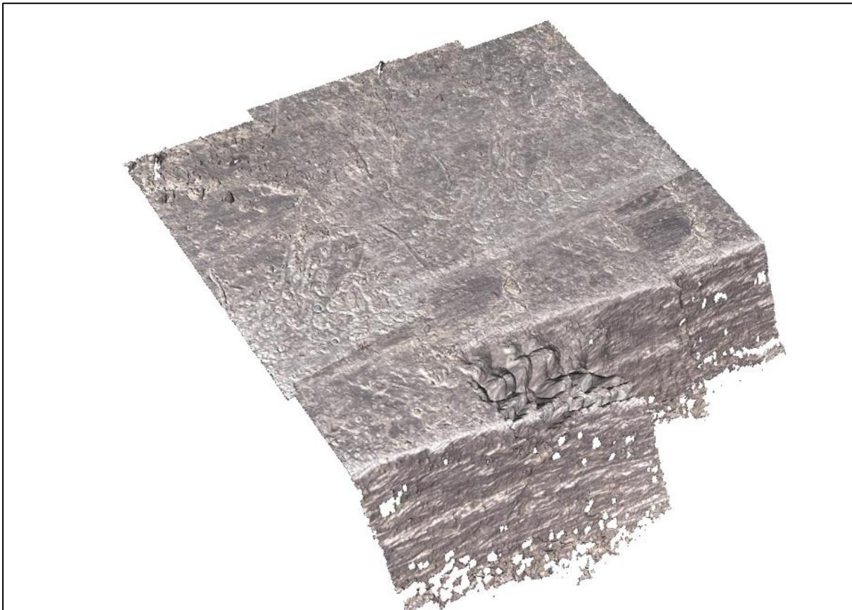
**Slika 53. Rezultat drugog skeniranja i spajanja površina**
