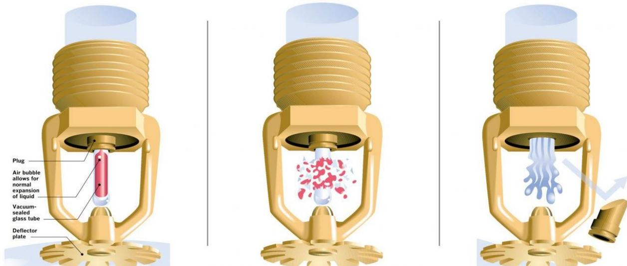
Slika 2.4 Aktivacija prskalice uslijed povisene temperature [7]
