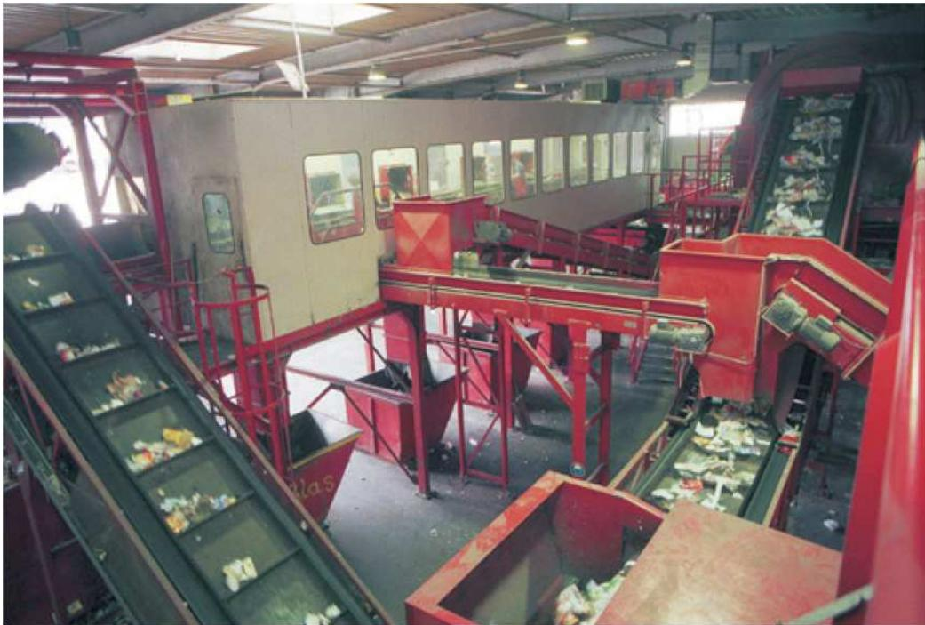
Slika 2.5. Postrojenje za preradbu komunalnog otpada u Njemačkoj [5]
