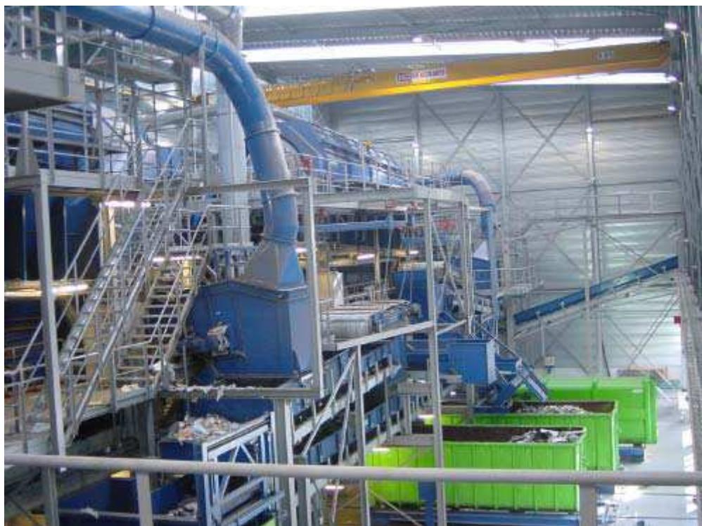
Slika 2.14. Dio postrojenja za mehaničku obradu otpada [7]
