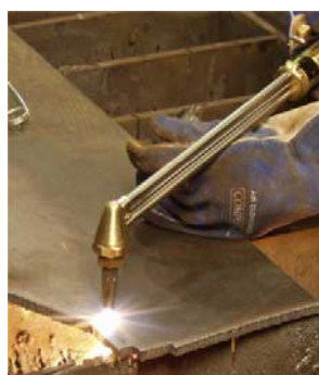
Slika 29. Ručno plinsko rezanje.
