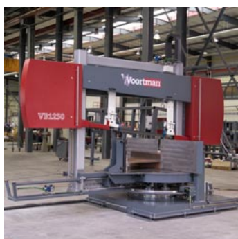
Slika 28. CNC tračna pila [26].
