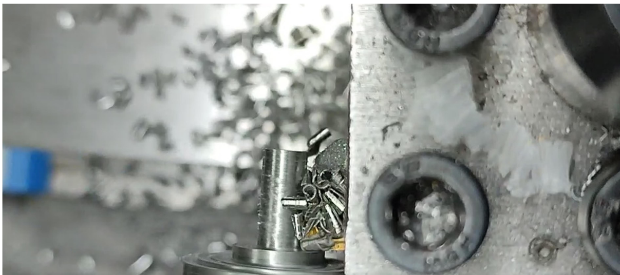
Slika 30 Izrada osovine sa prirubnicom na koju se montira natezna remenica (crtež broj 01-02-05)
