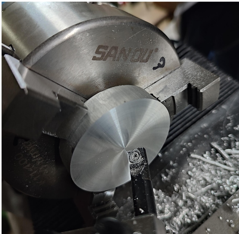
Slika 32 Izrada ležajnih mjesta, operacija poprečnog tokarenja (facing) (crtež broj 01-01-02)
