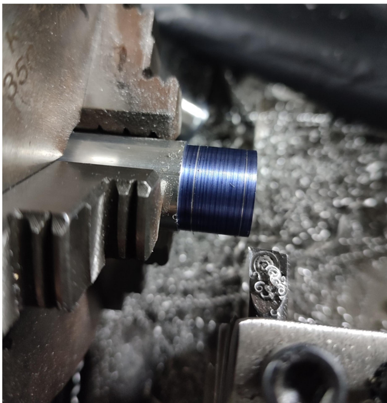
Slika 26 Tokarenje vanjskog promjera remenice za natezanje remena (crtež broj 01-02-04)
