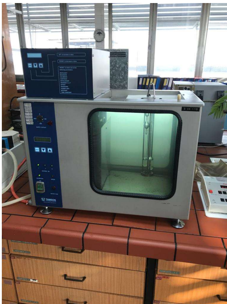
Slika 8. Kapilarni viskozimetar za mjerenje kinematičke viskoznosti pri 100°C
