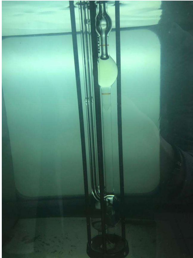
Slika 9. Krupni plan kapilare unutar kapilarnog viskozimetra
