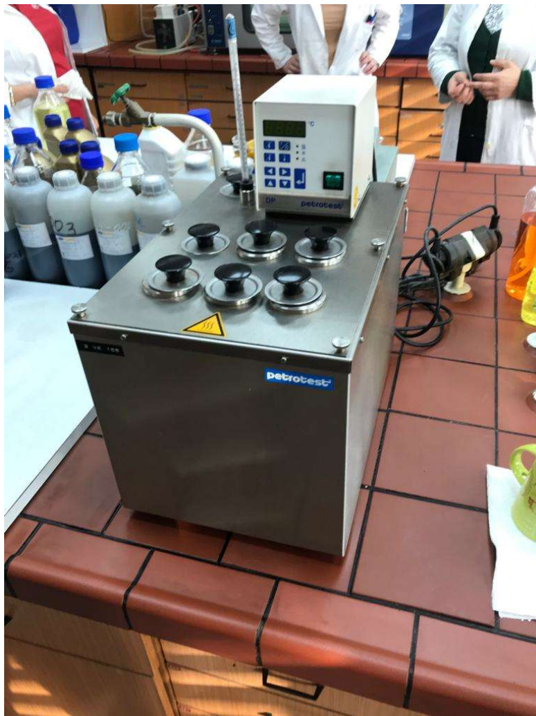
Slika 13. Uređaj za ispitivanje oksidacijske otpornosti ulja za kaljenje
