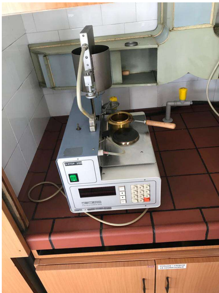
Slika 11. Automatski uređaj za određivanje točke plamišta
