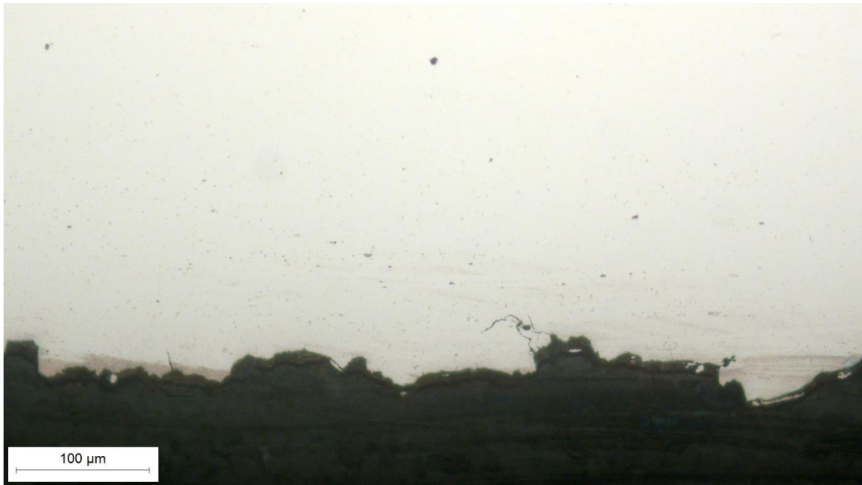
Slika 25. Uzdužni presjek ruba pukotine, snimljen pri povećanju 200×
