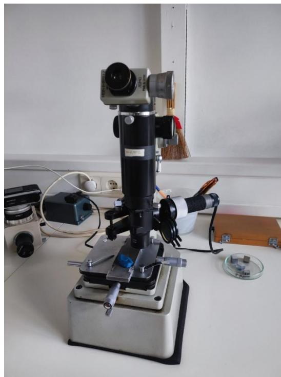
Slika 37. Uređaj za mjerenje mikrotvrdoće
