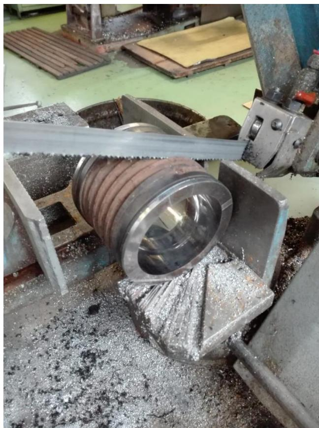
Slika 12. Izrezivanje uzorka na tračnoj pili
