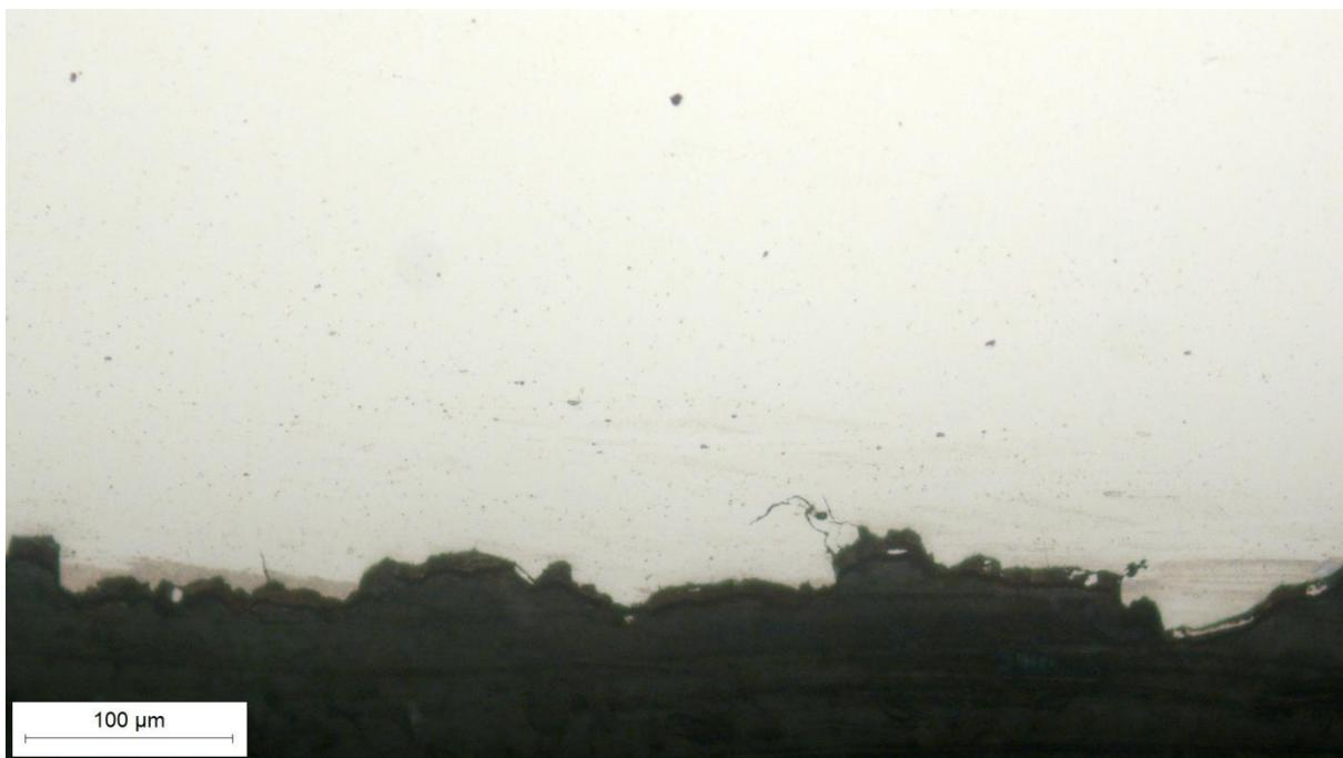
Slika 25. Uzdužni presjek ruba pukotine, snimljen pri povećanju 200×
