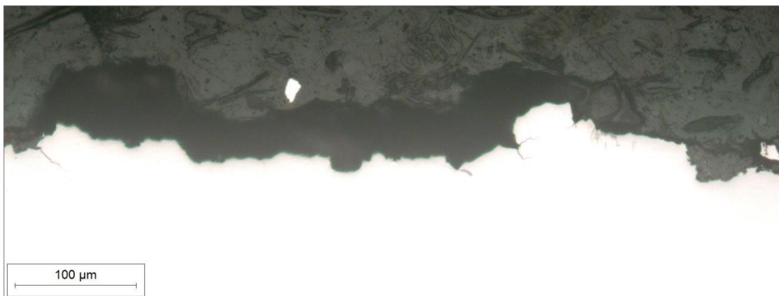
Slika 20. Poprečni presjek kroz stijenu kalupa uz rub pukotine, snimljen pri povećanju 200×
