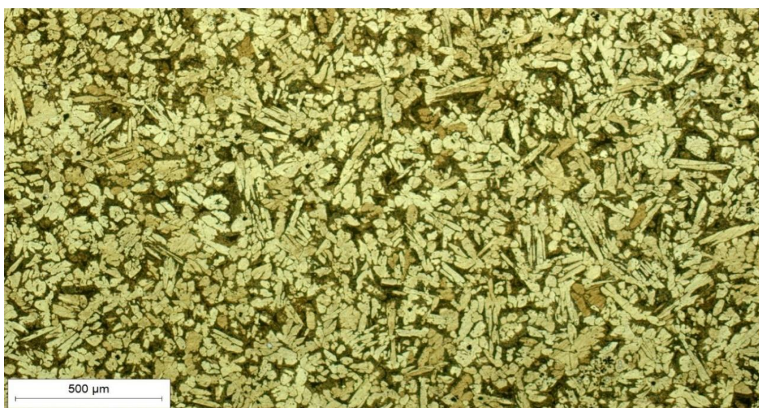
Slika 22. Osnovni materijal u nagrizenom stanju, snimljeno pri povećanju 50×
