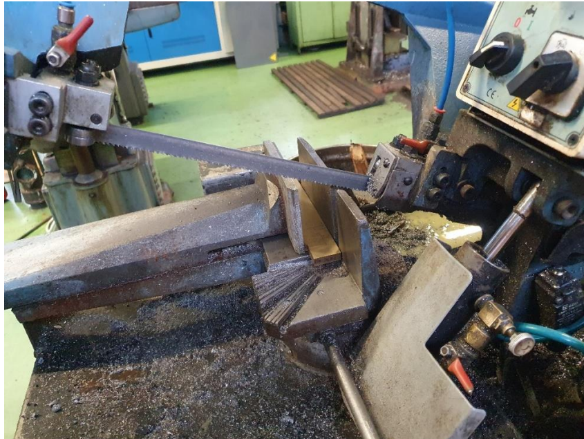
Slika 13. Rezanje uzoraka na strojnoj pili
