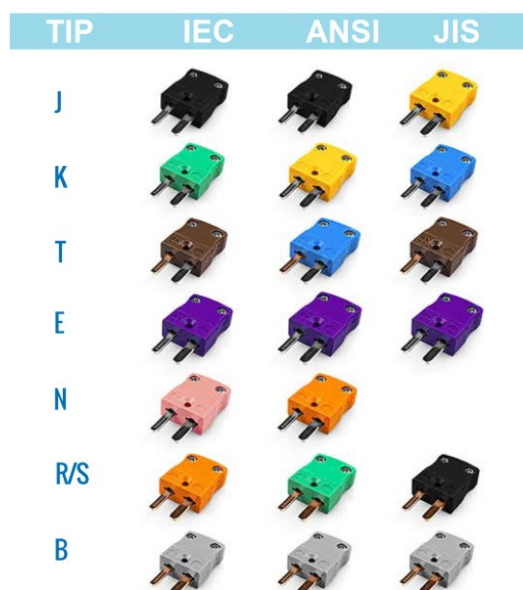
Slika 21. Medunarodne boje konektora termoelementa [34]
