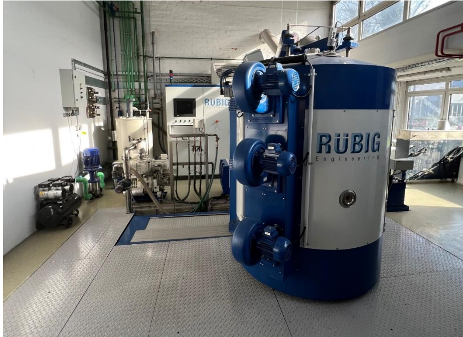
Slika 22. Uređaj za prevlačenje Rübige 70/90 na FSB-u Zagreb
