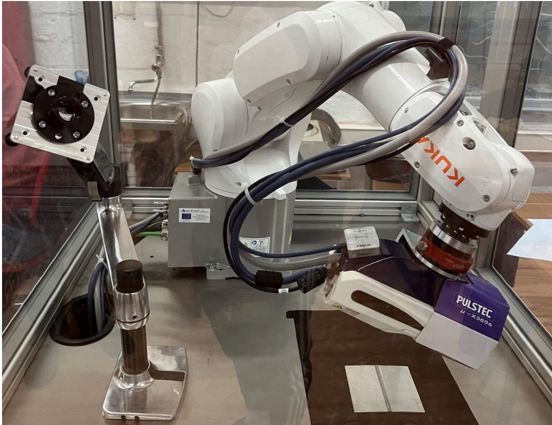
Slika 19. Uređaj PULSTEC \mu -X360s instaliran u Laboratoriju za zavarivanje na Fakultetu strojarstva i brodogradnje Zagreb
