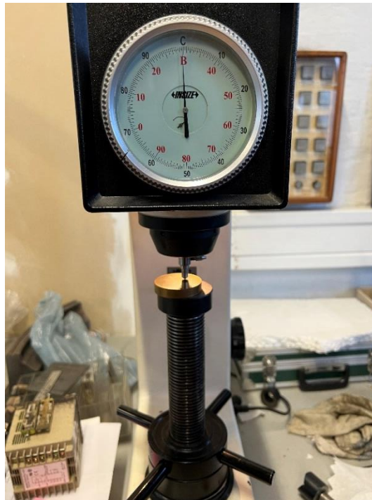
Slika 32. Utiskivanje Rockwell C indentora u prevlaku TiN
