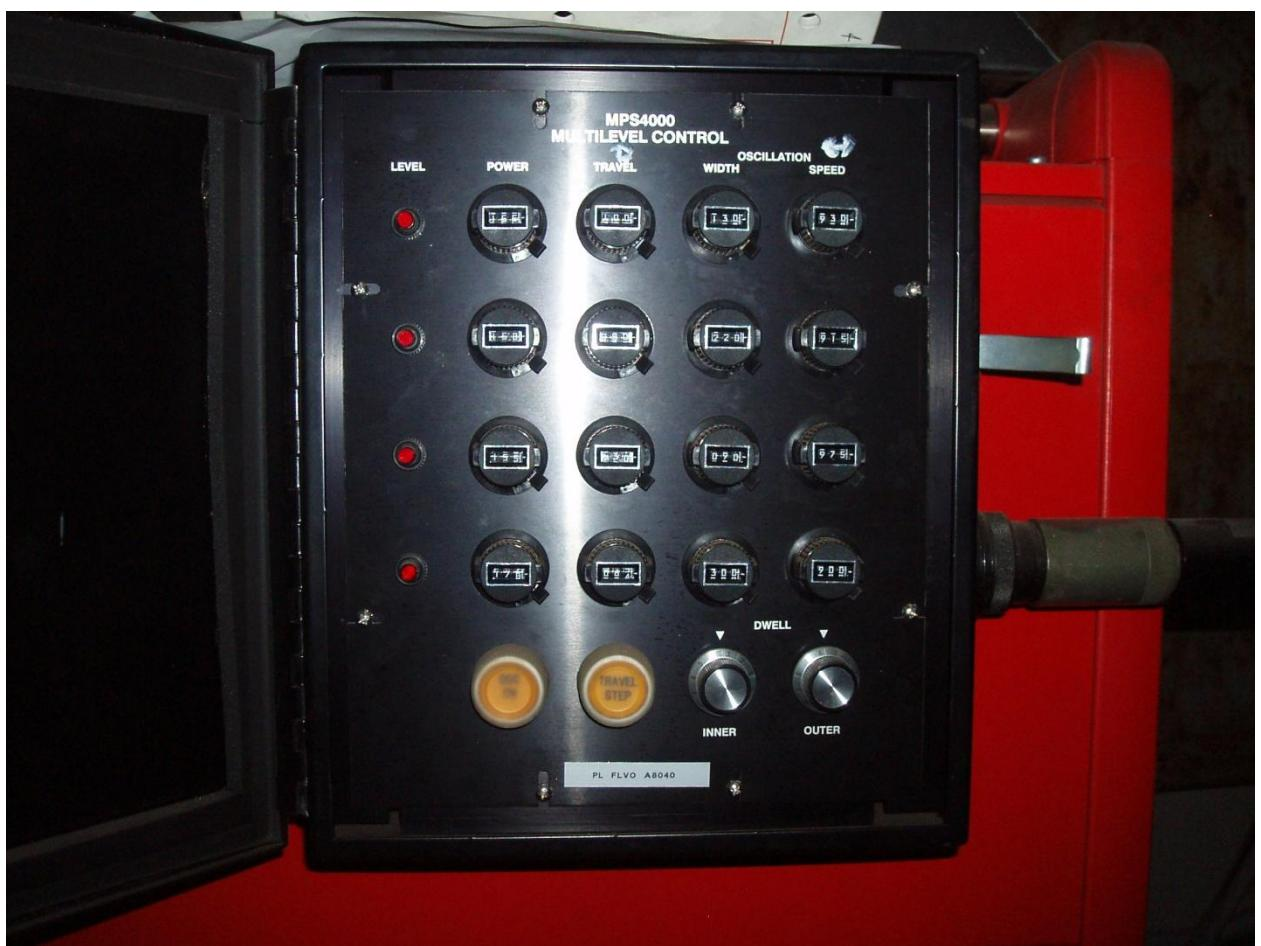
*Slika 6.6 Višekanalni programator MPS 4000 MULTILEVEL CONTROL*
