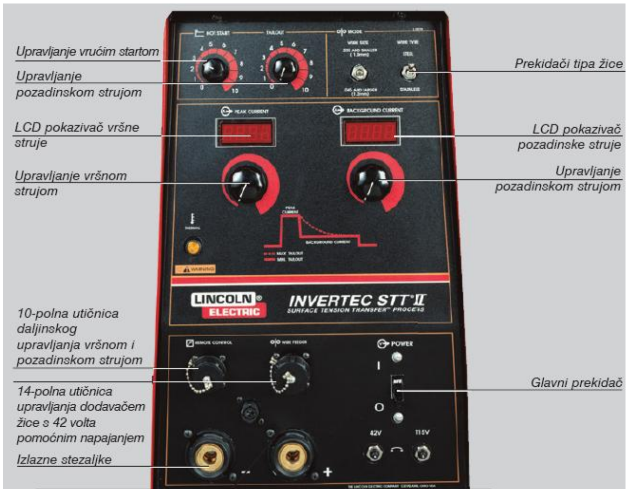
Slika 3.5 Prikaz upravljačke ploče STT uređaja za zavarivanje [7]
