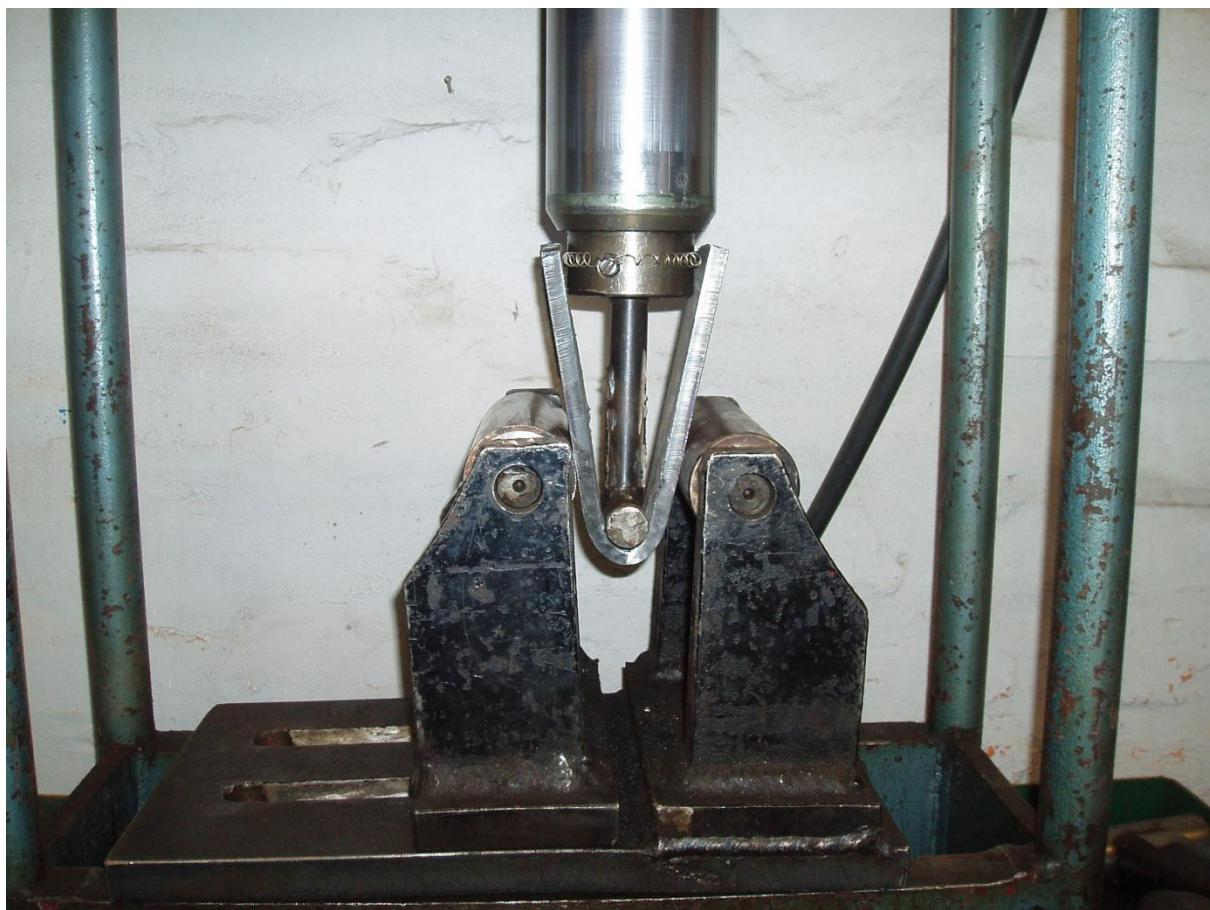
Slika 7.17 Ispitivanje savijanjem po HRN EN ISO 910
