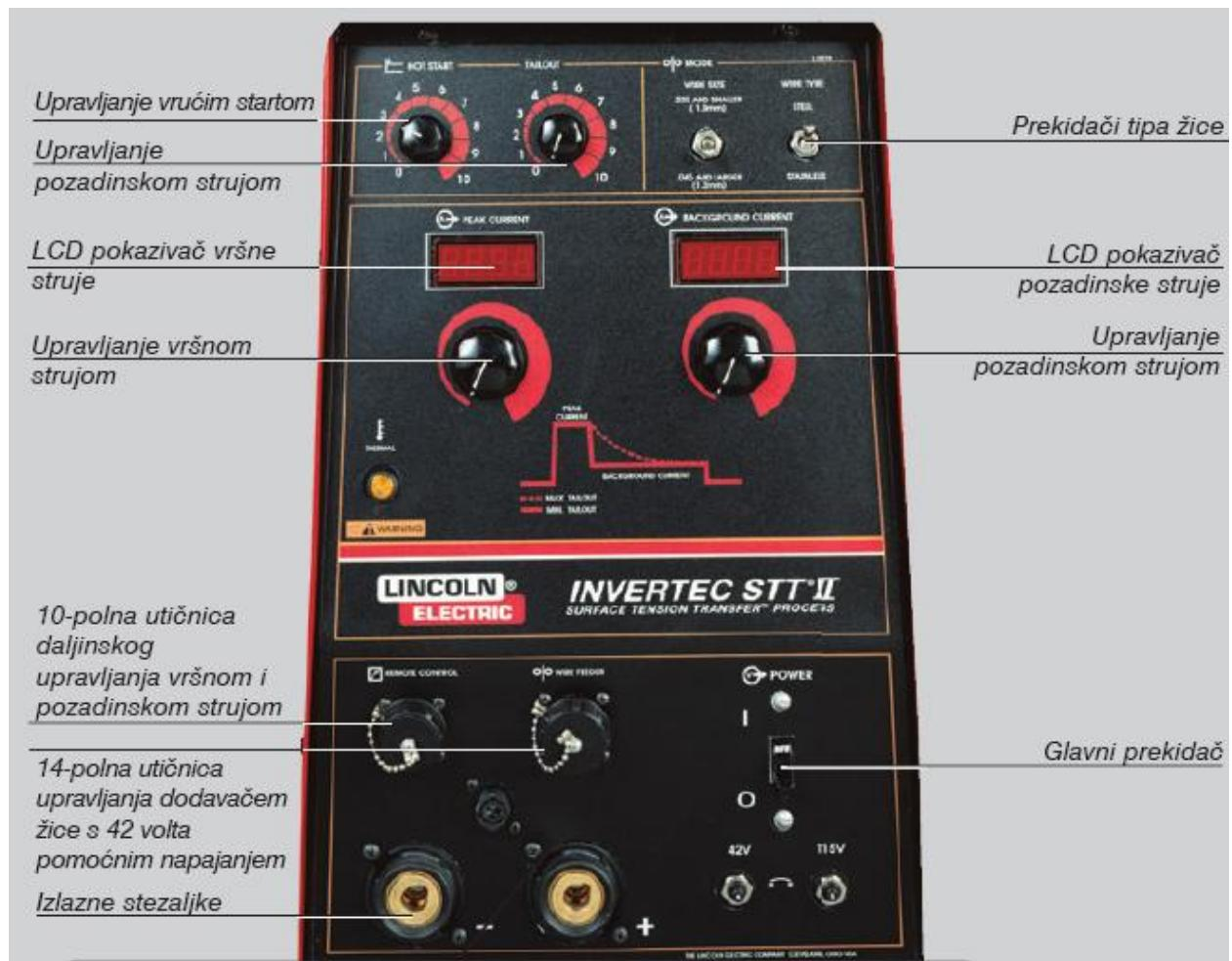
Slika 3.5 Prikaz upravljačke ploče STT uređaja za zavarivanje [7]
