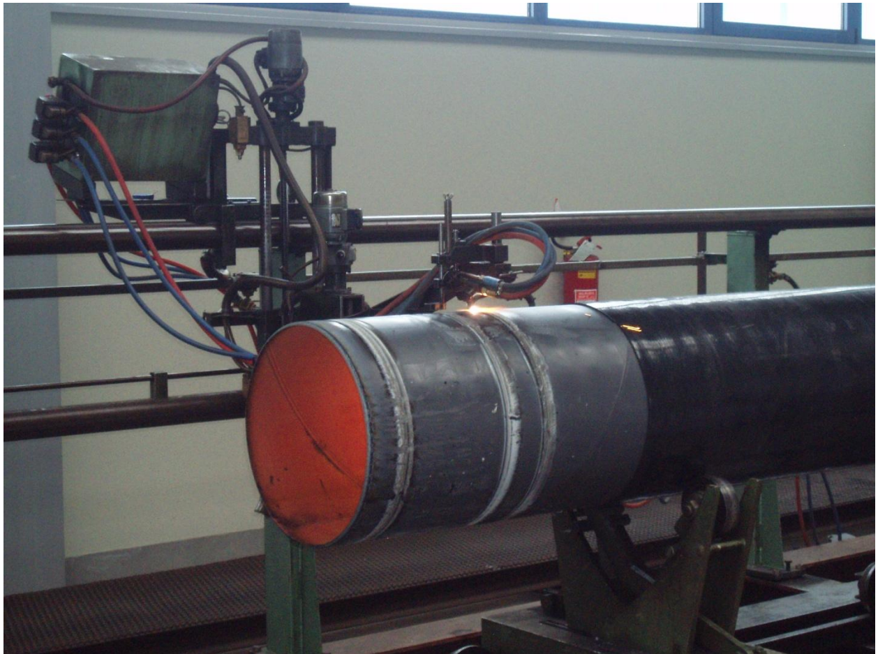
Slika 7.4 Rezanje cijevi automatskom plinskom rezačicom
