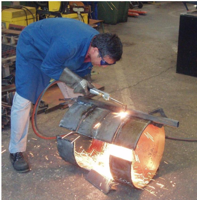
Slika 7.13 Izrezivanje epruveta
