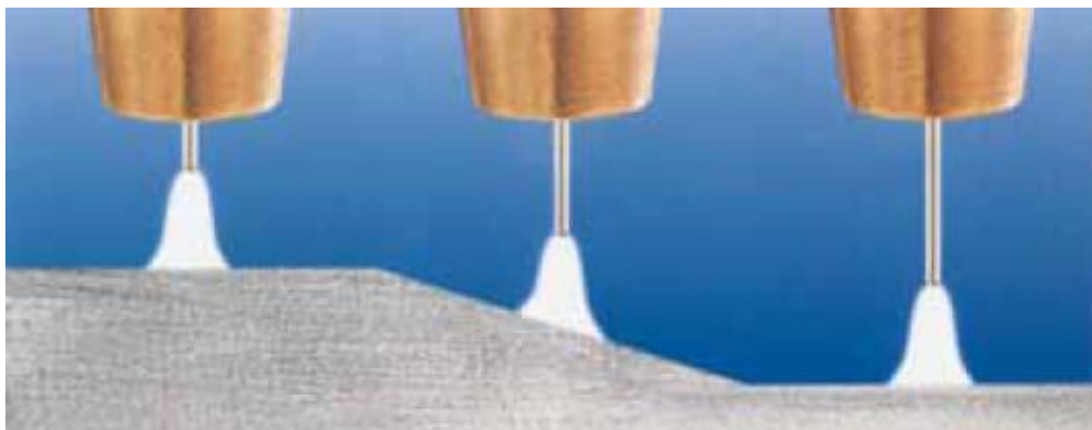
Slika 6.4 Promjena duljine slobodnog kraja žice ( l_{s\dot{z}} ) uslijed loše pripreme zavarenog spoja [13]
