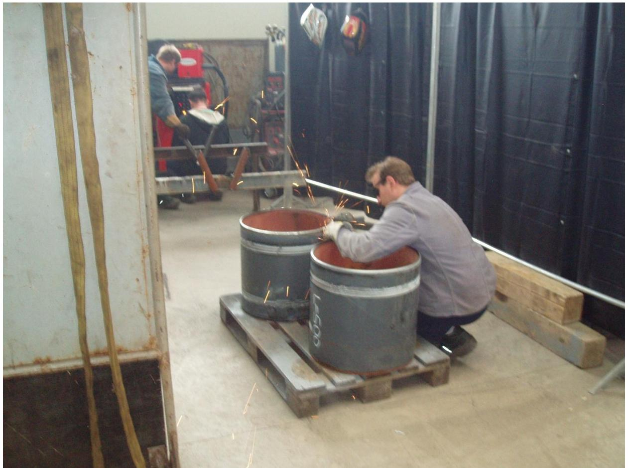
*Slika 7.5 Priprema spoja brušenjem*
