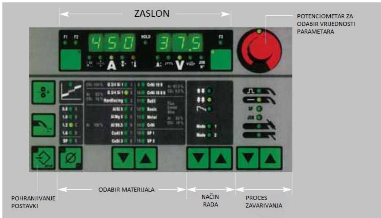
Uz MPS 4000 izvor za zavarivanje, moguće je uskladiti i višekanalni programator koji je moguće programirati za četiri različita prolaza kod višeslojnog zavarivanja cijevi. Programator se fiksira na sam uređaj za zavarivanje te se nakon programiranja parametara zavarivačke glave vrata višekanalnog programatora mogu mehanički osigurati i spriječiti neovlaštenu promjenu parametara.
