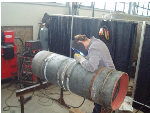
Slika 7.6 a) Zavarivanje STT postupkom- 12sati
