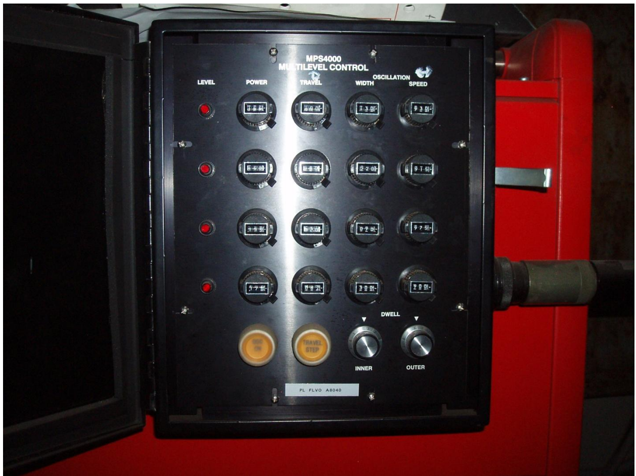
Slika 6.6 Višekanalni programator MPS 4000 MULTILEVEL CONTROL
