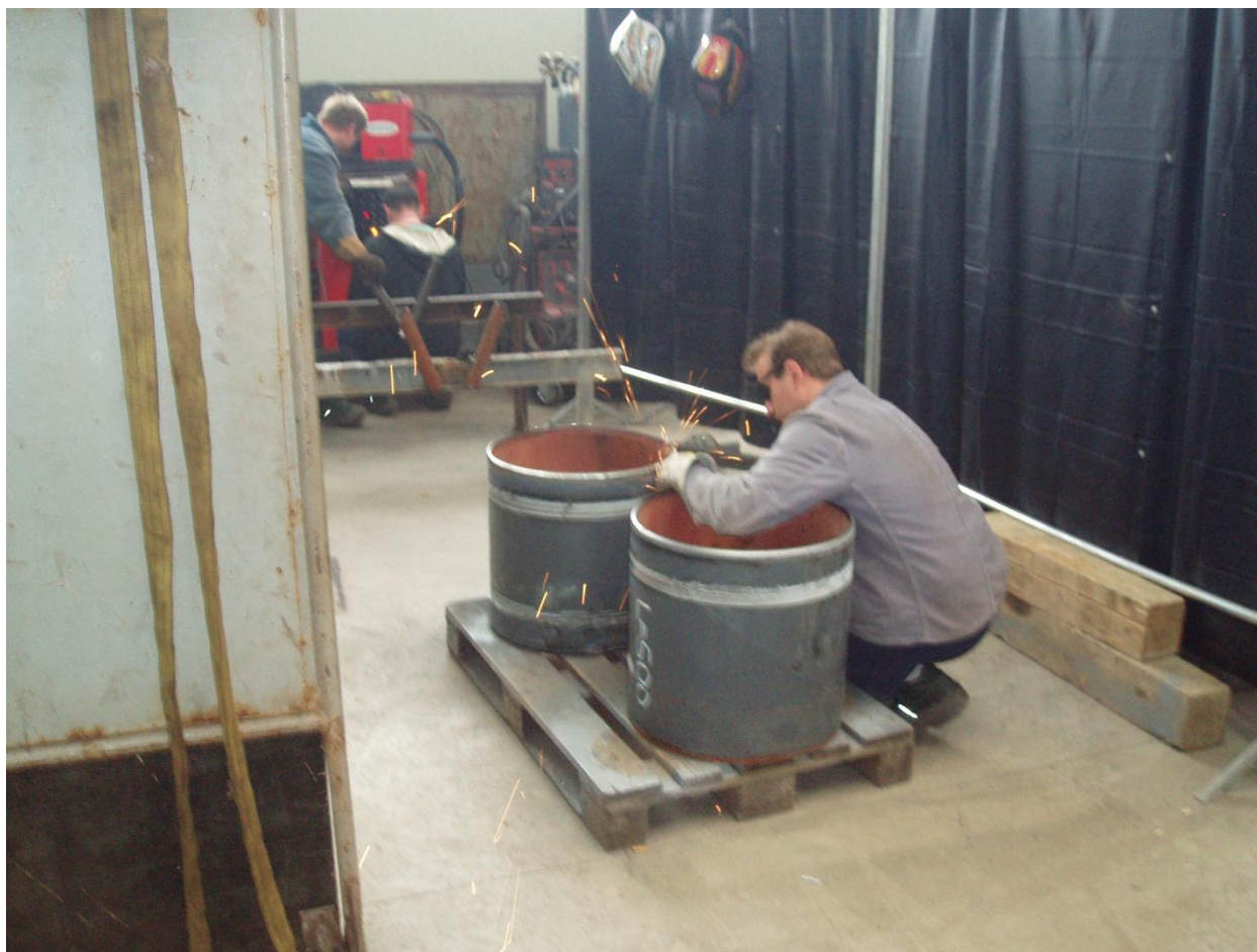
Slika 7.5 Priprema spoja brušenjem
