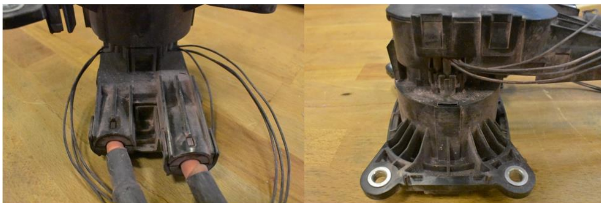
Slika 27. Ispitni primjerak onečišćen kontaminantima
