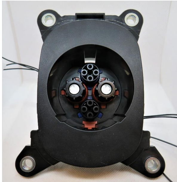
Slika 3. CHAdeMO standardizirana utičnica
