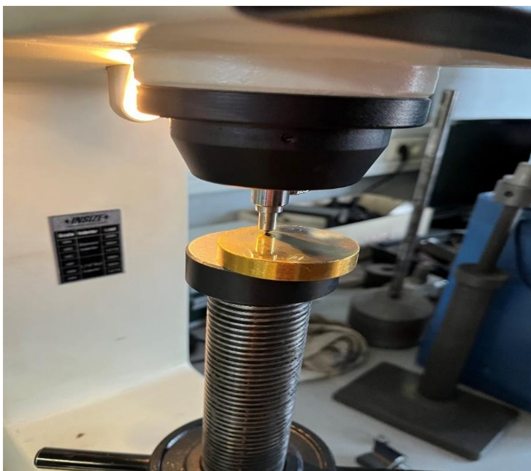
Slika 19. Ispitivanje prionjivosti prevlake TiN dijamantnim indentorom prema normi VDI 3198:1991
