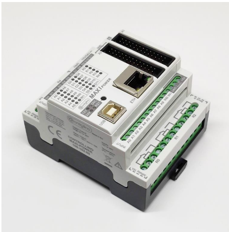
Slika 12. Mikrokontroler „CONTROLLINO MAXI Power“ [7]
