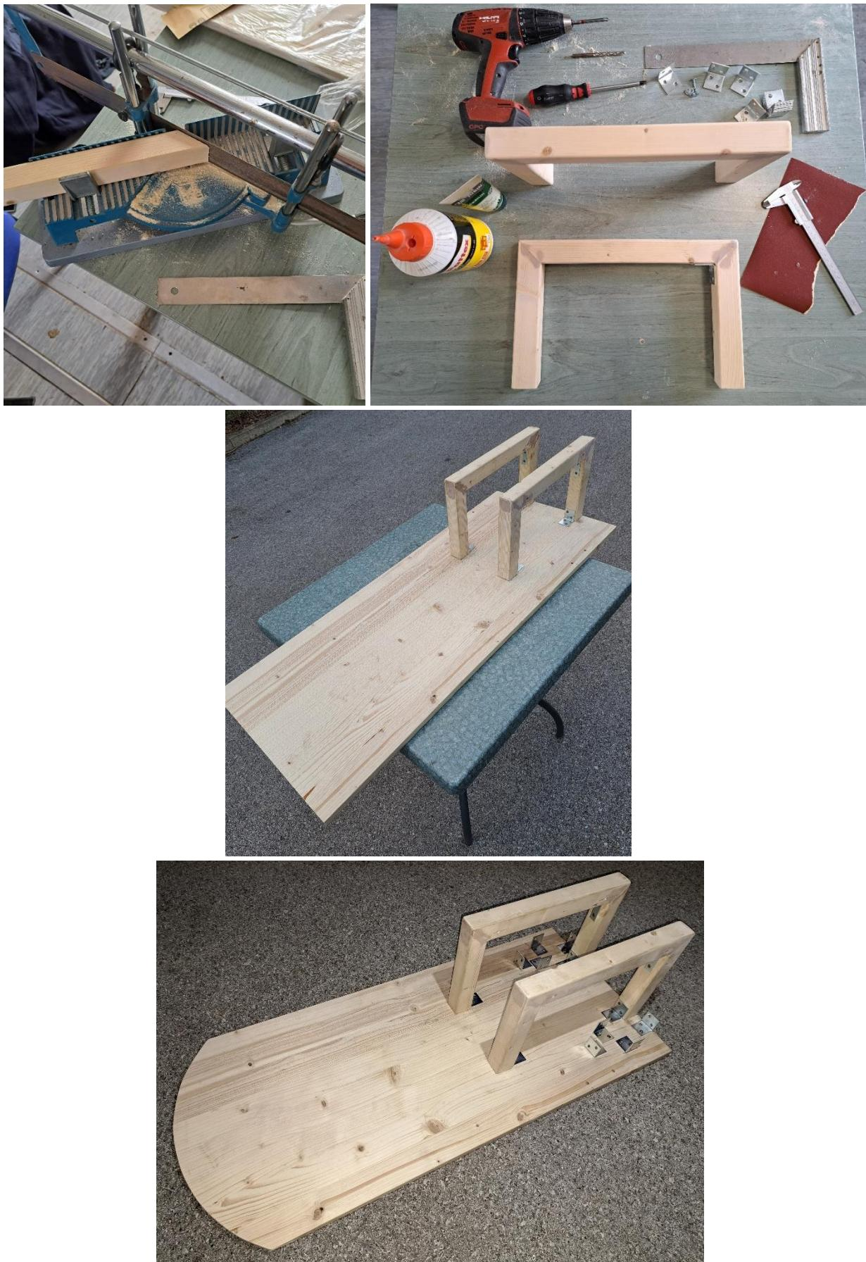
Slika 24. Izrada konstrukcije mobilnog vozila
