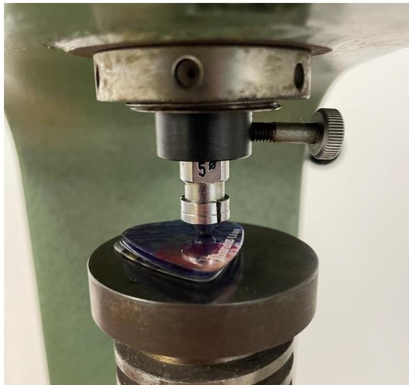
Slika 27. Uzorci postavljeni na postolje tvrdomjera Zwick 3106
