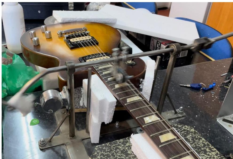
**Slika 31. Gitara postavljena i učvršćena u napravi za ispitivanje trošenja**
