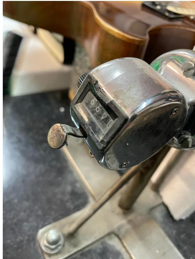
Slika 32. Brojčanik na napravi za ispitivanje trošenja
