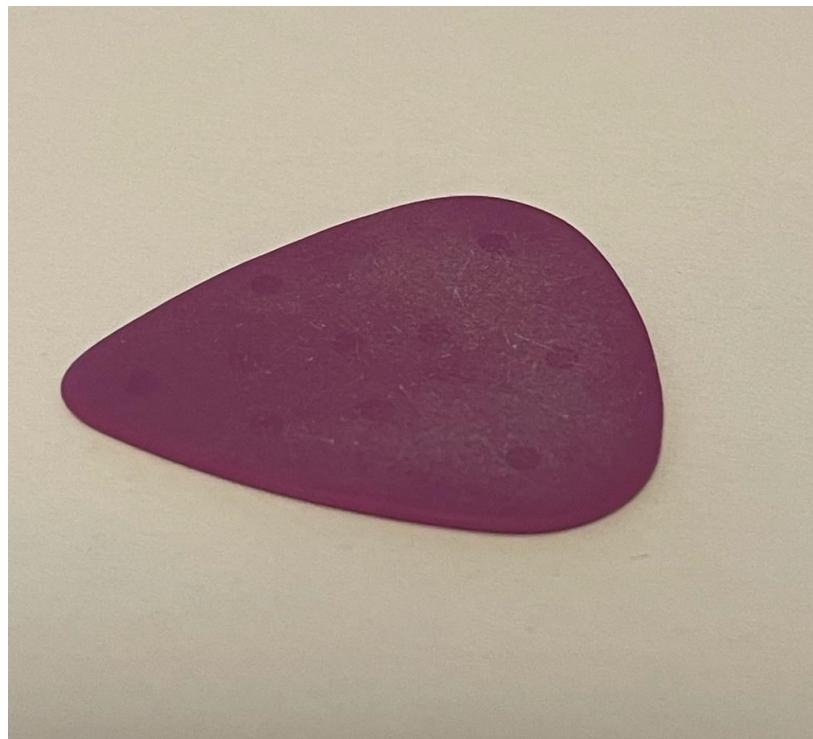
Slika 28. Uzorak trzalice nakon mjerena tvrdoće
