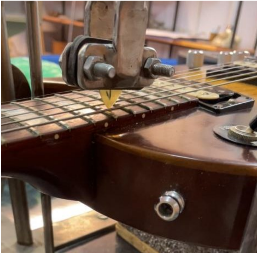
Slika 34. Trzalica postavljena u čeljusti
