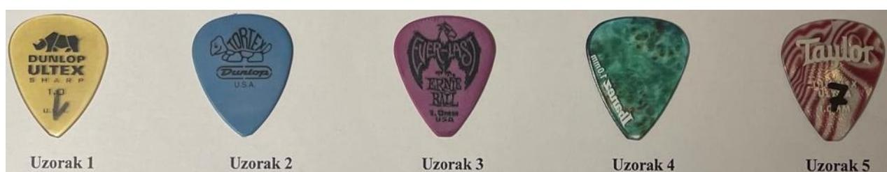
**Slika 38. Uzorci trzalica nakon provedenog ispitivanja trošenja**
