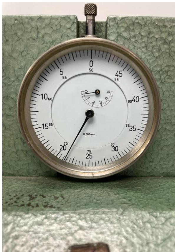
Slika 26. Mjerna skala na tvrdomjeru Zwick 3106
