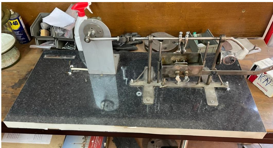
**Slika 30. Uređaj za ispitivanje trošenja**
