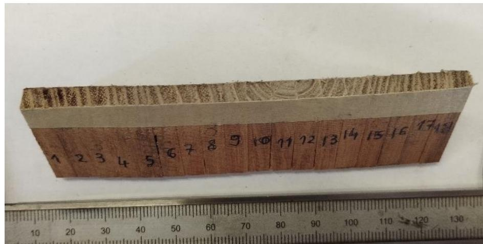
Slika 5.6. Uzorci za ispitivanje na abrazijsko trošenje
