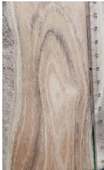
Slika 5.3. Tangencijalni presjek drva bagrema
