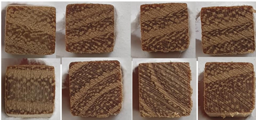
Slika 5.11. Abradirane površine uzoraka s različitim udjelima kasnog goda
