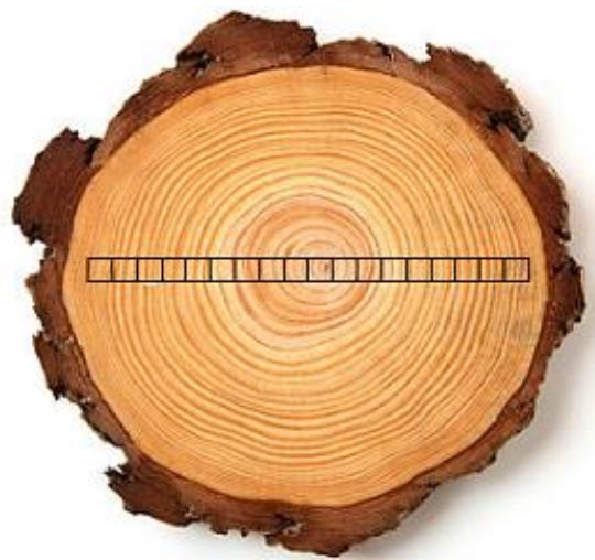
Slika 5.5. Položaj uzoraka na poprečnom presjeku
