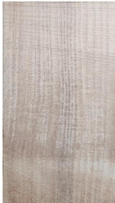
Slika 5.2. Radijalni presjek drva bagrema
