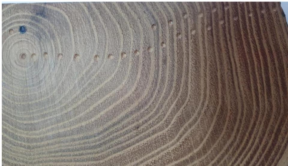
**Slika 5.14. Otisci mjerena tvrdoće na poprečnom presjeku**
