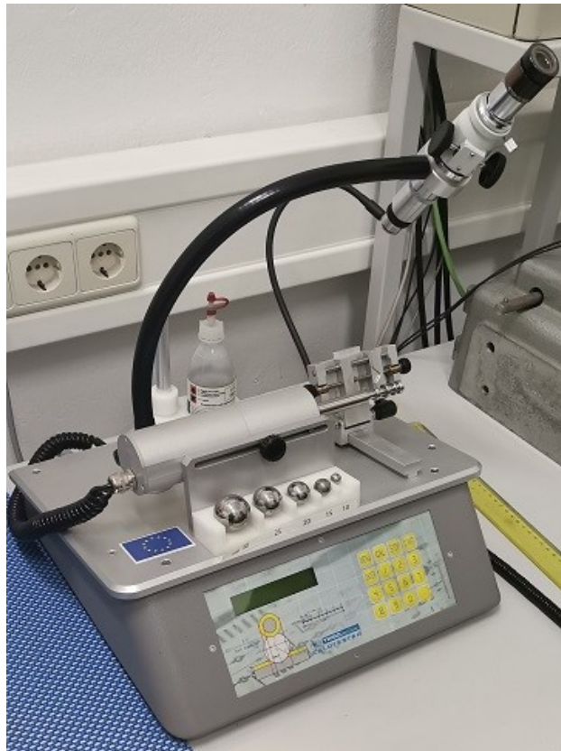
Slika 29. Uređaj za ispitivanje debljine prevlake tvrtke TRIBOtechnic
