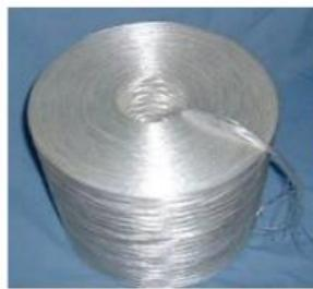
**Slika 8.Strukovi staklenog vlakna**
