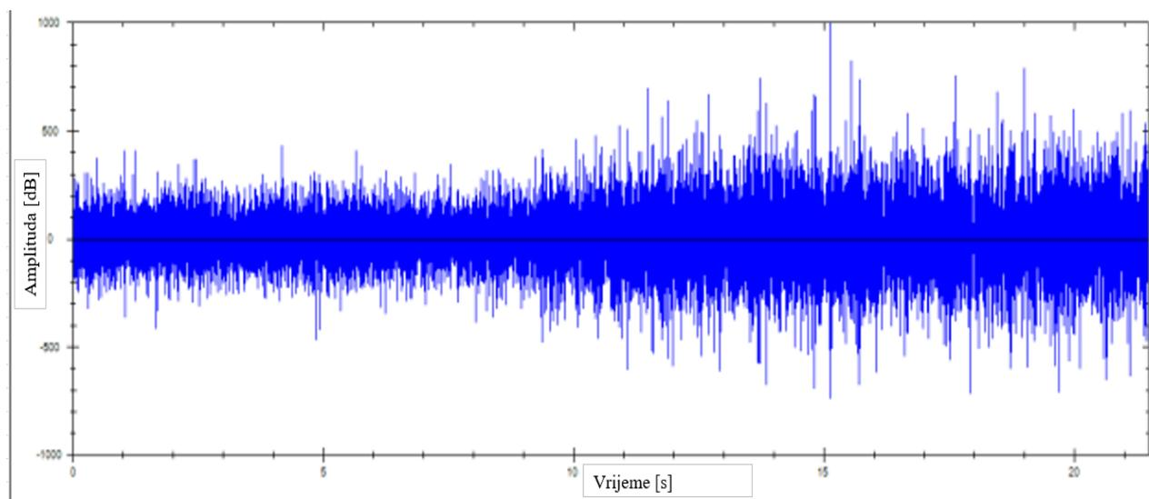
**Slika 14. Primjer vremenskog signala loše podmazanog ležaja [2]**
