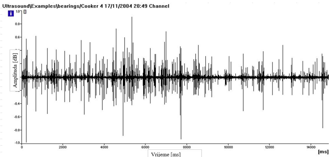
Slika 8. Prikaz vremenske domene oštećenog ležaja [2]
