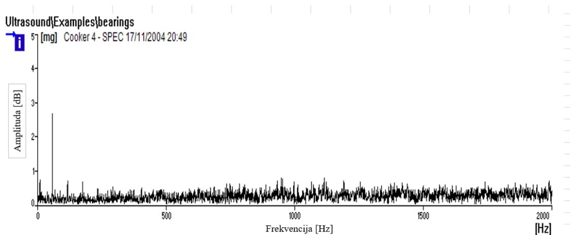
Slika 9. Prikaz frekvencijske domene oštećenog ležaja [2]
