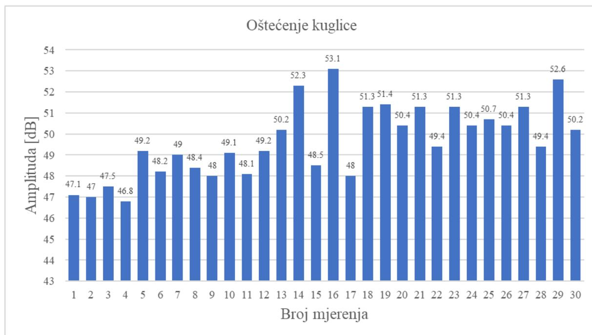
**Slika 31. Graf vrijednosti mjerenja amplitude ležaja oštećene kuglice**
