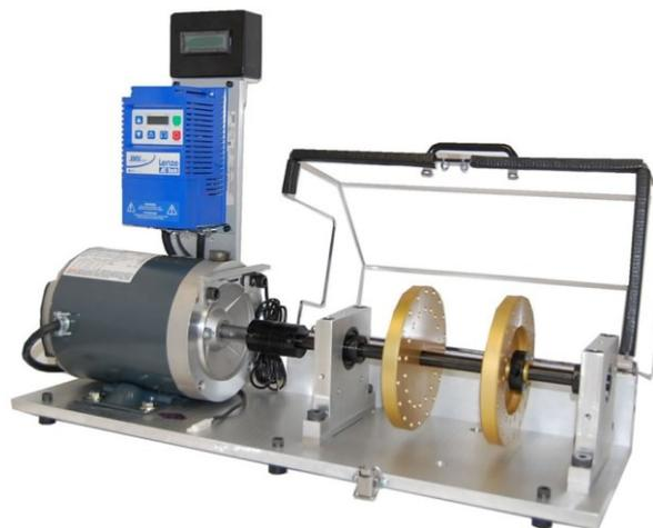
**Slika 25. Simulator kvarova ležaja [9]**
