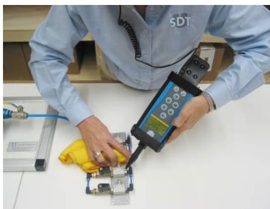
Slika 2. Zaštita od drugog izvora pomoću krpe [2]
