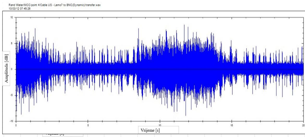
Slika 21. Prikaz vremenskog signala električnog luka [2]
