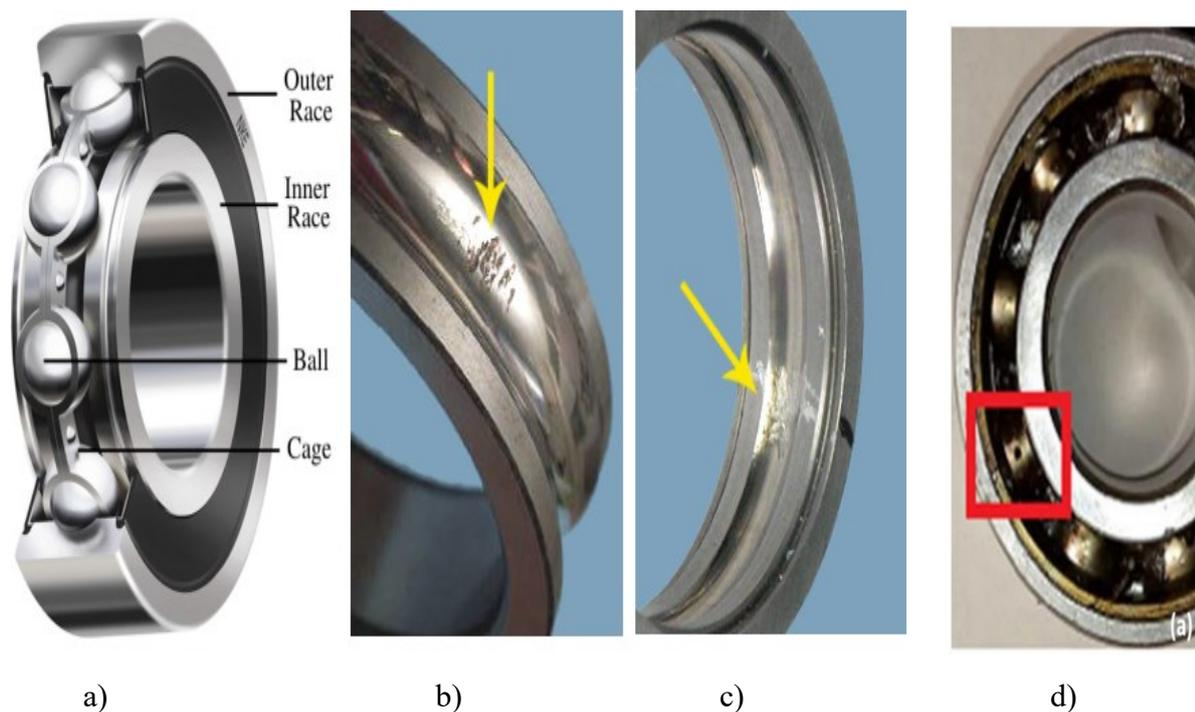
**Slika 29. Primjeri oštećenja kugličnog ležaja; a) Normalan ležaj; b) Ležaj sa oštećenjem vanjskog prstena; c) Ležaj sa oštećenjem unutarnjeg prstena; d) Ležaj sa oštećenom kuglicom ; [12]**
