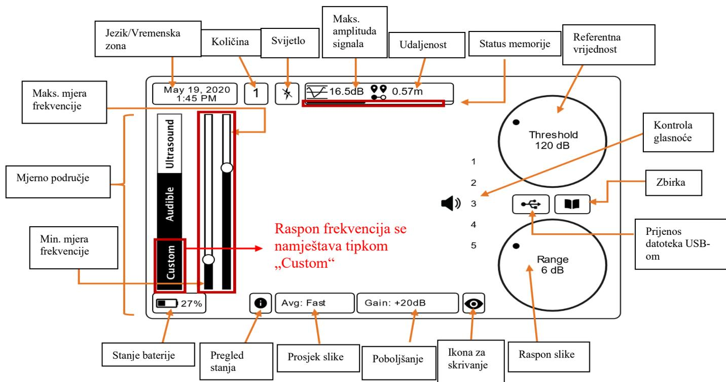
Slika 24. Prikaz zaslona za upravljanje ultrazvučnom kamerom[8]
