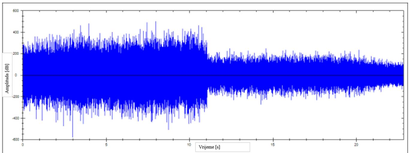
**Slika 13. Primjer vremenskog signala dobro podmazanog ležaja [2]**
