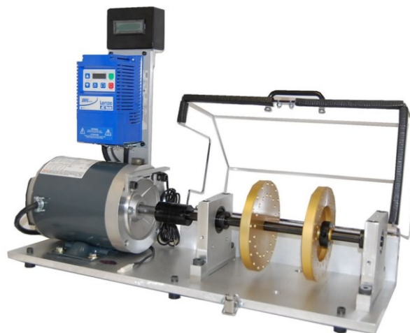
Slika 25. Simulator kvarova ležaja [9]
