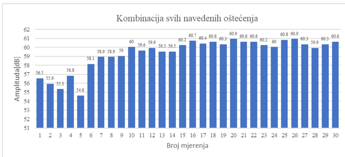
Slika 37. Graf vrijednosti mjerenja amplitude ležaja svih kvarova
