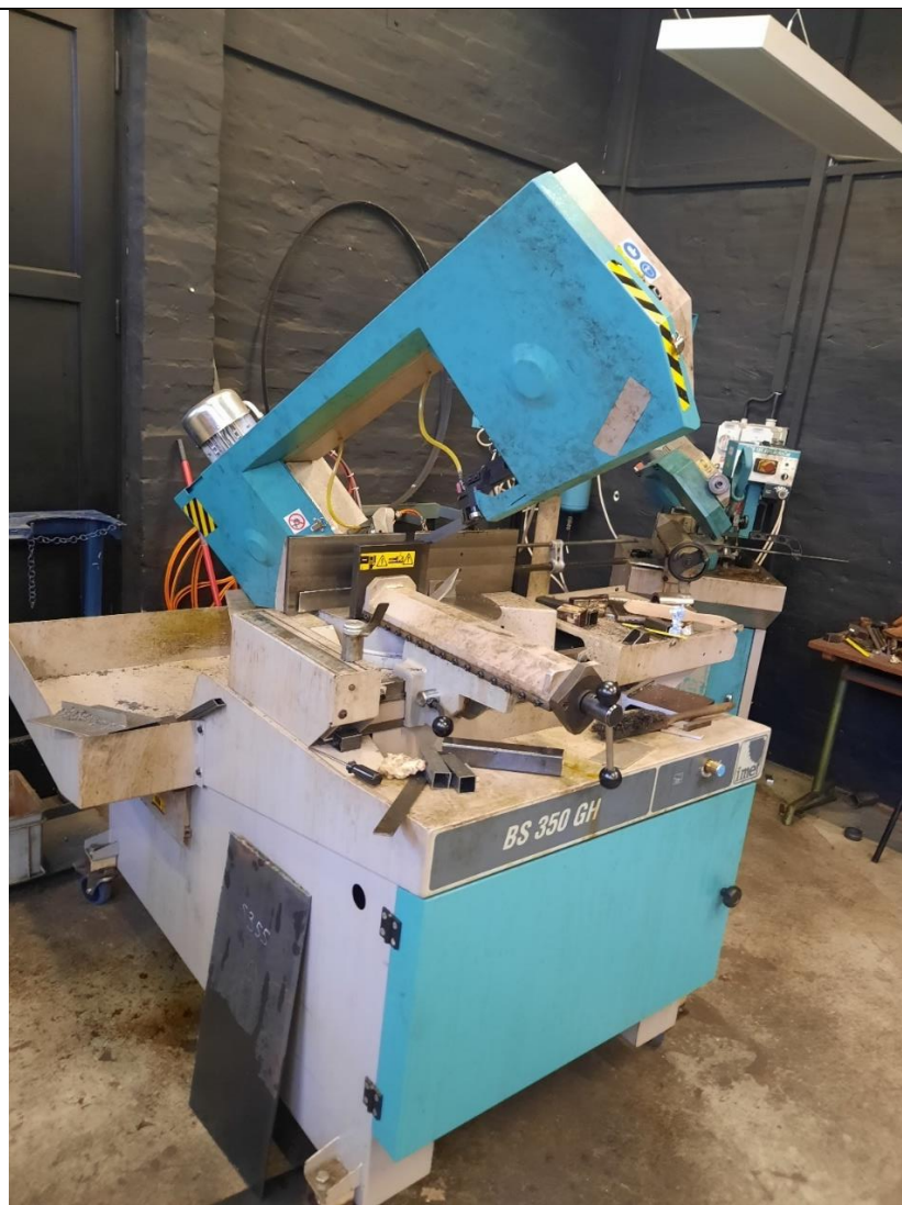
Slika 16. Tračna pila korištena za rezanje uzoraka
