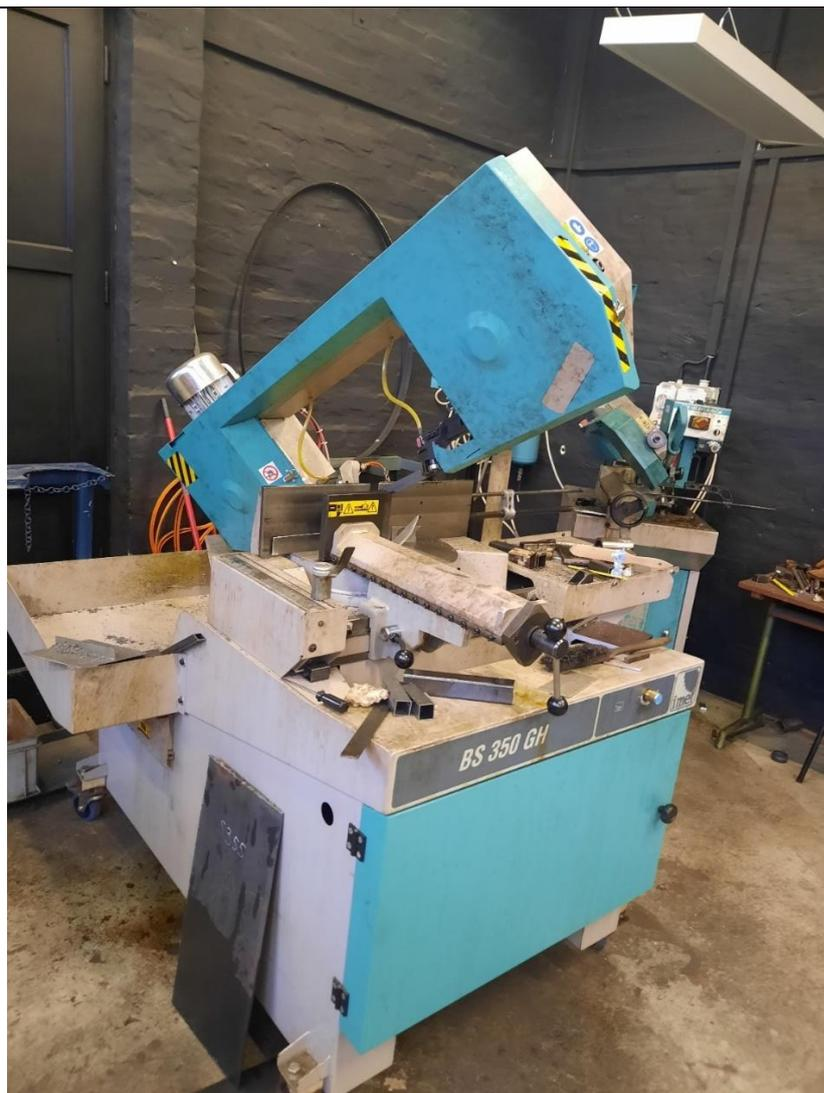
**Slika 16. Tračna pila korištena za rezanje uzoraka**
