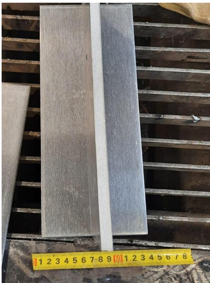
Slika 13. Uzorci spremni za zavarivanje
