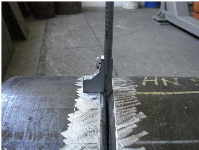
Slika 14. Mjerilo za mjerenje posmaknutosti
