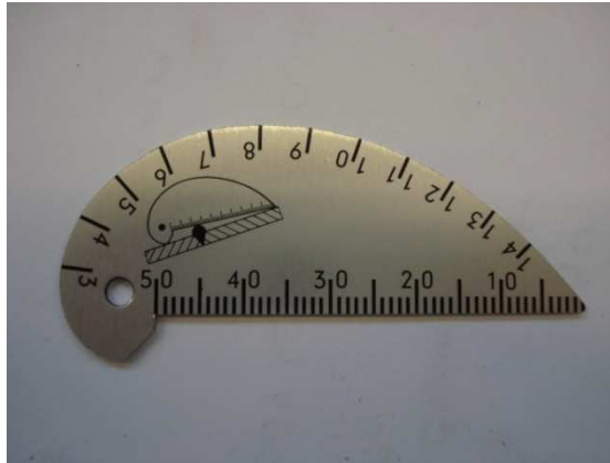
Slika 3. Jednostavno mjerilo za zavarene spojeve
