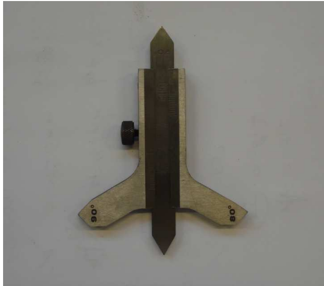
Slika 8. Mjerilo s nonijusom
