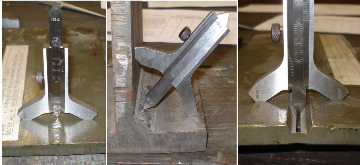
Slika 9. Mjerilo s nonijusom- pravilno korištenje
