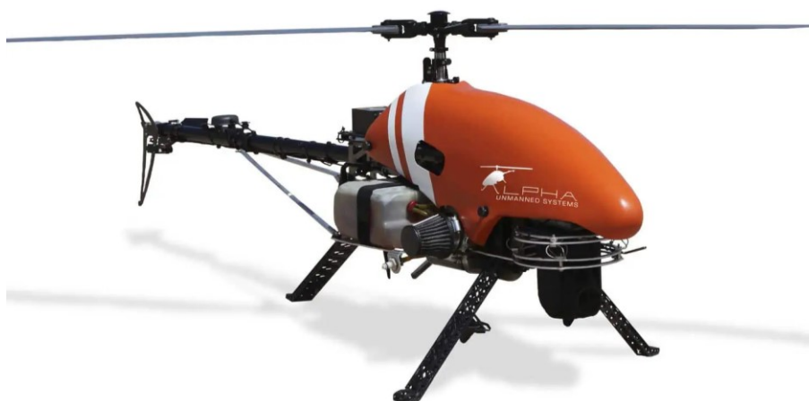
Slika 8. Primjer besposadne letjelice s jednim glavnim rotorom – Alpha 800 tvrtke Alpha Unmanned Systems [21]
