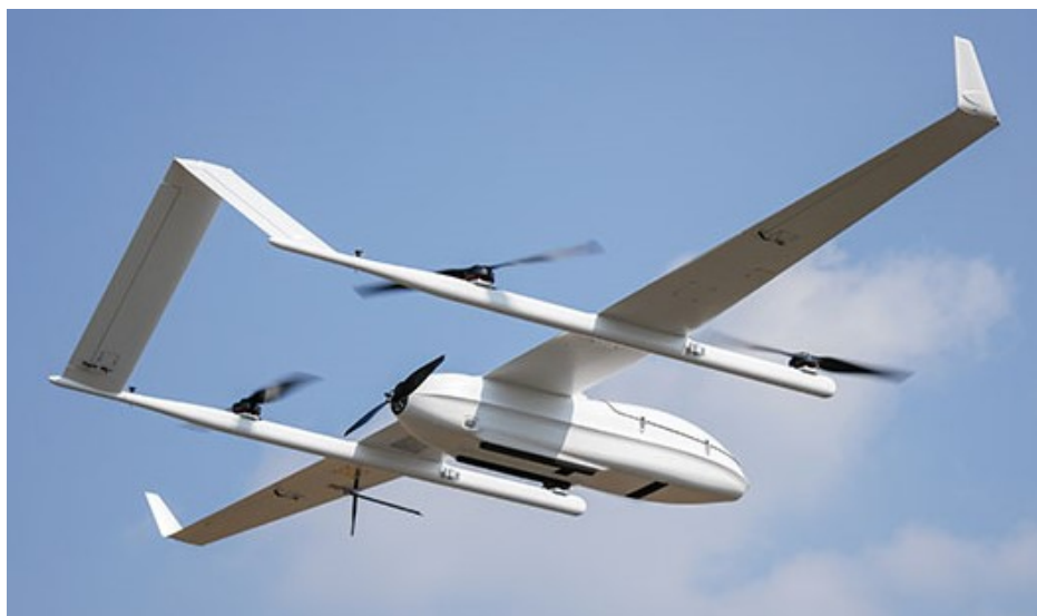
Slika 9. Primjer hibridne besposadne letjelice - CW-25E tvrtke JOUAV [22]
