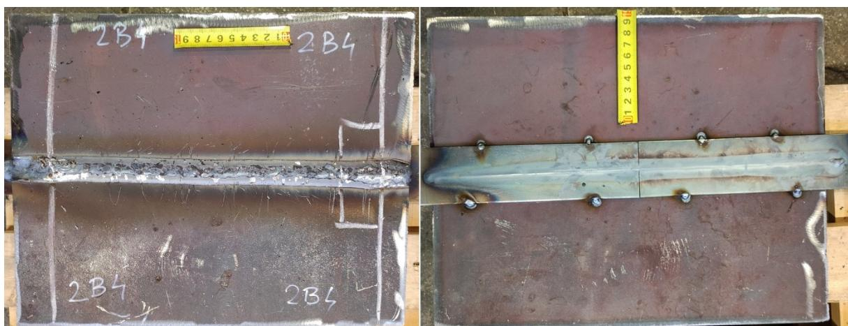
Slika 12. Uzorak U3 - zavar odozgo (desno), - korijen zavara odozdo (lijeko)
