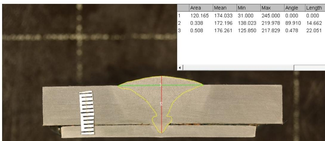
Slika 21. Parametri profila zavara - makroizbrusak U3
