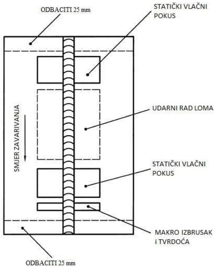
Slika 15. Prikaz mesta vađenja uzorka za mehanička ispitivanja [15]
