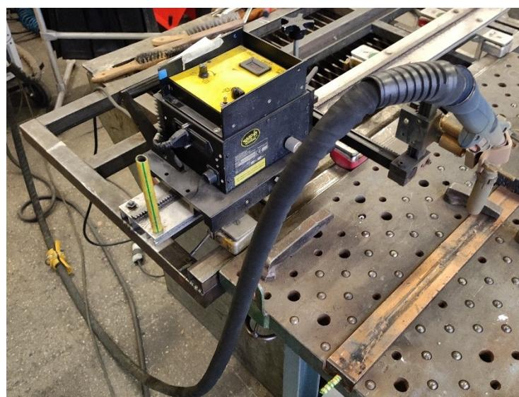
Slika 8. Traktor za automatizirano zavarivanje „BUG – O MDS 1002“
