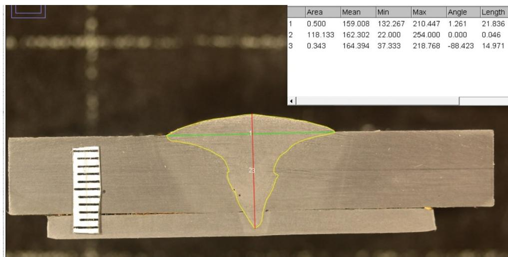
Slika 20. Parametri profila zavara - makroizbrusak U2
