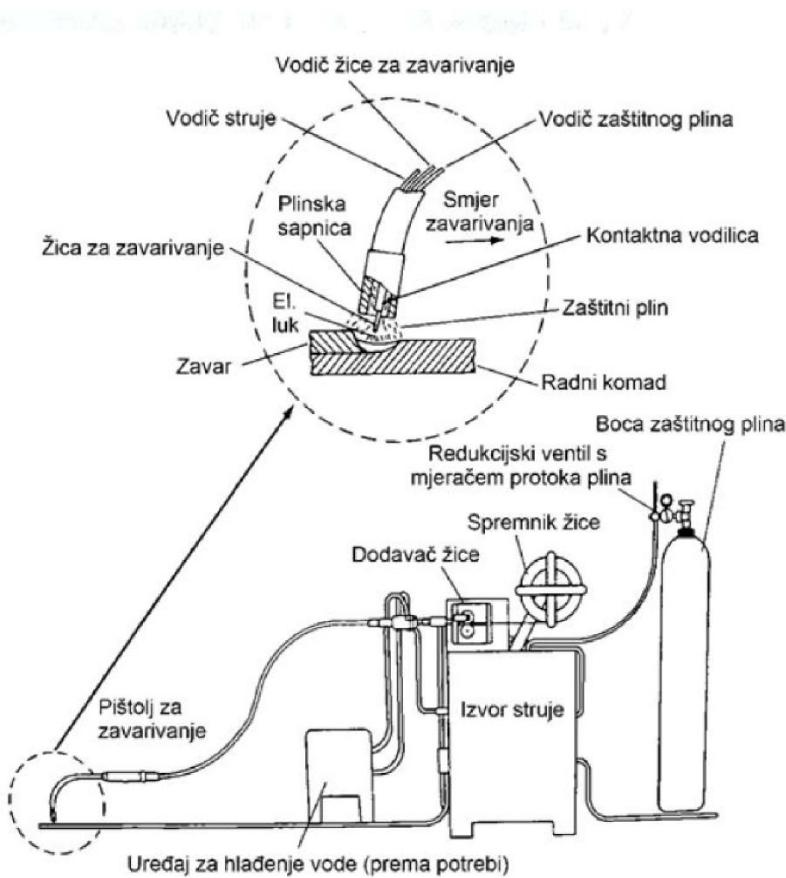
Slika 1. Električni luk kod MIG/MAG zavarivanja i oprema [6]
