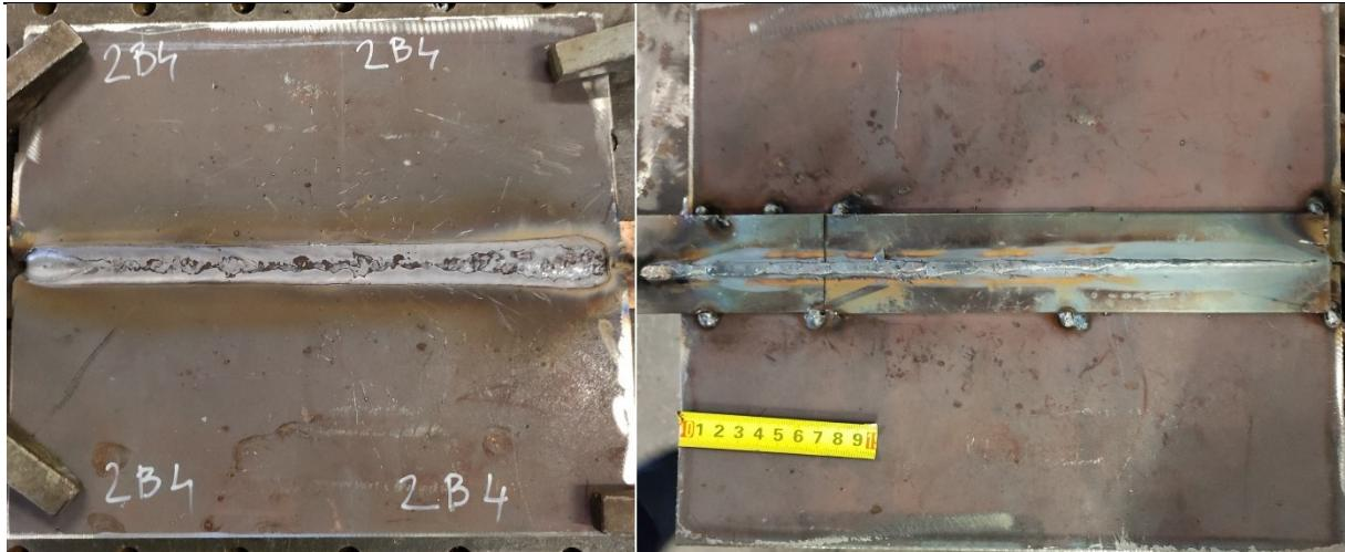
Slika 14. Uzorak U1 - zavar odozgo (desno), - korijen zavara odozdo (lijeko)
