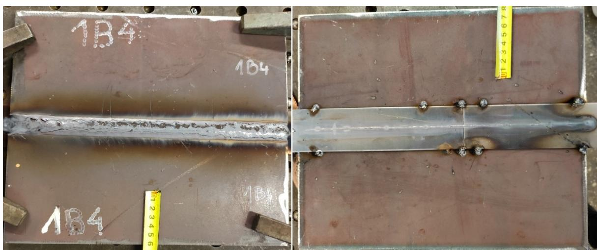
Slika 13. Uzorak U2 - zavar odozgo (desno), - korijen zavara odozdo (lijeko)
