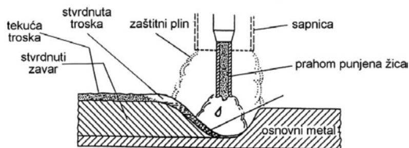
Slika 3. Električni luk kod zavarivanja praškom punjenom žicom
