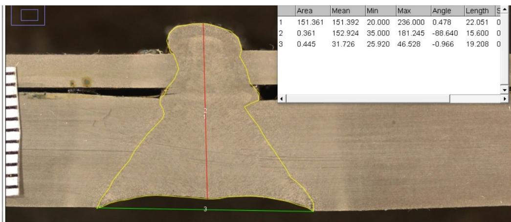
Slika 19. Parametri profila zavara - makroizbrusak U1
