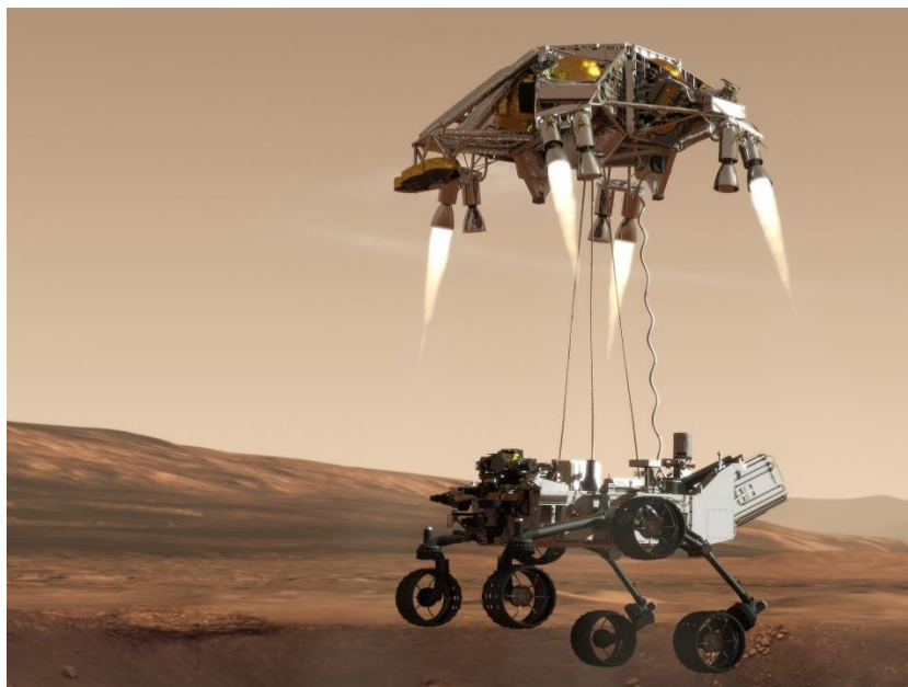
Slika 2. Slijetanje rovera na Mars pomoću sustava Skycrane [7]. Kada bi se koristili opružni elementi u sustavu suspenzije postojala bi opasnost od udara tijela rovera u tlo zbog sabijanja opruga.
