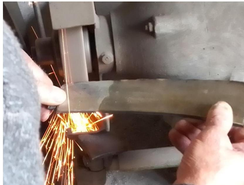
Slika 34. Poravnanje oštrice mačete na stolnoj brusilici
