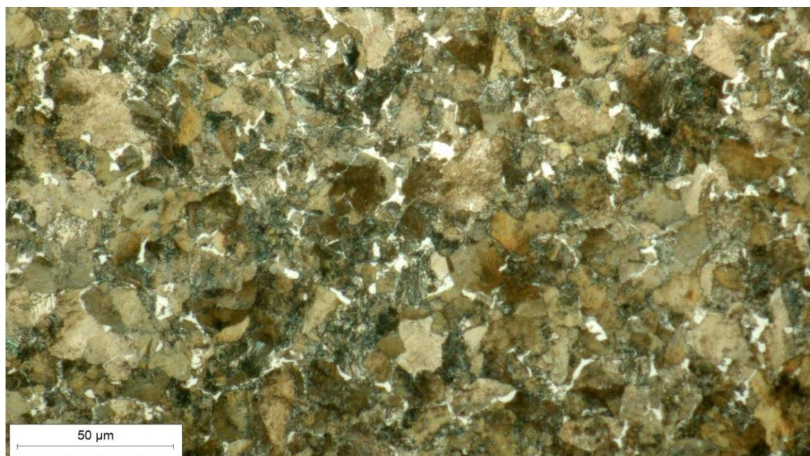
Slika 53. Mikrostruktura u oštici mačete, snimljena pri povećanju  $500\times$
