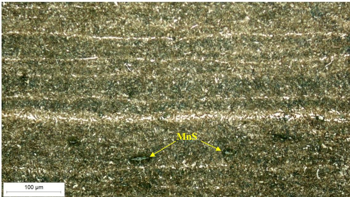
**Slika 47.** Mikrostruktura osnovnog materijala u sredini presjeka prije kovanja, snimljeno pri povećanju  $200\times$
