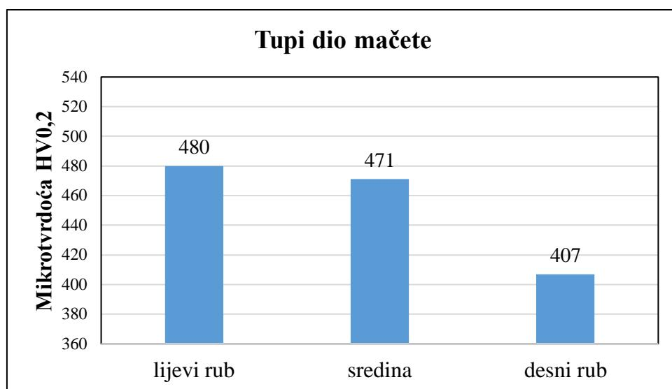
Slika 59. Mikrotvrdoća HV0,2 za tupi dio mačete
