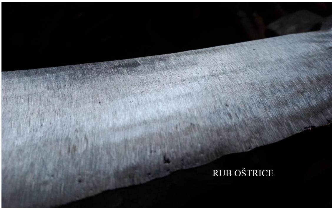
Slika 33. Površina mačete nakon finog brušenja
