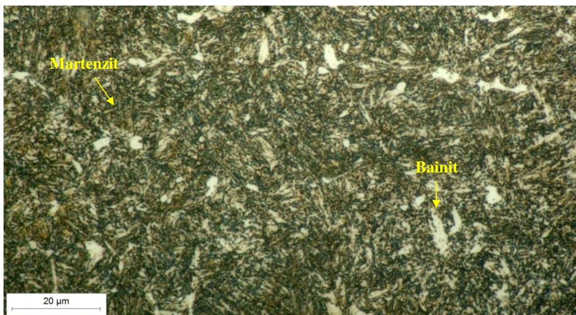
**Slika 48.** Mikrostruktura osnovnog materijala u sredini presjeka prije kovanja, snimljeno pri povećanju  $1000\times$
