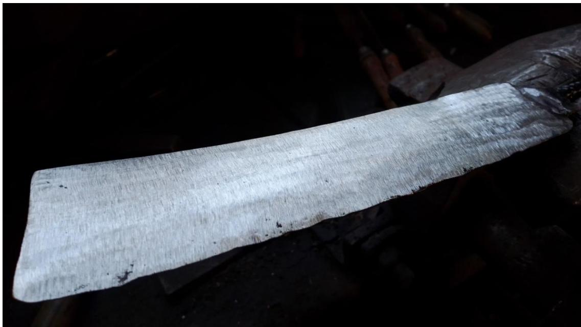
Slika 32. Mačeta nakon finog brušenja
