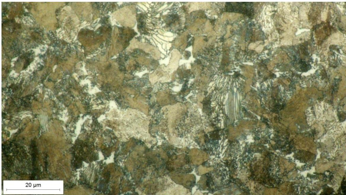
Slika 52. Mikrostruktura mačete u sredini poprečnog presjeka, snimljeno pri povećanju  $1000\times$
