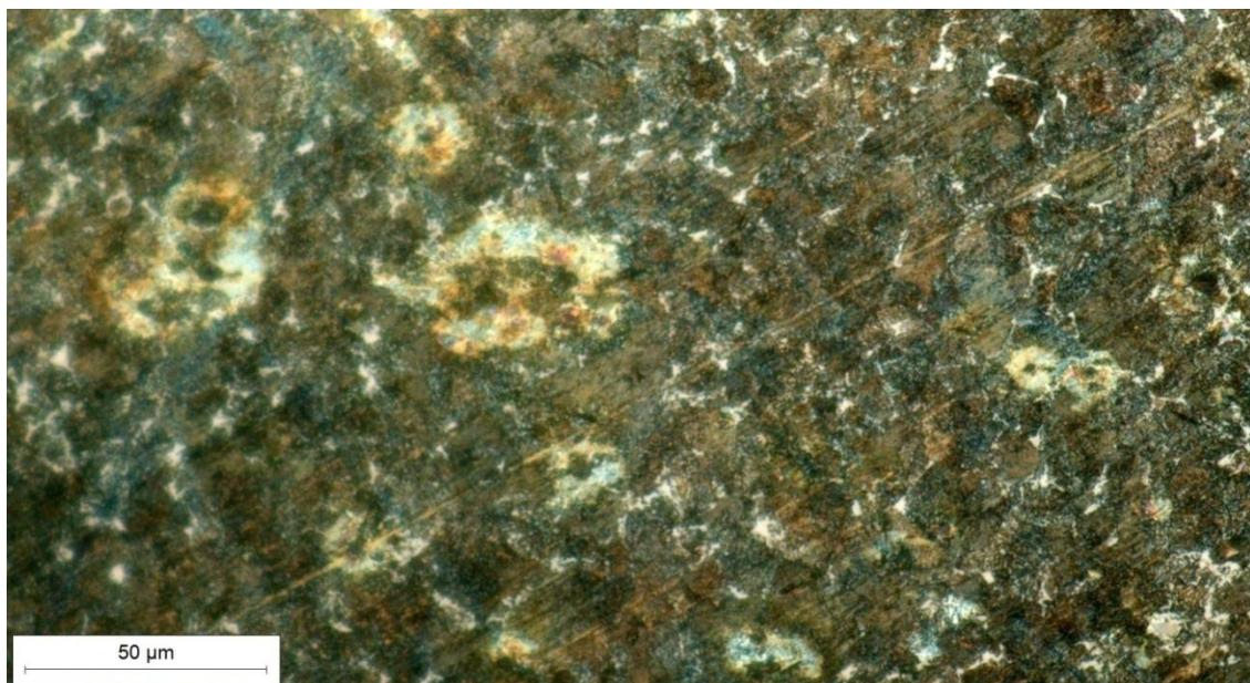
**Slika 49.** Mikrostruktura poprečnog presjeka mačete sastrane nasuprot oštici, snimljeno pri povećanju  $500\times$
