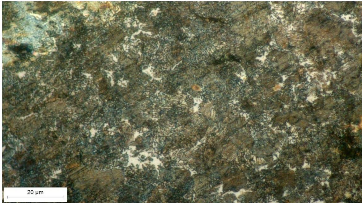
**Slika 50.** Mikrostruktura poprečnog presjeka mačete sa strane nasuprot oštrici, snimljeno pri povećanju  $1000\times$
