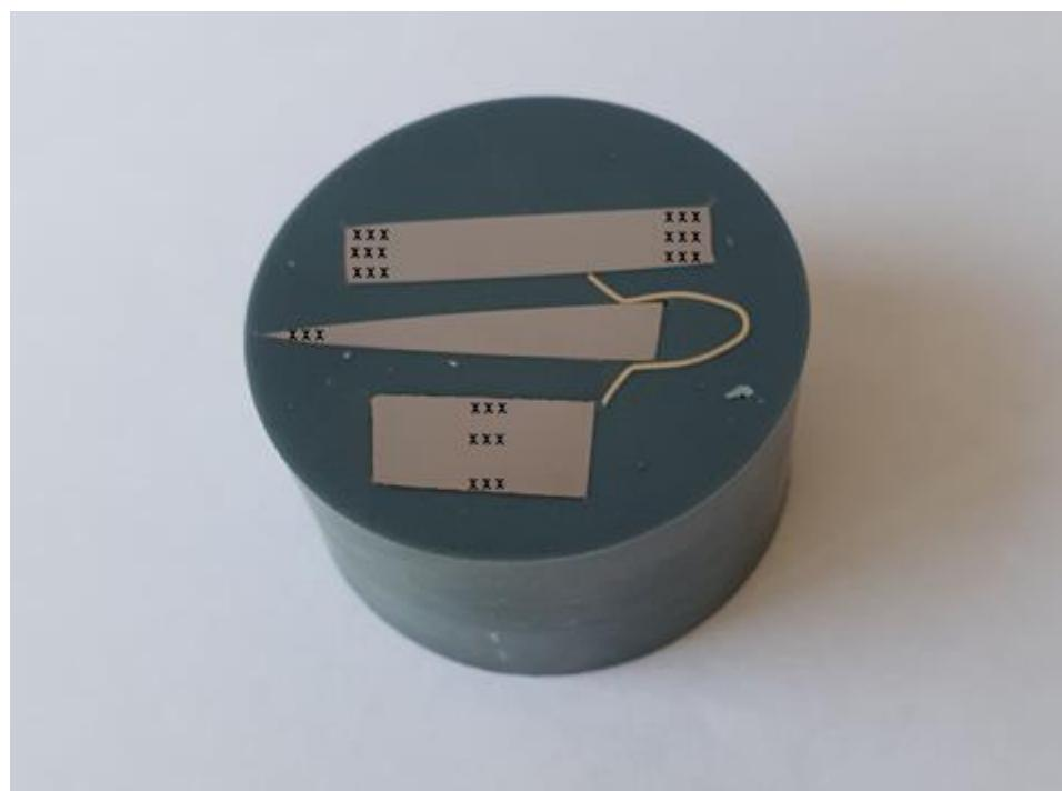
Slika 55. Pozicije mjerena mikrotvrdoće HV0,2
