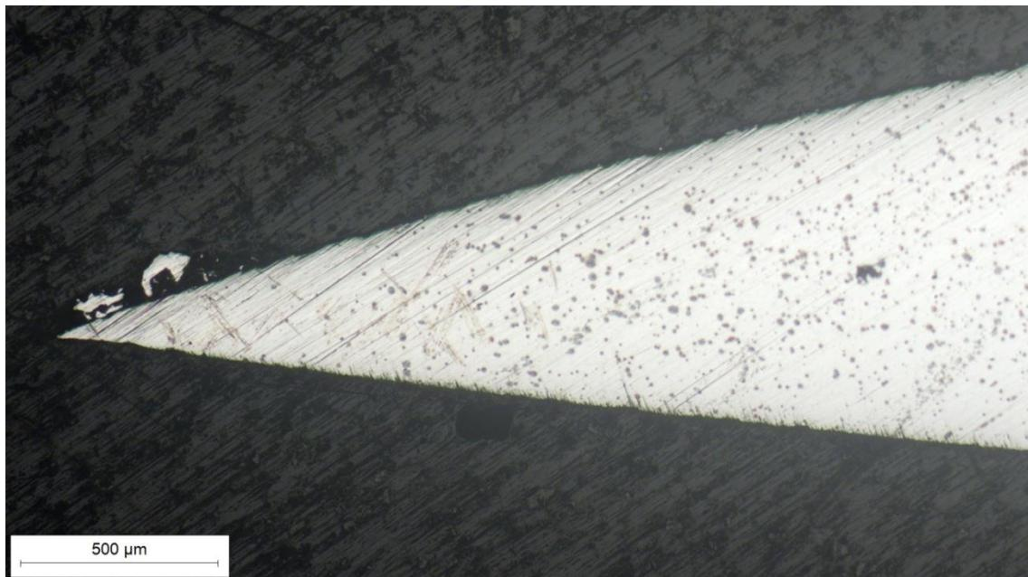
Slika 45. Mikrostruktura poprečnog presjeka oštice mačete, snimljeno pri povećanju 50×
