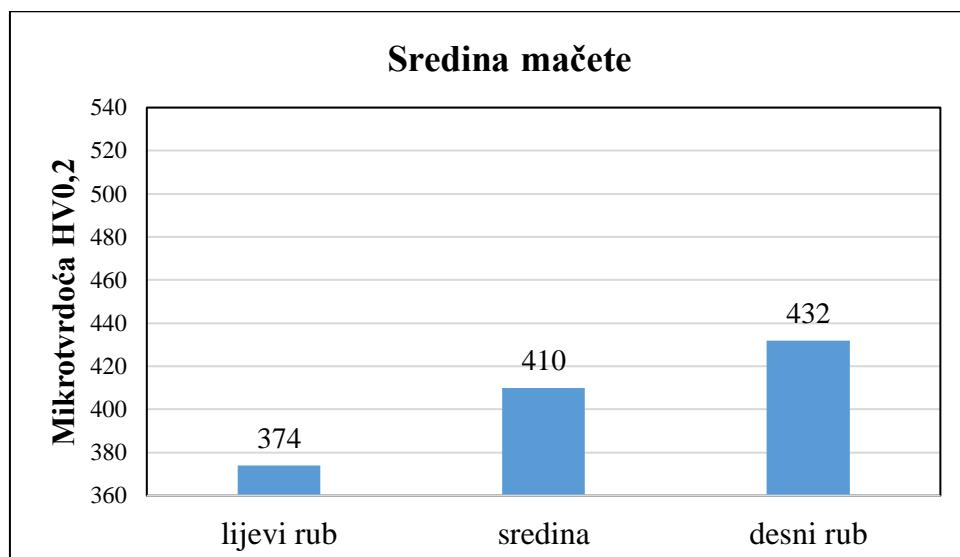
Slika 60. Mikrotvrdoća HV0,2 u sredini poprečnog presjeka mačete
