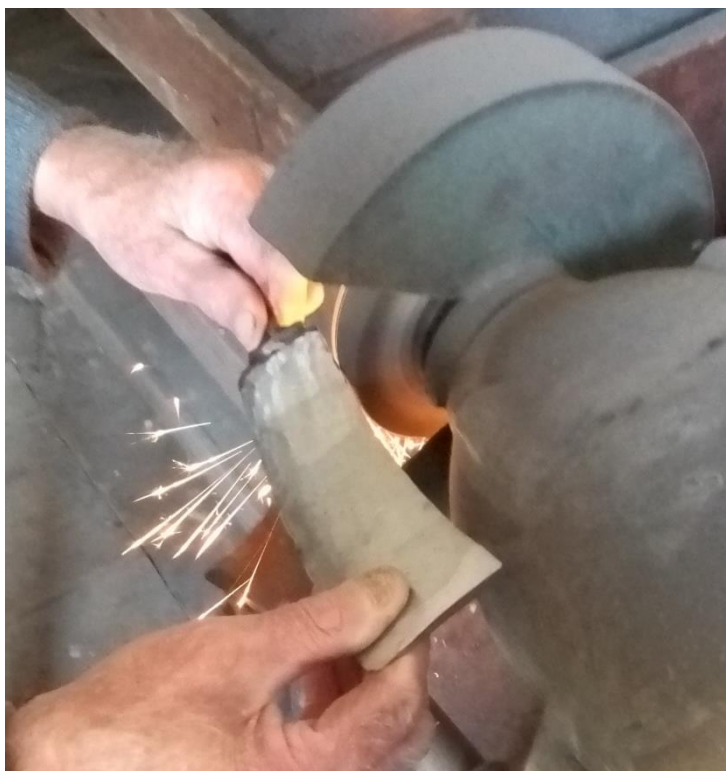
Slika 35. Poravnanje plohe nasuprotne oštrici mačete
