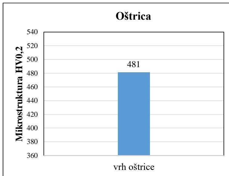
Slika 61. Mikrotvrdoća HV0,2 pri oštici mačete
