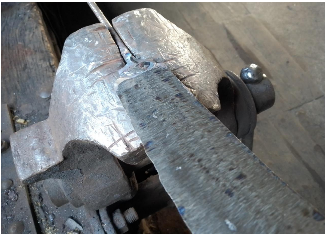
Slika 30. Mačeta nakon grubog brušenja
