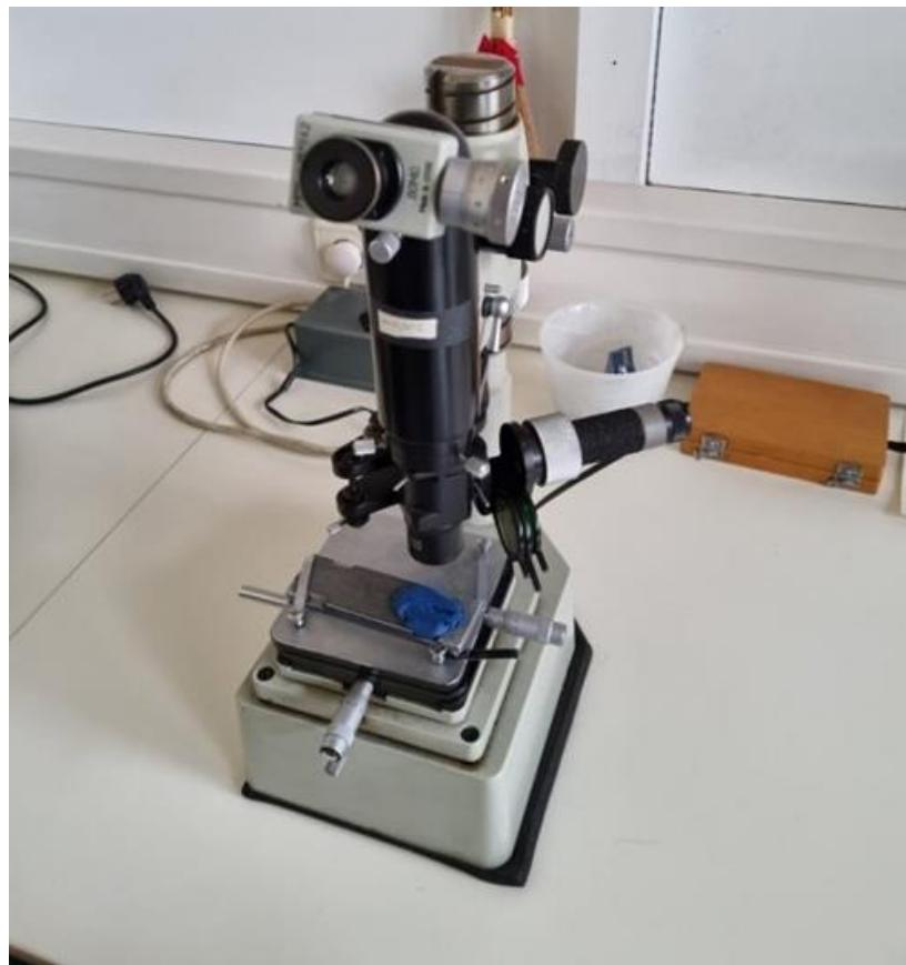
Slika 54. Mikrotvrdomjer PMT3
