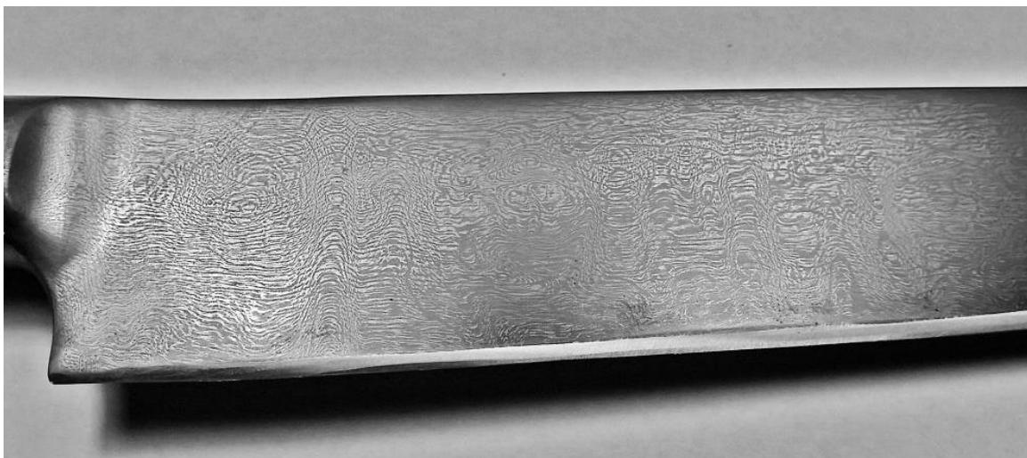
**Slika 9.** Nož od damaščanskog čelika [11]
