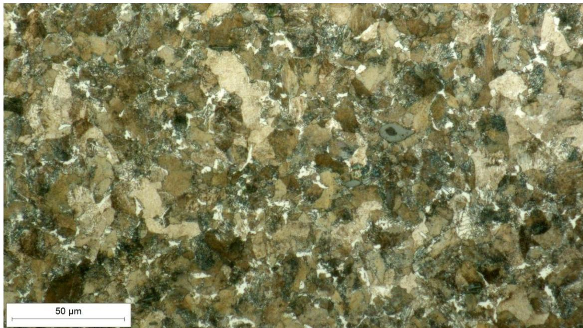
**Slika 51.** Mikrostruktura mačete u sredini poprečnog presjeka, snimljeno pri povećanju  $500\times$
