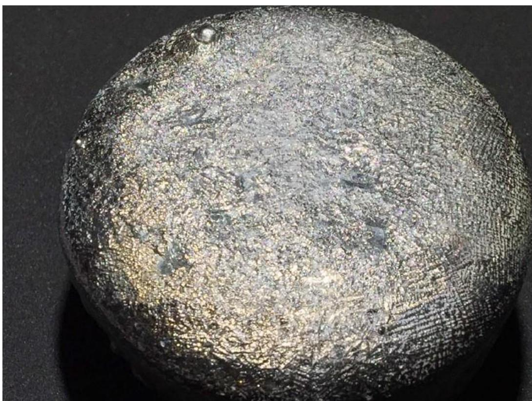
Slika 8. Odljevak *wootz* čelika[10]
