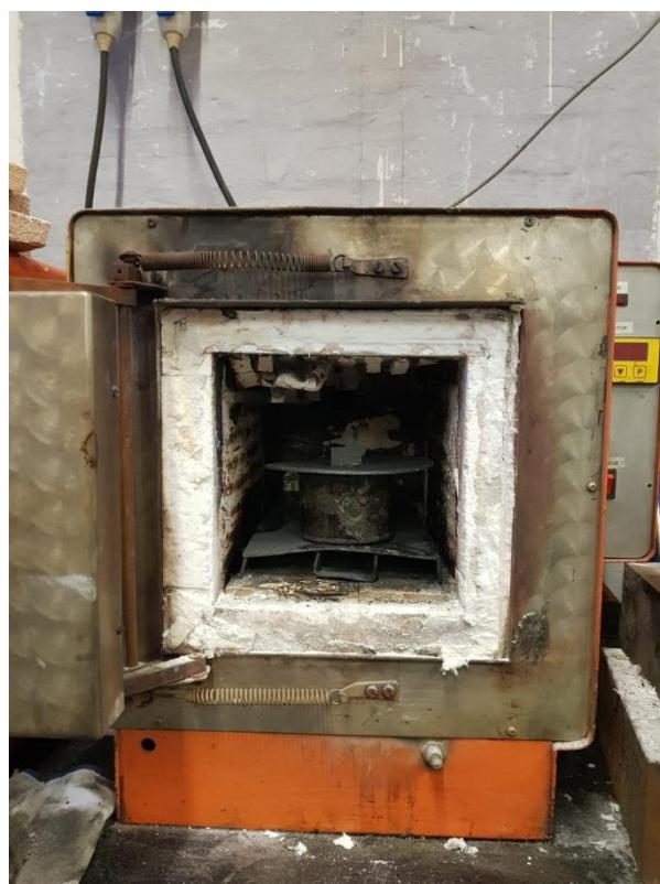
**Slika 26. Kutija u komornoj peći prije boriranja**
