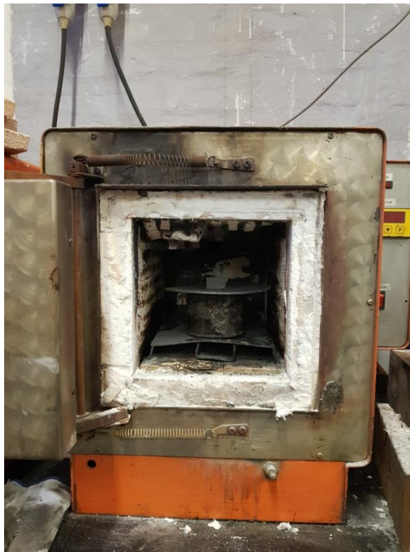
Slika 26. Kutija u komornoj peći prije boriranja
