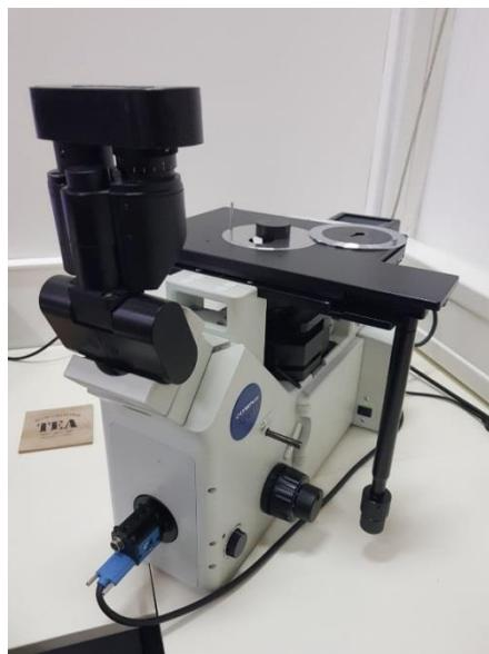
Slika 31. Metalografski mikroskop Olympus GX51
