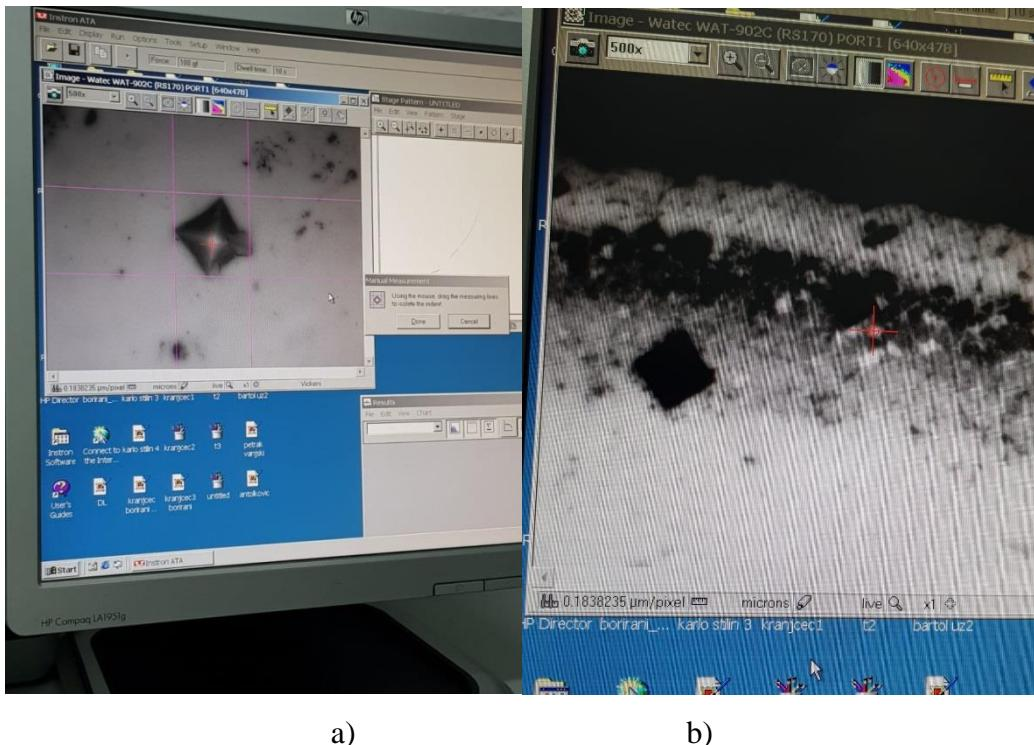
**Slika 40. Odredivanje mikrotvrdoće boriranog uzorka u: a) jezgri, b) difuzijskoj zoni**
