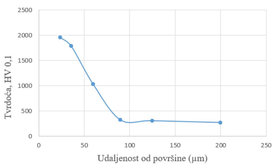
**Slika 44. Mikrotvrdoča po poprečnom presjeku za uzorak 12**
