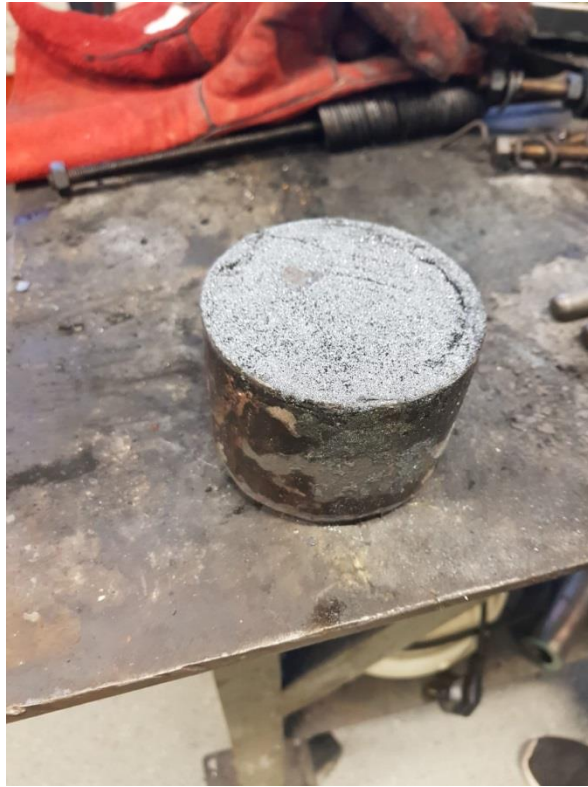
Slika 25. Uzorak u vatrootpornoj čeličnoj kutiji
