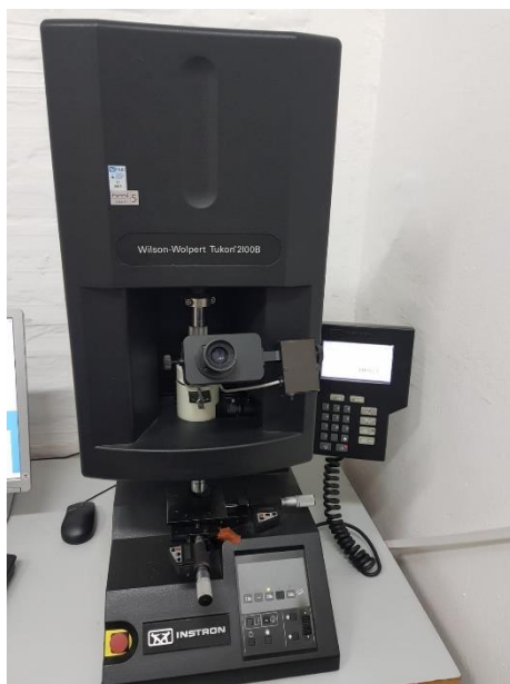
Slika 39. Tvrdomjer Wilson-Wolpert Tukon 2100B
