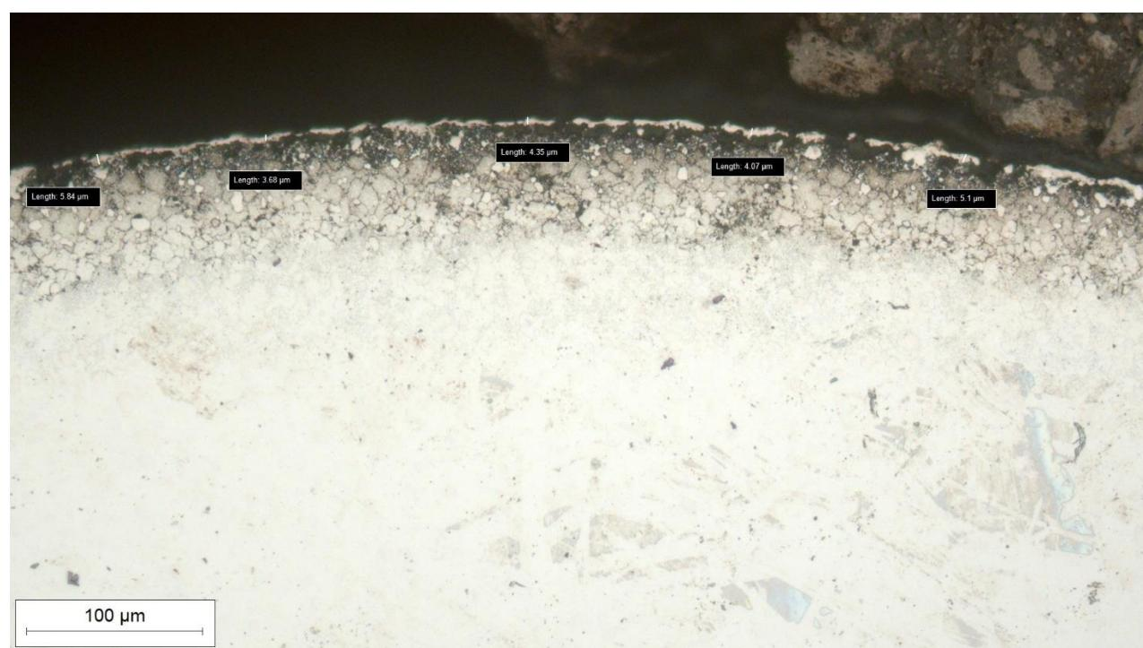
Slika 38. Uzorak 7, boriran na  $T = 950 \text{ } ^\circ\text{C} / 1\text{h}$ , povećanje 200x, nagriženo u 3 %-tnom NITAL-u
