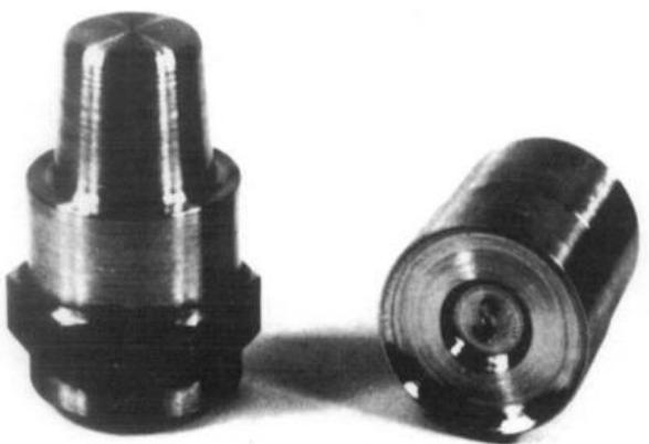
**Slika 5. Borirani zupčanici i kalupi za keramičke dijelove [3]**
