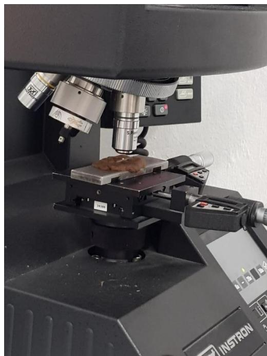
**Slika 41. Ispitivanje površinske tvrdoće**
