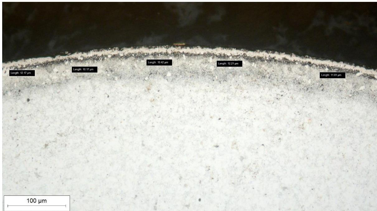
**Slika 45. Mikrostruktura uzorka 10, boriranog na  $T = 1000^{\circ}\text{C}/1\text{ h}$ , nagriženo u 3 %-tnom NITAL-u**
