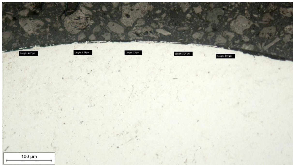
Slika 36. Uzorak 4, boriran na  $T = 900 \text{ } ^\circ\text{C}$ / 1h, povećanje 200x, nagriženo u 3 %-tnom NITAL-u
