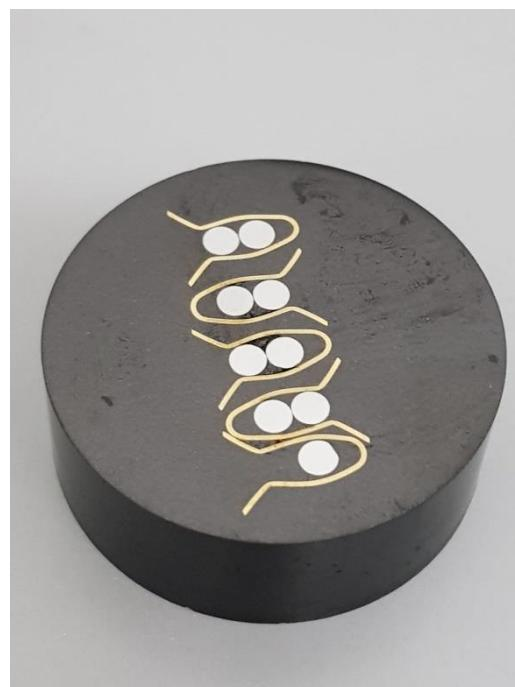
**Slika 29. Uzorci u polimernoj masi**
