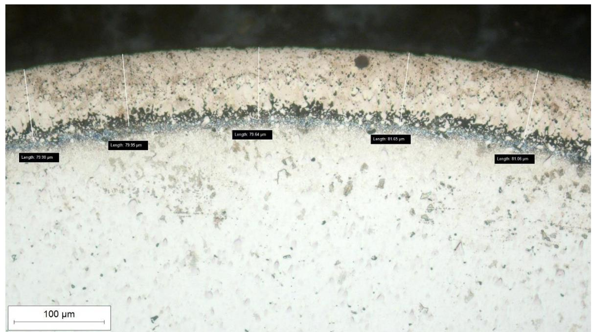
Slika 47. Mikrostruktura uzorka 12, boriranog na  $T = 1000^{\circ}\text{C}/5\text{ h}$ , nagriženo u 3 %-tnom NITAL-u
