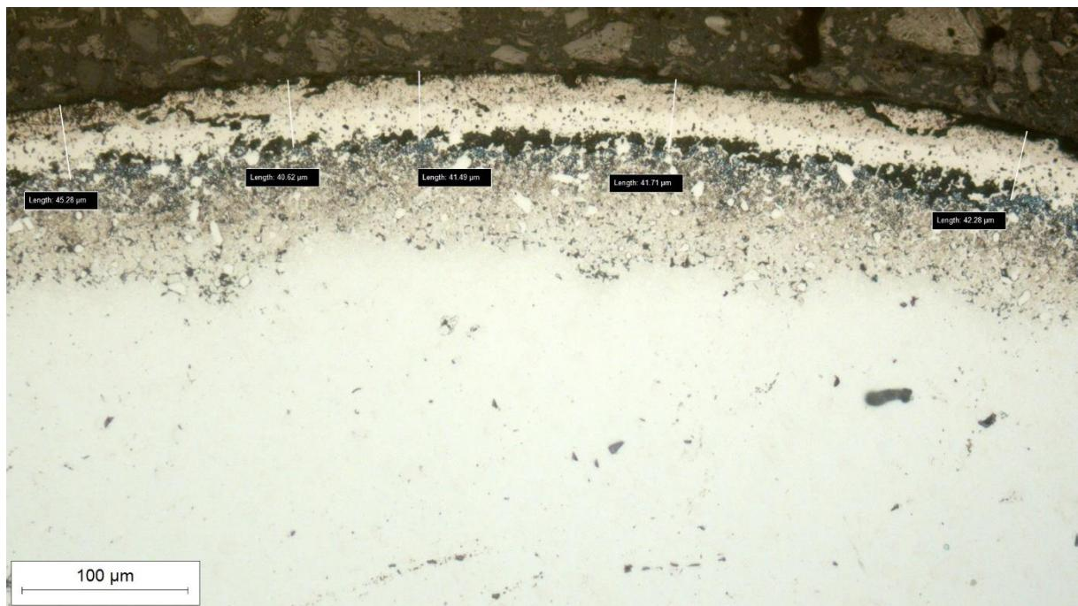
Slika 33. Mjerenje debljine boridnog sloja na uzorku 9
