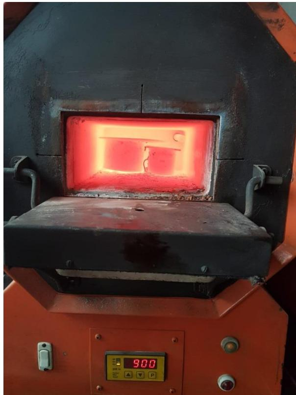
Slika 27. Unutrašnjost peći za vrijeme boriranja pri 900 °C
