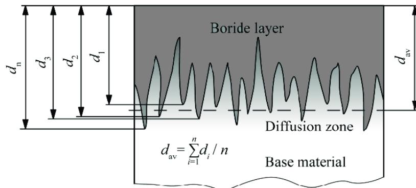
Slika 32. Metoda mjerena debljine boridnih slojeva [13]
