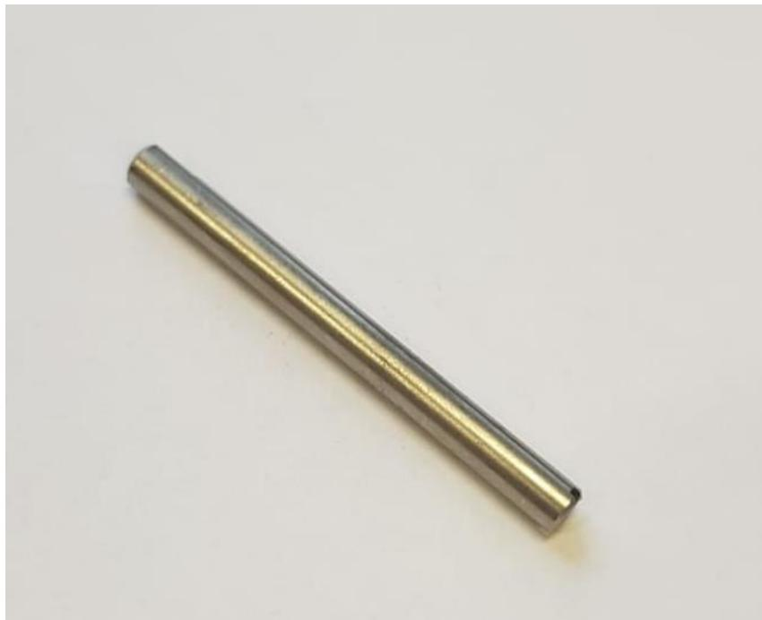
Slika 24. Uzorak od čelika X90CrMoV18 prije boriranja
