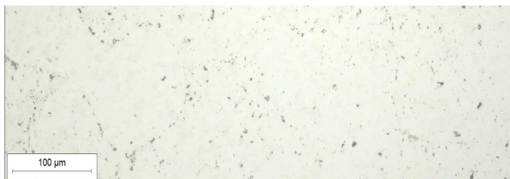
Slika 34. Jezgra boriranog čelika X90CrMoV18
