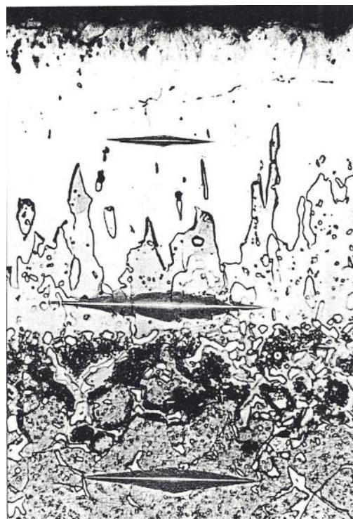
**Slika 11. Otkriće feritne zone između boridnog sloja i jezgre čelika X38CrMo5 1 putem Knoop ispitivanja tvrdoće. Knoop tvrdoća od gore prema dolje: 1635, 352, 578 HK<sub>0,01</sub>. [3]**
