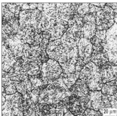
$T_A=1200\text{ }^{\circ}\text{C}$ , 580 HV
