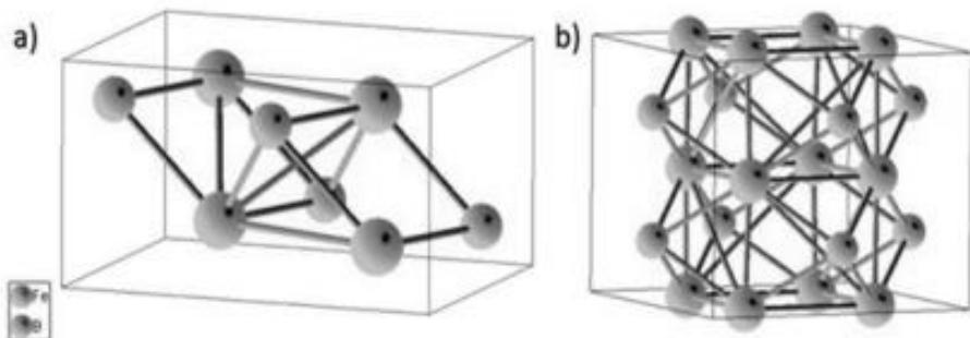
**Slika 8. Jedinična čelija borida: a) rompska struktura FeB. b) tetragonska struktura Fe<sub>2</sub>B. [12]**
