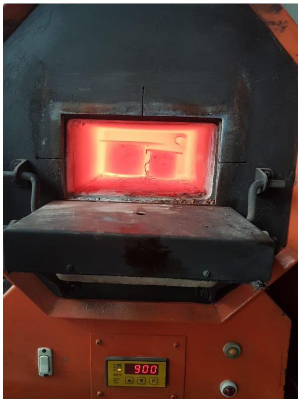
Slika 27. Unutrašnjost peći za vrijeme boriranja pri 900 °C
