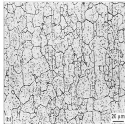
$T_A=1150\text{ }^{\circ}\text{C}$ , 630 HV
