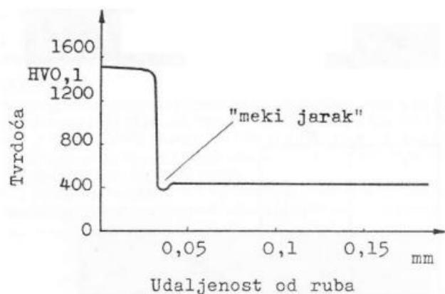
Slika 1. Raspored tvrdoće na boriranom čeliku X38CrMoV5 1 [5]
