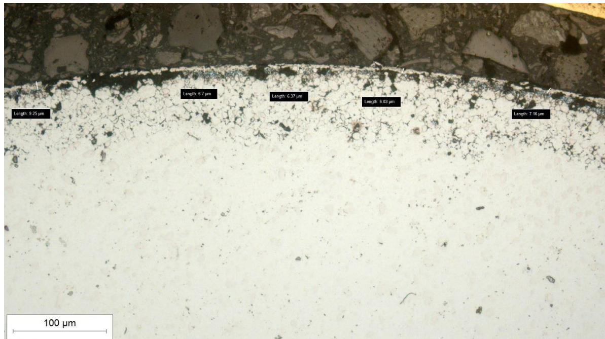
Slika 35. Uzorak 1, boriran na  $T = 850 \text{ } ^\circ\text{C}$ / 1h, povećanje 200x, nagriženo u 3 %-tnom NITAL-u
