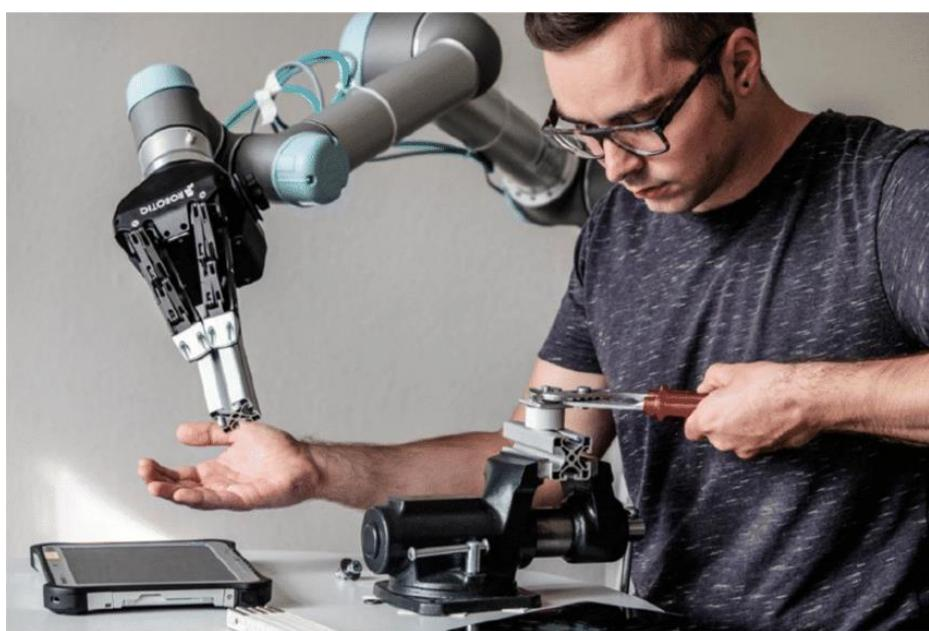
Slika 2. Kolaborativni robot pomaže čovjeku prilikom montaže [2]
