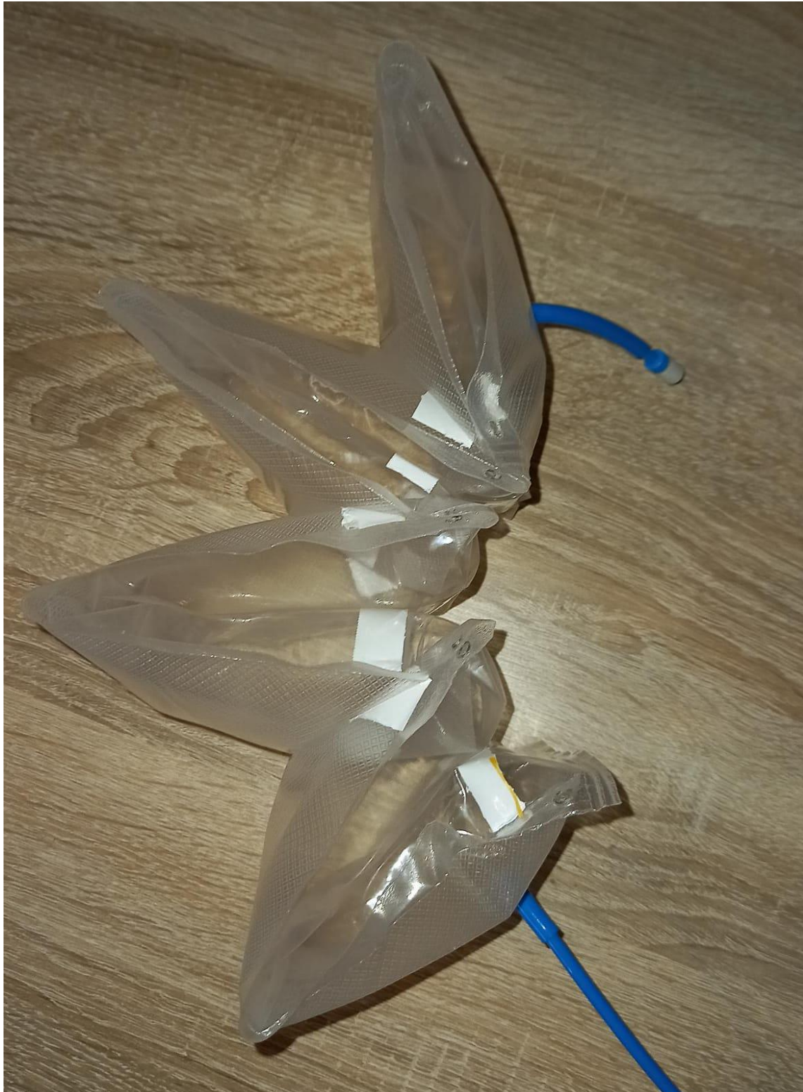
Slika 26. Napuhani fleksibilni pneumatski aktuator (1)
