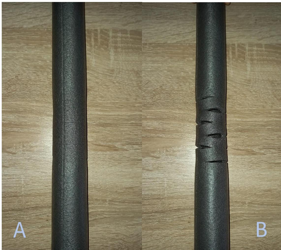
Slika 28. (A) Nosač -neopterećen, (B) Nosač -opterećen uzdužnom vlačnom silom
