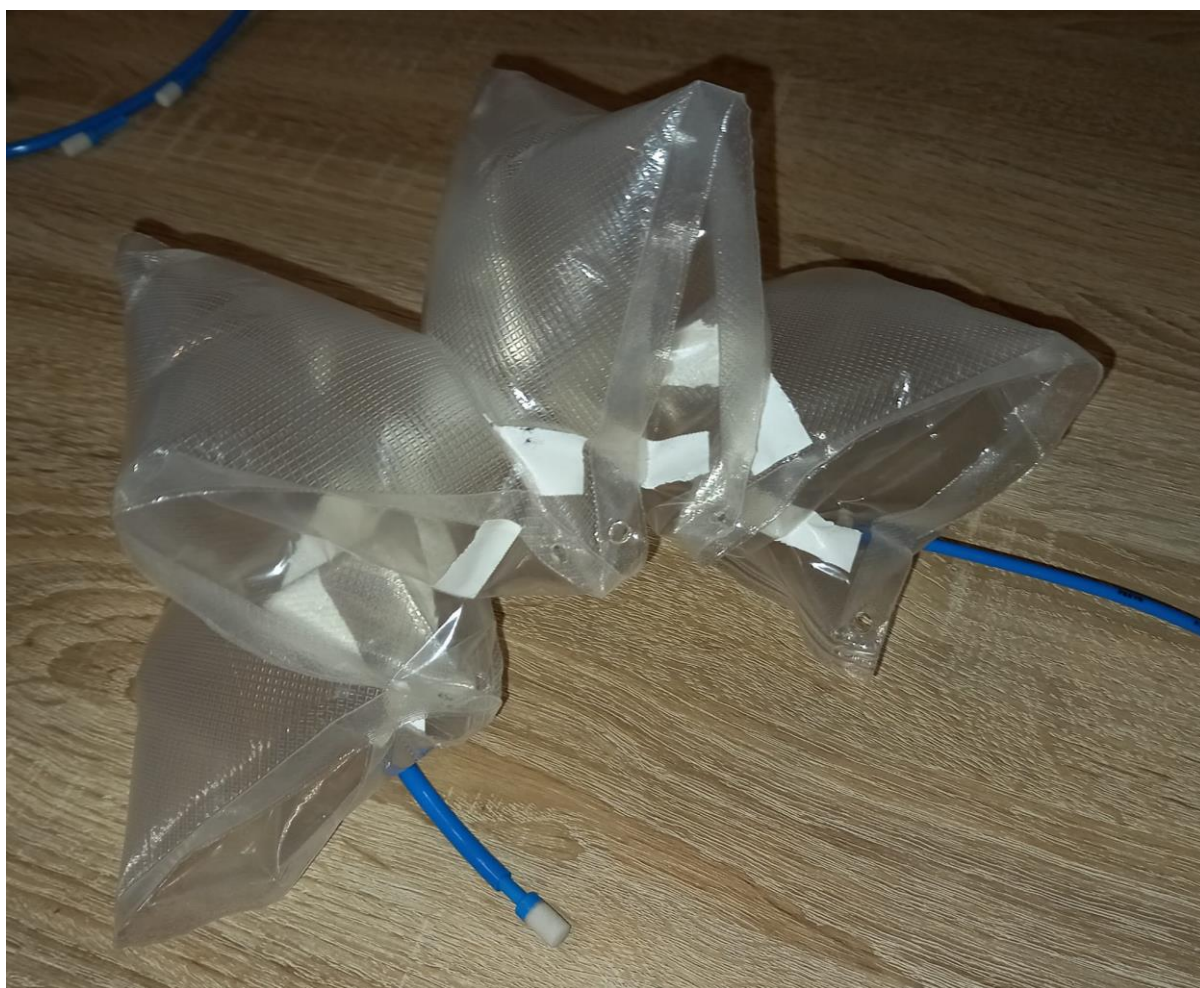
Slika 27. Napuhani fleksibilni pneumatski aktuator (2)
