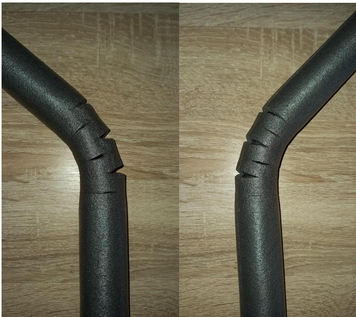
*Slika 29. Savijanje nosača*
