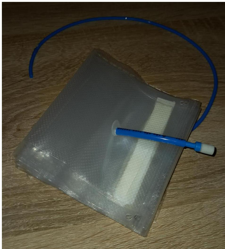
*Slika 25. Nenapuhani fleksibilni pneumatski aktuator sa zatvorenim izlazom*
