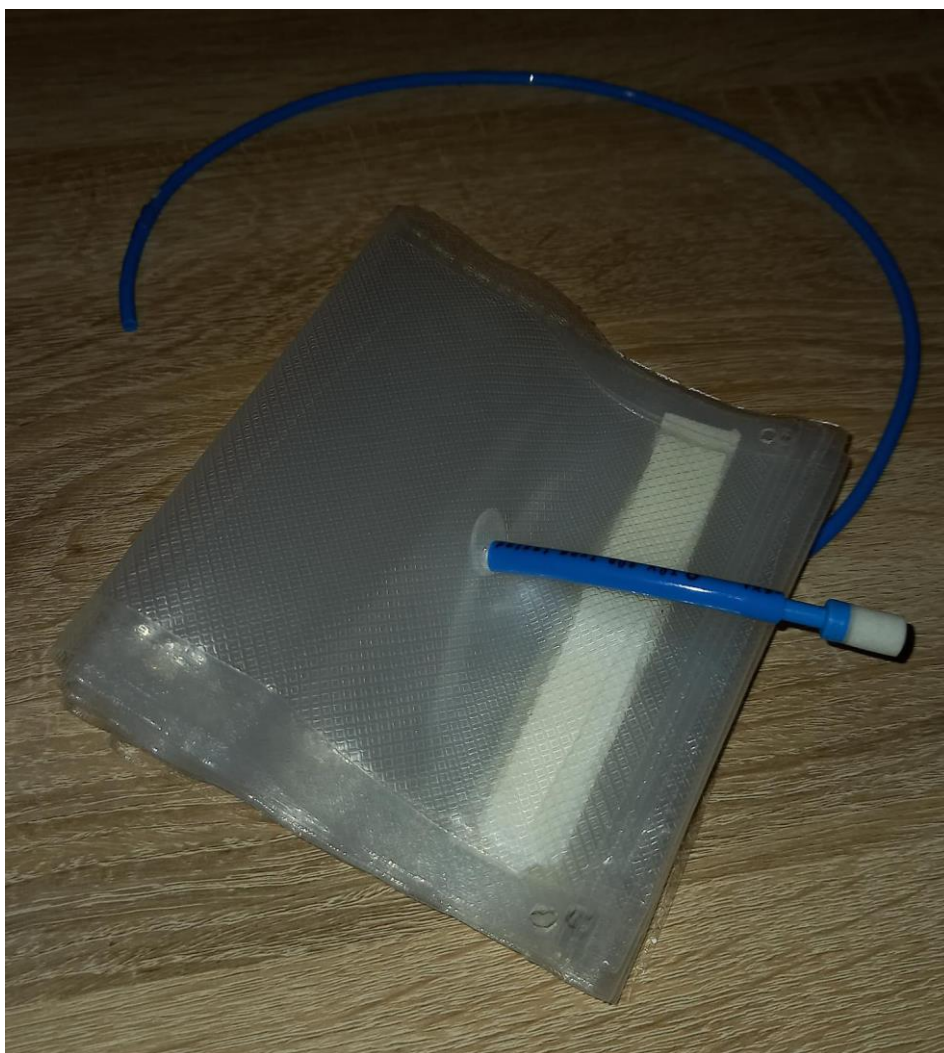
Slika 25. Nenapuhani fleksibilni pneumatski aktuator sa zatvorenim izlazom
