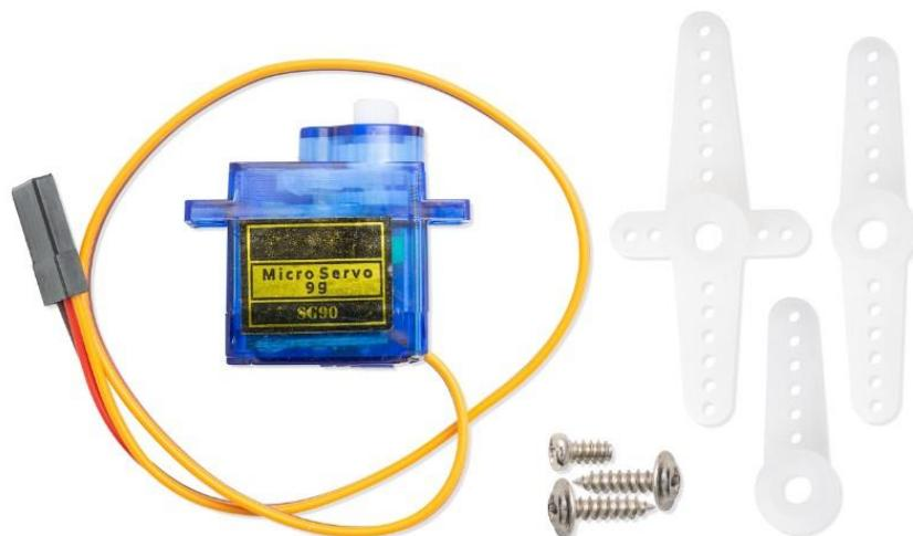
Slika 21. Servo motor SG90[5]
