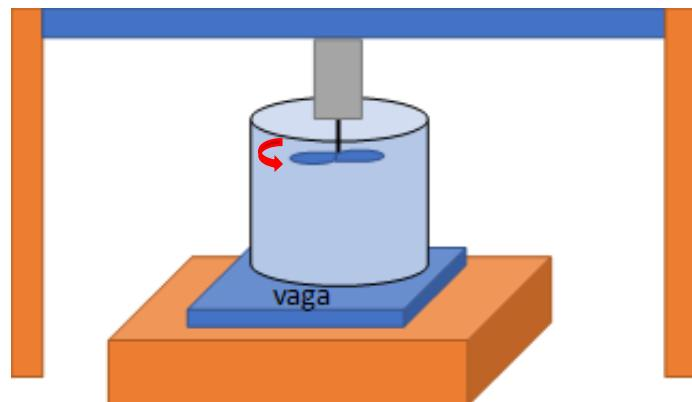
**Slika 16. Pokus za eksperimentalne podatke propelera**
