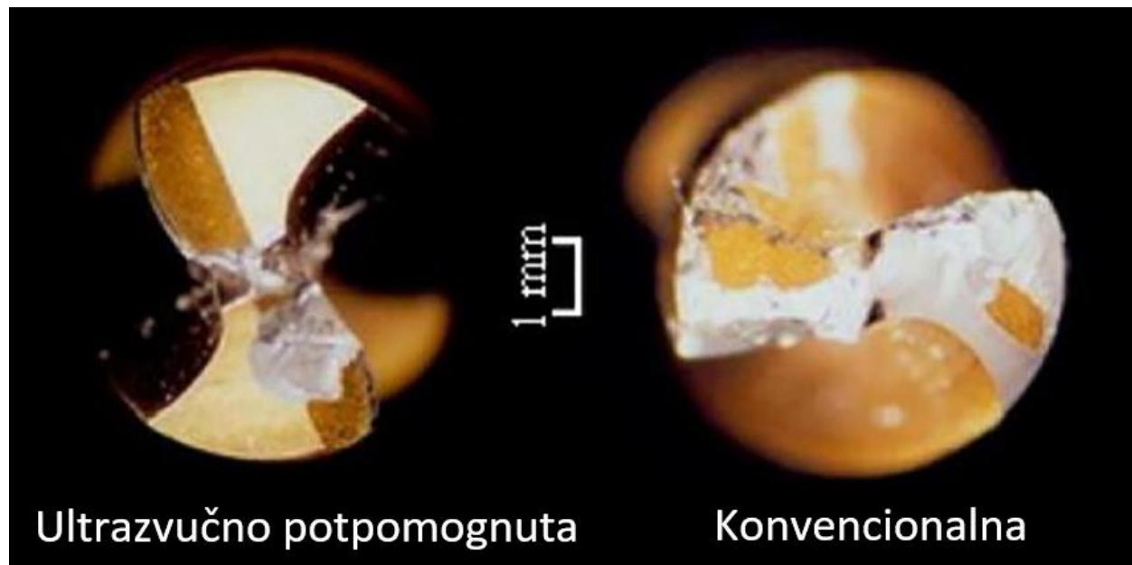
Slika 2. Usporedba rezne oštice svrdla kod ultrazvučno potpomognutog i konvencionalnog bušenja [27]
