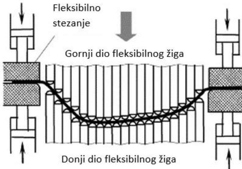
**Slika 14. Formiranje u kalupu u više točaka istovremeno sa segmentiranim matricom [30]**
