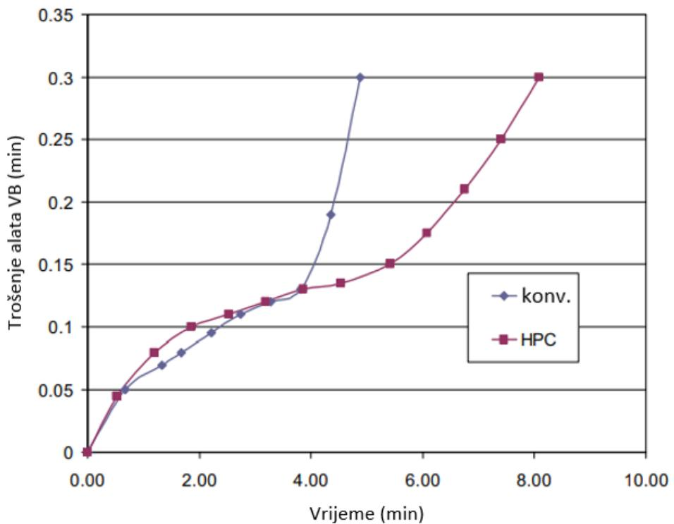
Slika 7. Omjer trošenja alata i vremena obrade [33]
