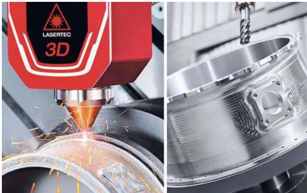
**Slika 15. LASERTEC lijevo lasersko navarivanje, desno glodanje**
