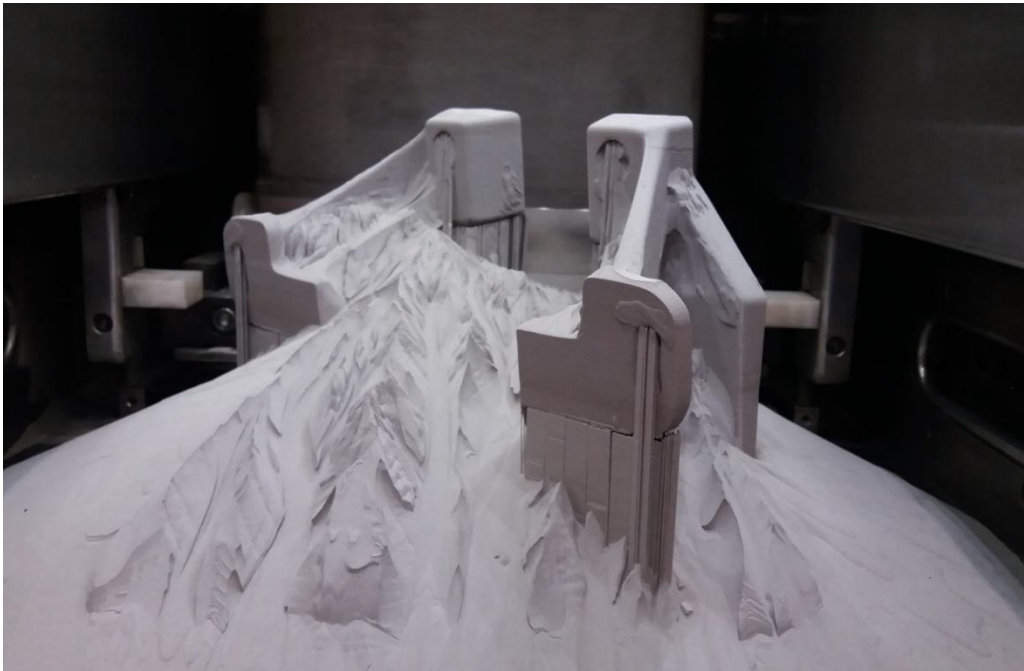
Slika 13. Proizvod u metalnom prahu nakon procesa SLM-a [28]
