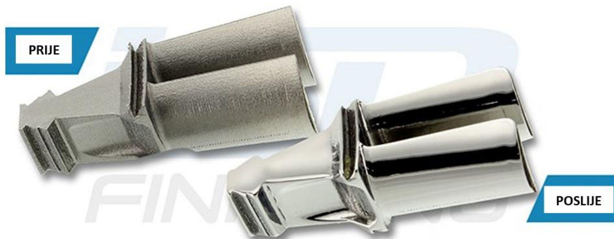
Slika 25. Izgled proizvoda prije i poslije završne obrade [35]
