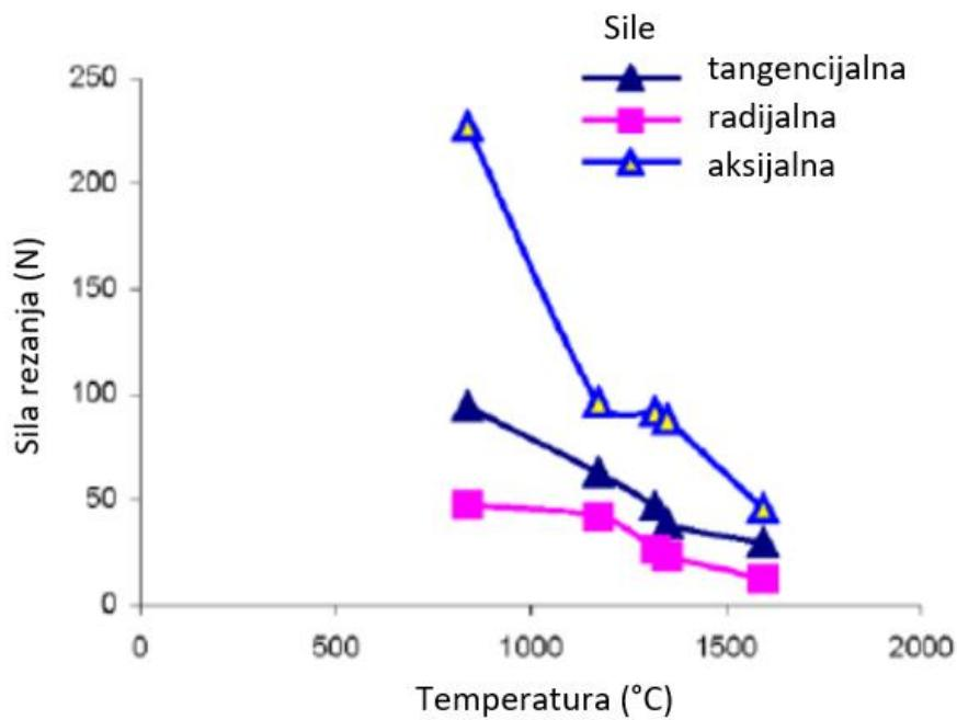
Slika 4. Omjer sila rezanja i temperature [31]
