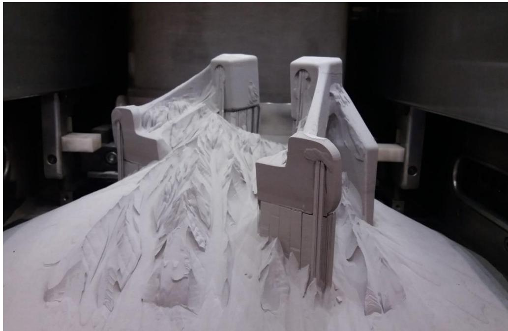
Slika 13. Proizvod u metalnom prahu nakon procesa SLM-a [28]
