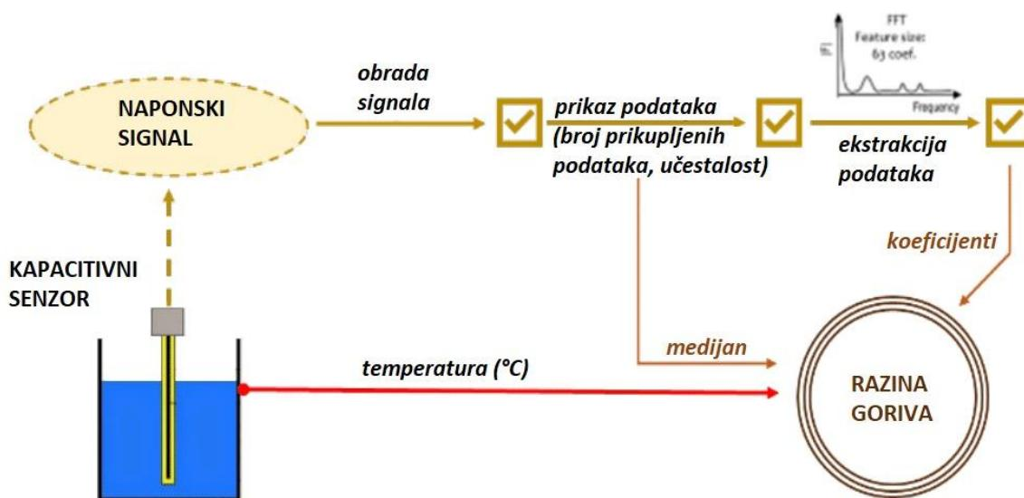
Slika 7. Kapacitivni senzor razine goriva [1]
