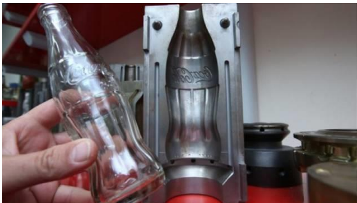
Slika 7. Kalup i konačni proizvod
