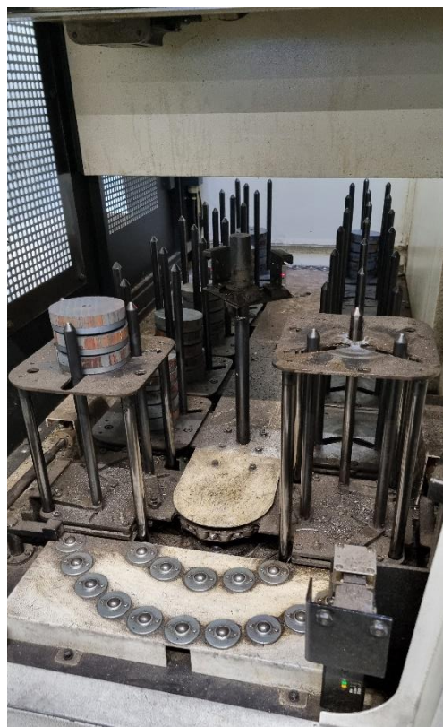
Slika 24. Robotska doprema sirovaca
