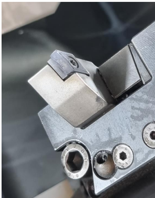
Slika 36. Alat za finu obradu vanjske konture stražnje strane
