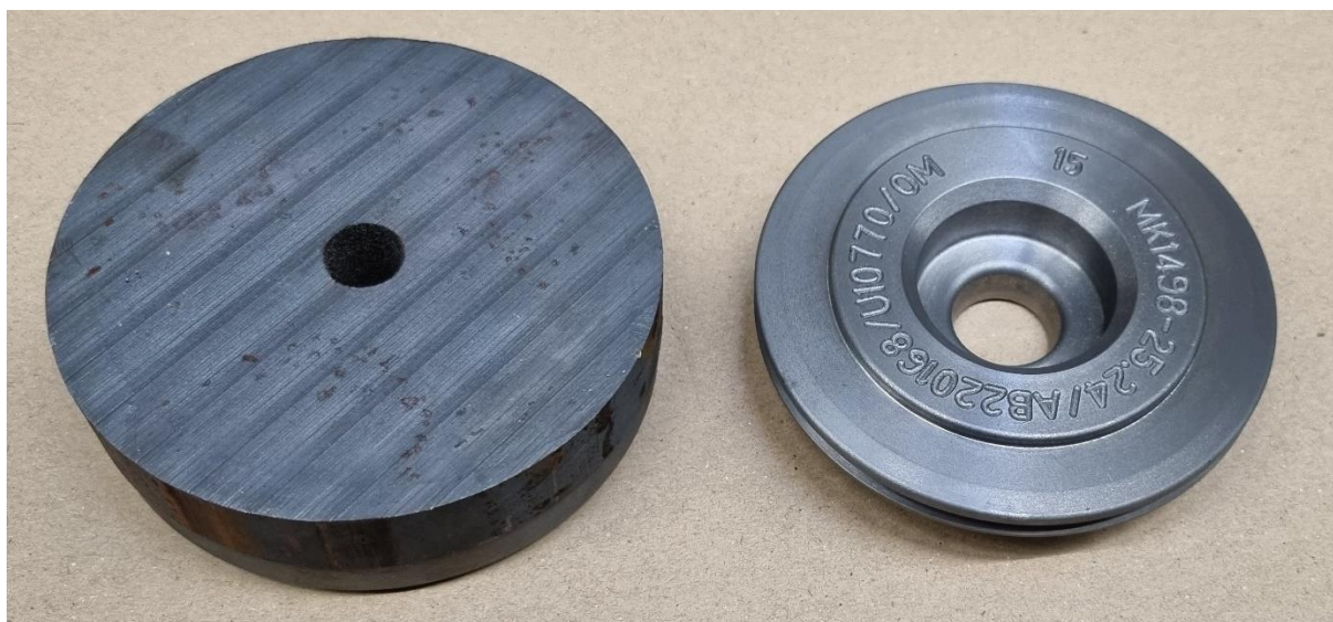
Slika 52. Stražnja strana obratka i izratka
