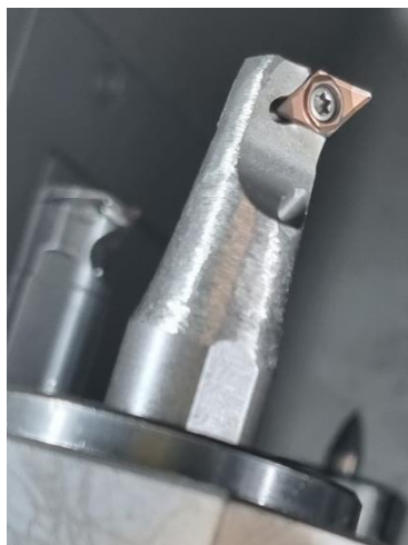
Slika 34. Alat za finu obradu unutarnje konture stražnje strane
