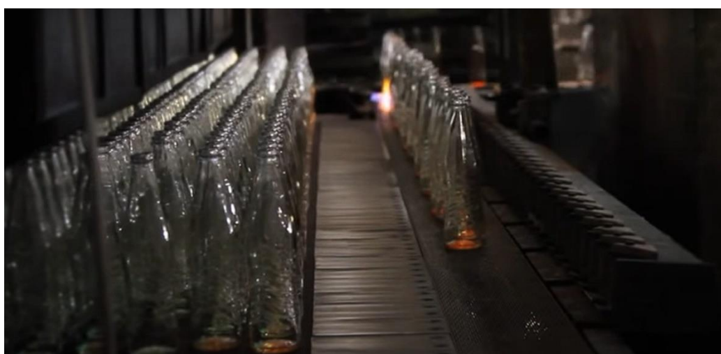
Slika 4. Staklene boce na ulazu u postavu za oplemenjivanje
