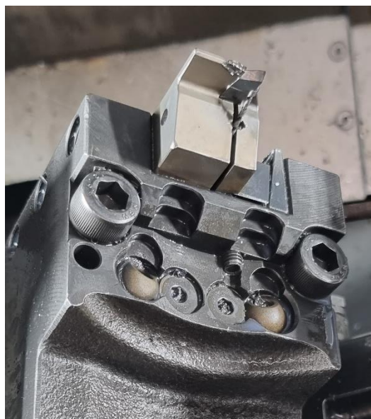
Slika 30. Alat za izradu GIP utora na obodu
