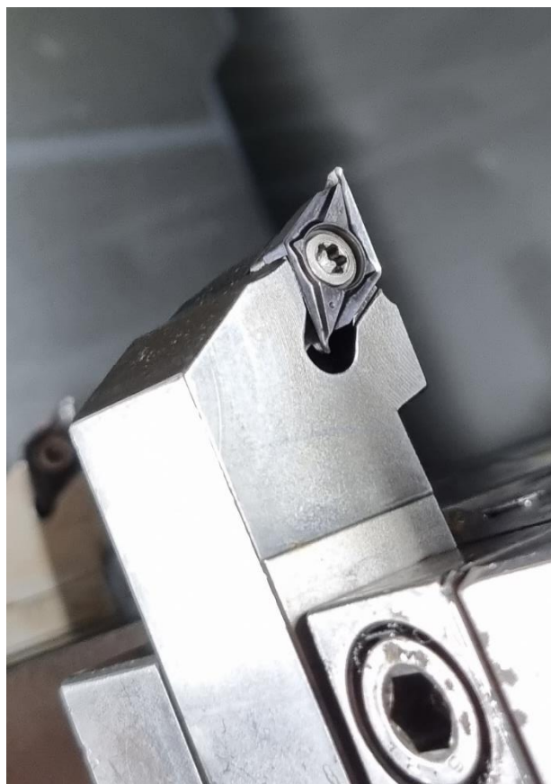
Slika 48. Alat za obradu fazone
