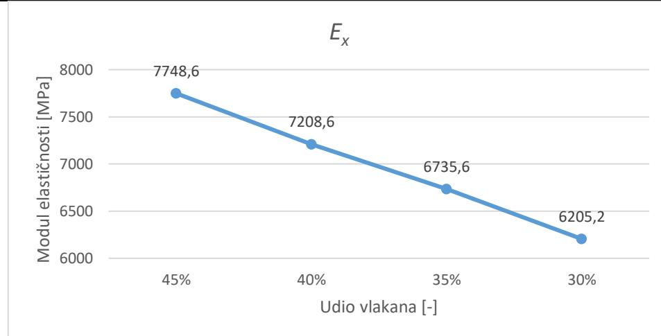
**Slika 31. Moduli elastičnosti u smjeru osi x,  $E_x$**
