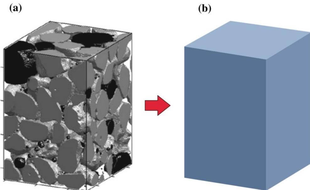
Slika 13. Princip homogenizacije [18]
