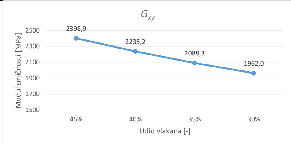
Slika 34. Moduli smičnosti u xy ravnini,  $G_{xy}$
