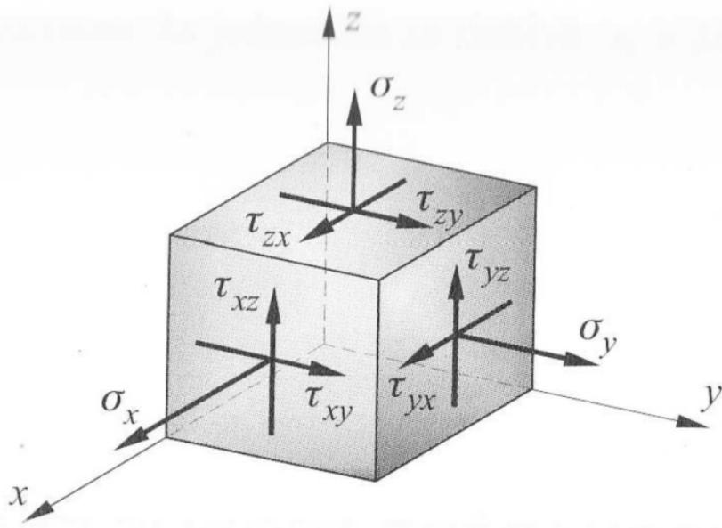
Slika 8. Komponente tenzora naprezanja [13]
