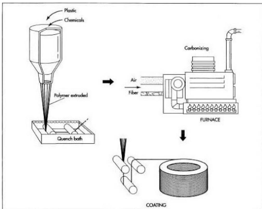
**Slika 5. Postupak proizvodnje ugljičnih vlakana iz PAN-a [10]**
