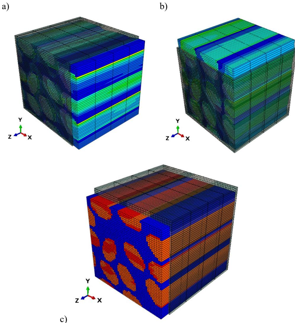
**Slika 25. Raspodjela normalnih naprezanja RVE-a veličine 25  $\mu\text{m}$  za jednoosno istezanje:**
