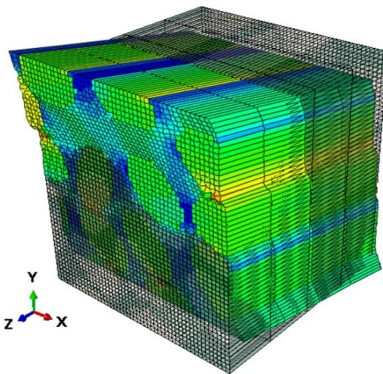
**Slika 26.** Raspodjela posmičnih naprezanja RVE-a veličine  $25 \mu\text{m}$  za slučaj čistog smika:
