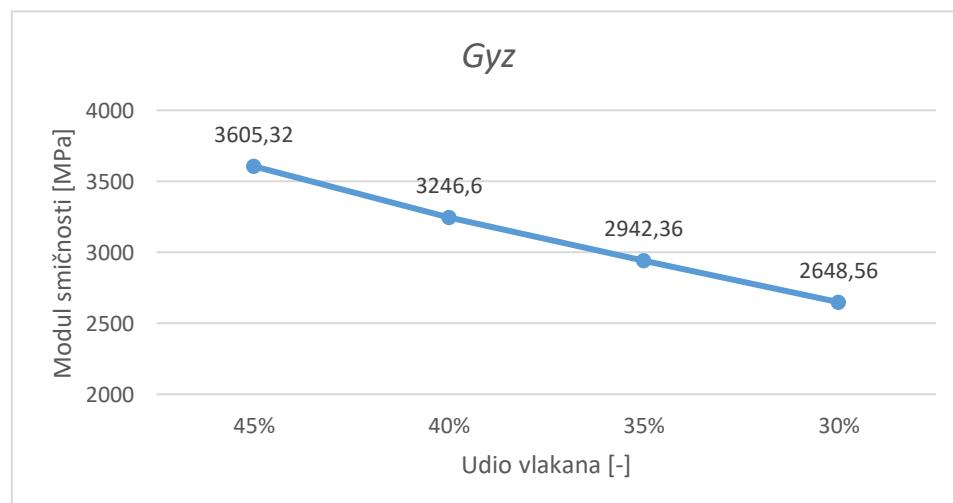
Slika 36. Moduli smičnosti u yz ravnini,  $G_{yz}$
