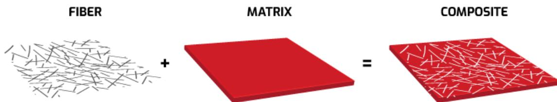
Slika 3. Nastanak kompozita ojačanog vlaknima [7]
