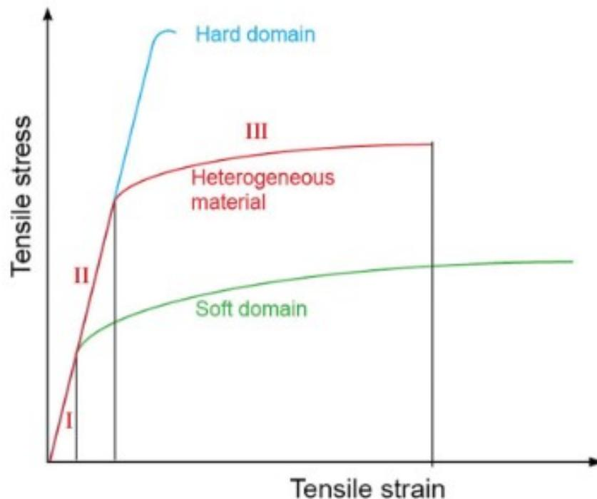
Slika 1. Tri faze deformacije heterogenog materijala [3]
