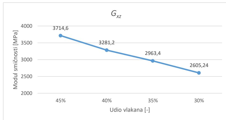
Slika 35. Moduli smičnosti u xz ravnini,  $G_{xz}$
