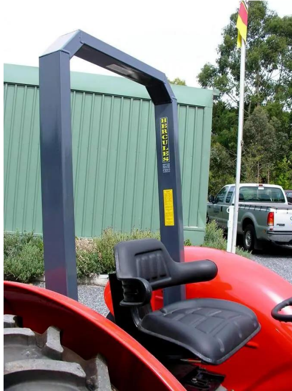
Slika 3 Zaštitni okvir s dva stupa
