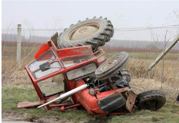
Slika 2 Prevrtnanje traktora sa zaštitnom konstrukcijom
