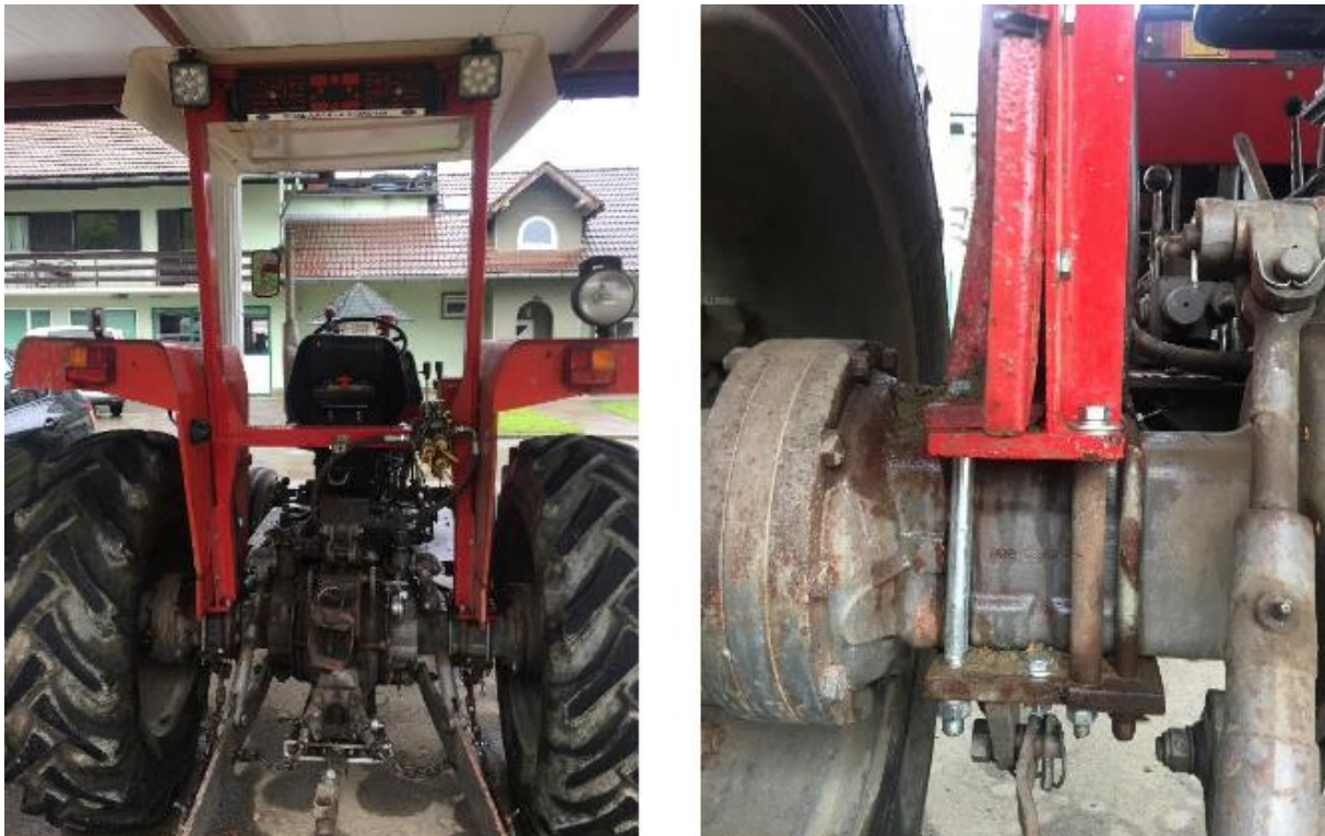
Slika 24 Način vezanja okvira za traktor IMT 560 [10]
