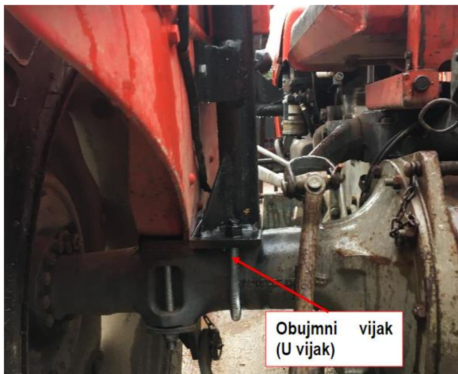
Slika 25 Način vezanja okvira za traktor IMT 539 [12]
