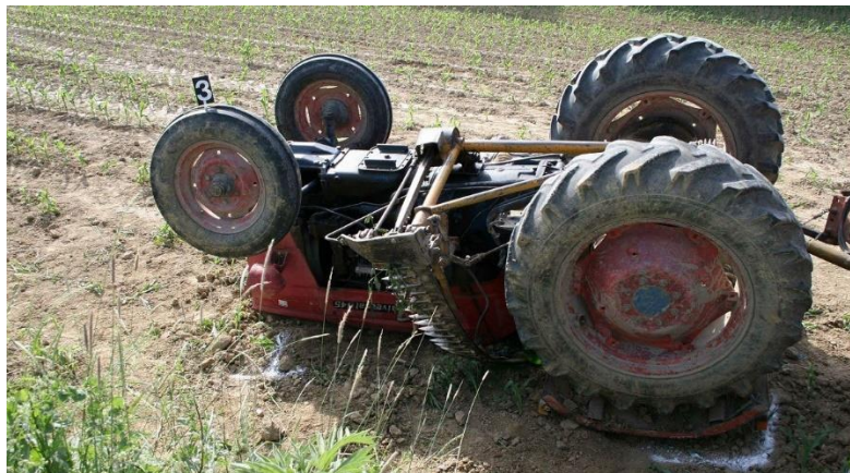
Slika 1 Prevrtnje traktora bez zaštitne konstrukcije
