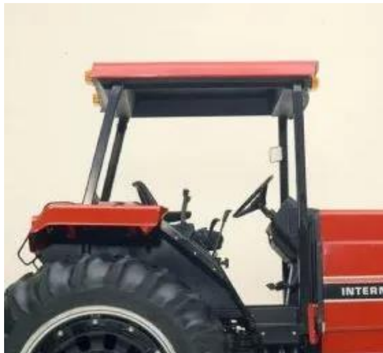
Slika 4 Zaštitni okvir s 4 stupa
