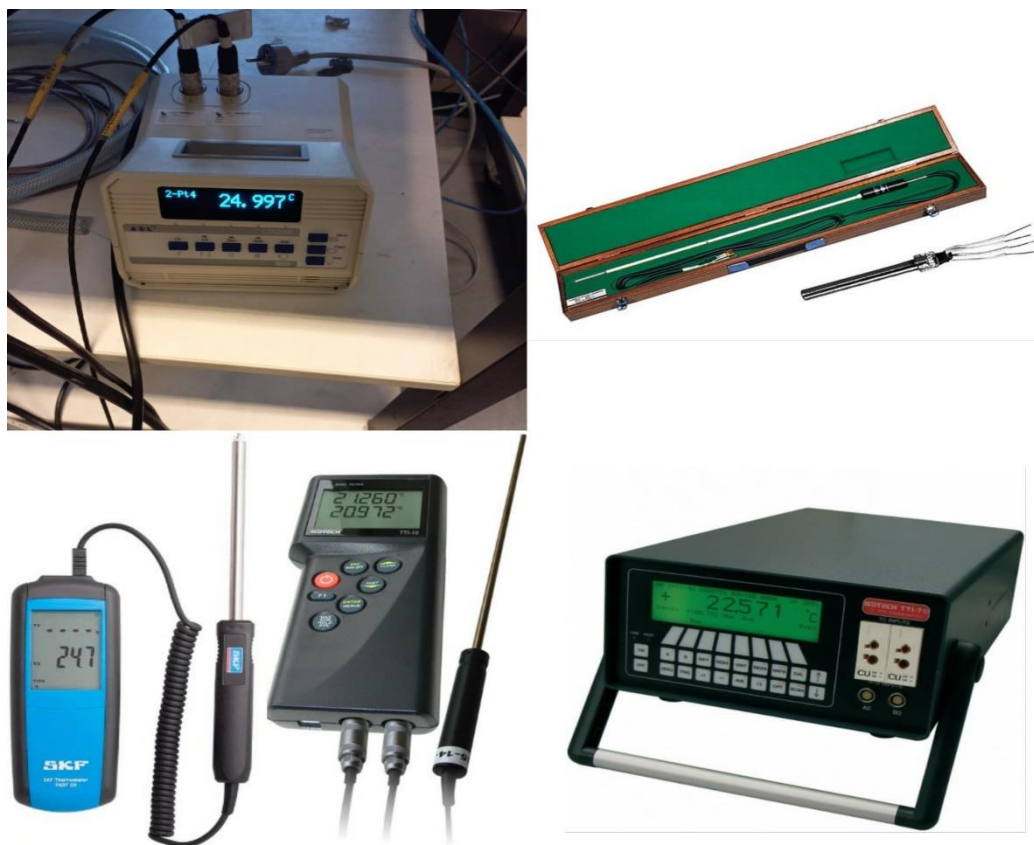
Slika 5. Prikaz nekoliko termometara s otporničkim osjetnicima
