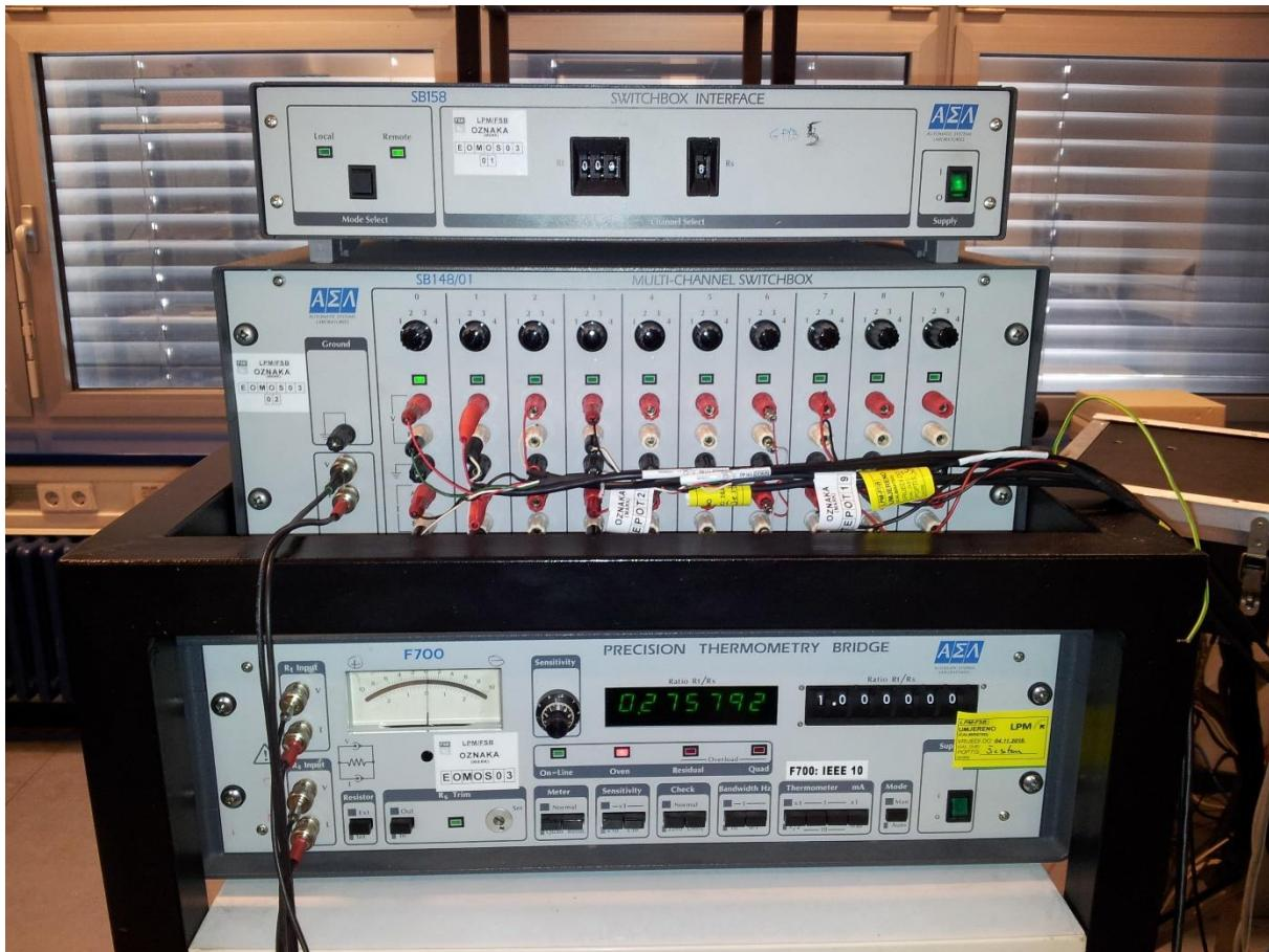
Slika 17. Termometrijski otpornički most etalonskog termometra
