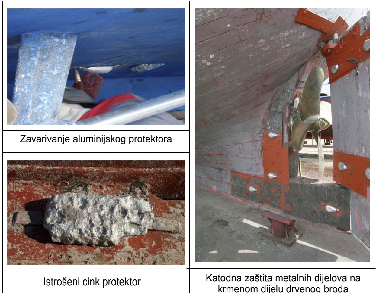
Slika 16. Katodna zaštita broda žrtvovanim anodama [3,7]
