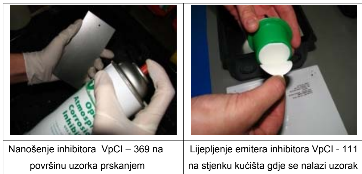
Slika 35. Nanošenje hlapivih inhibitora u Laboratoriju za zaštitu materijala, FSB [3]
