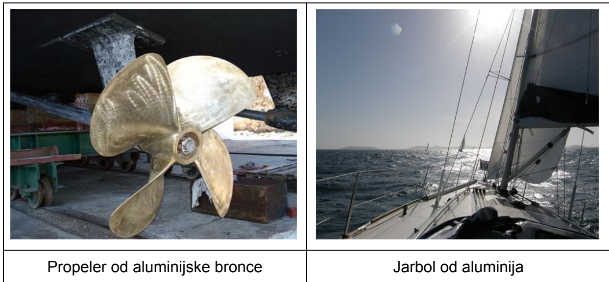
Slika 18. Primjena aluminija i Al - slitina u brodogradnji [7]
