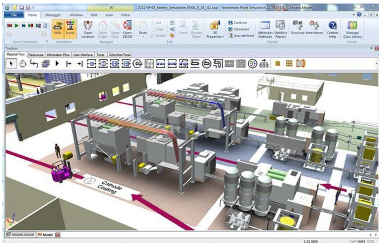
Slika 5. Simulacija pogona u Siemens Tecnomatix [13]
