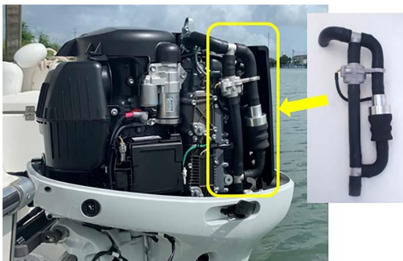
Slika 16. Sustav za hlađenje
