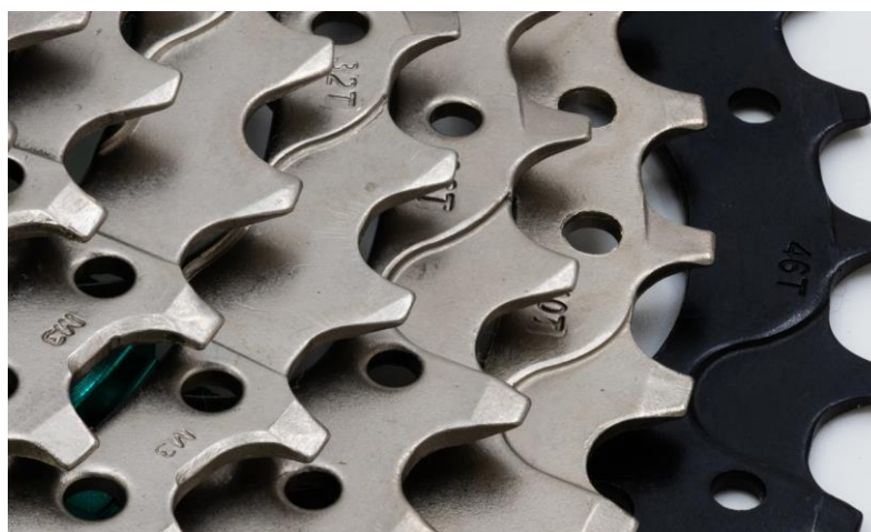
Slika 5: Geometrija lančanika kazete [9]
