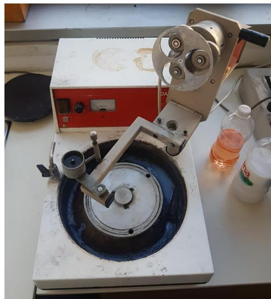
Slika 17: Polirka za poliranje metalografskog uzorka
