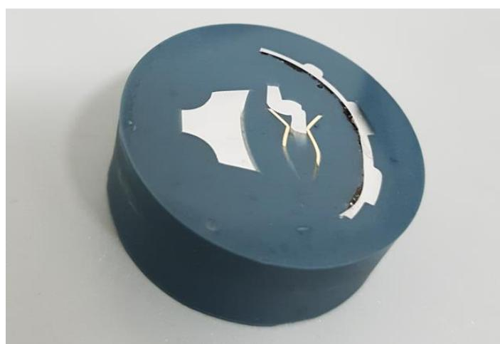
Slika 18: Polirani metalografski uzorak
