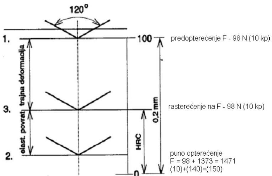
Slika 11: Princip mjerena tvrdoće *HRC* metodom [19]
