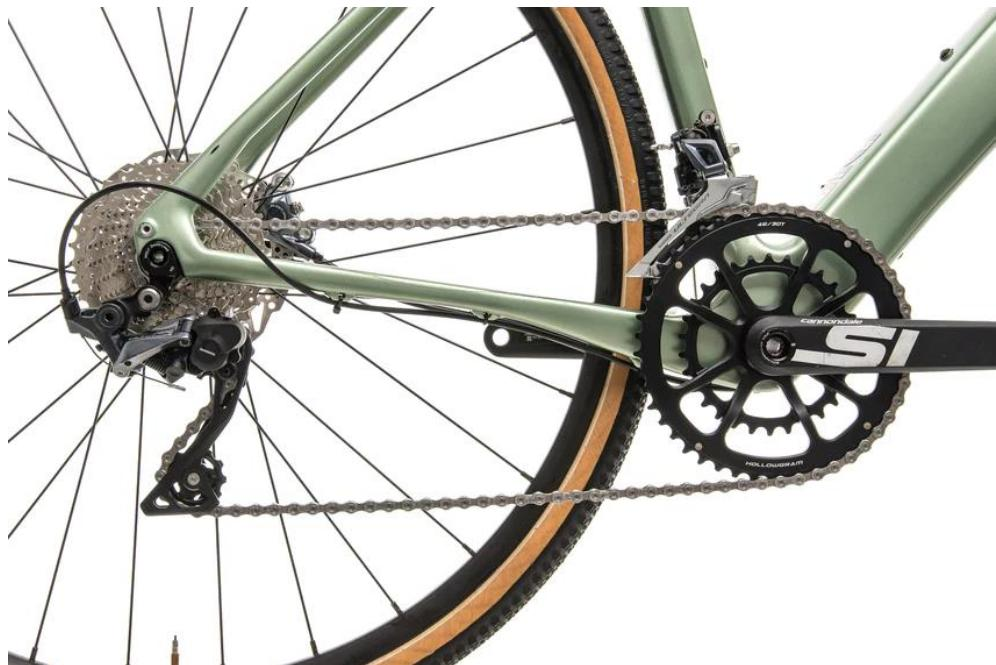
Slika 2: Višebrzinski pogonski sklop [3]
