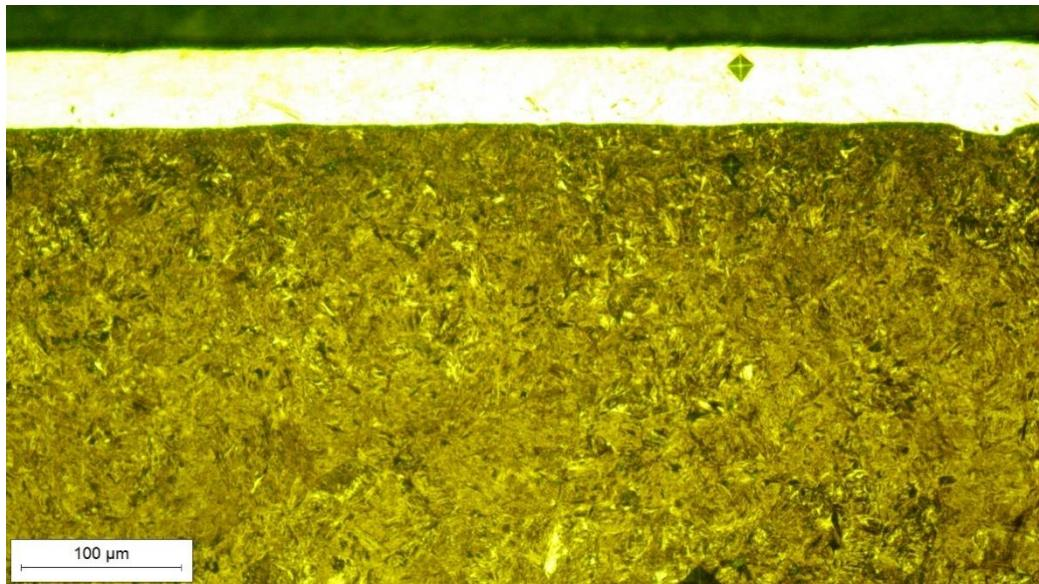
Slika 30: Mikrostruktura velikog lančanika
