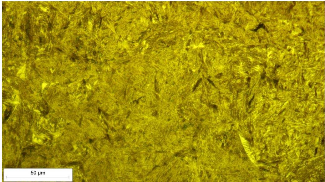
Slika 31: Mikrostruktura malog lančanika
