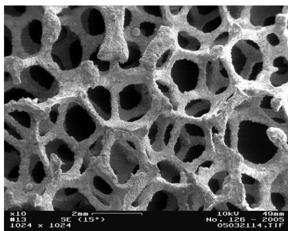
Slika 12: SEM slika metalne pjene [20]
