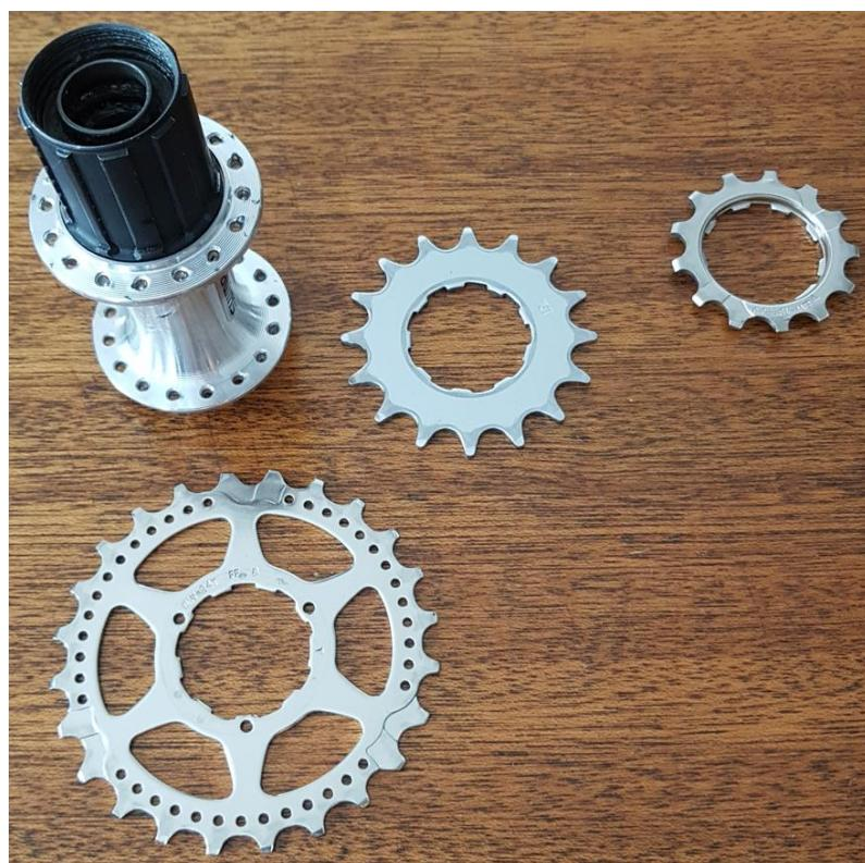
Slika 15: Lančanici i tijelo glavčine za ispitivanje
