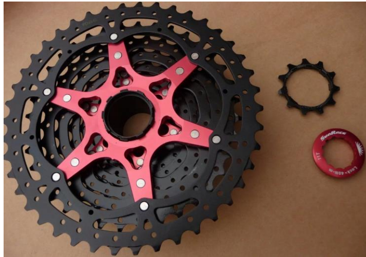
Slika 6: Kućište kazete i stezna kapica [10]
