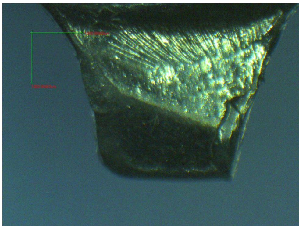
**Slika 24: Veliki lančanik s vidljivim otkrhnućem dijela zupca uzrokovano umorom površine (na slici desno), tragovi abrazivnog trošenja od dodira s lancem (na slici gore)**
