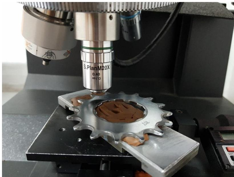
Slika 26: Mjerenje tvrdoće jednобрzinskog lančanika
