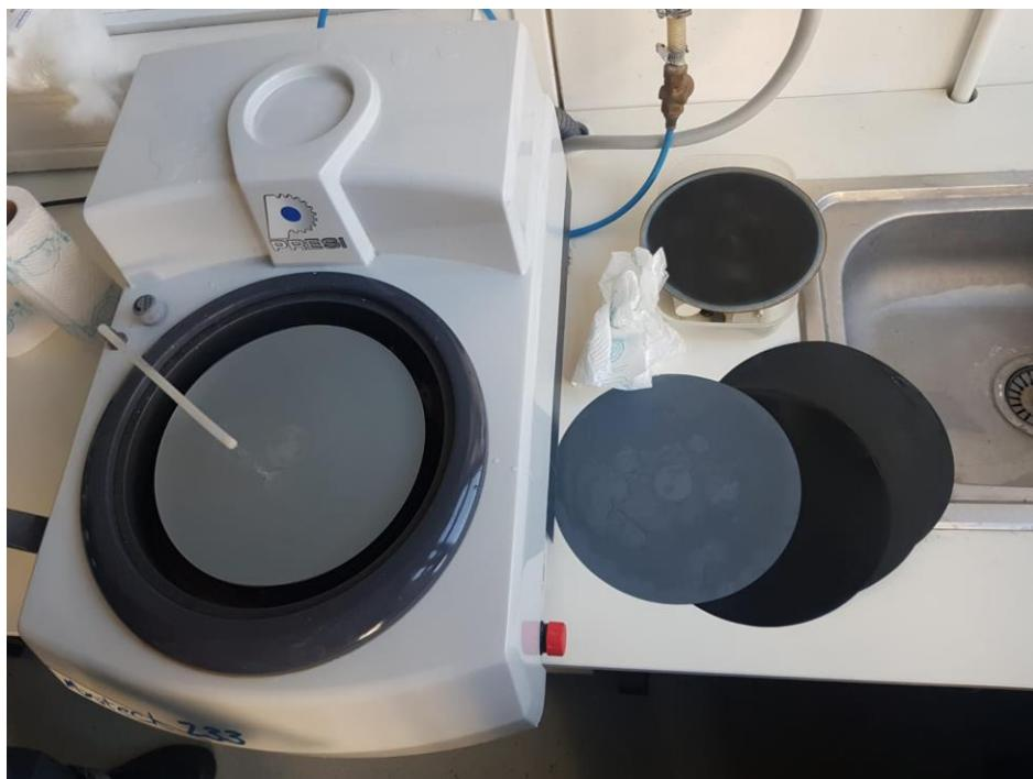
Slika 16: Brusilica za brušenje metalografskog uzorka
