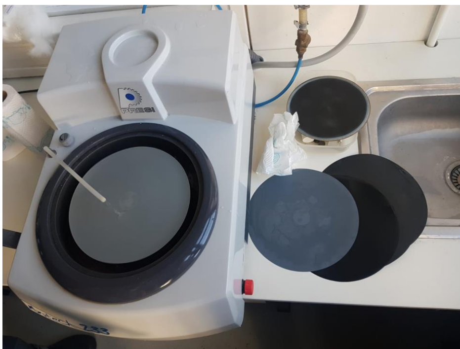
Slika 16: Brusilica za brušenje metalografskog uzorka
