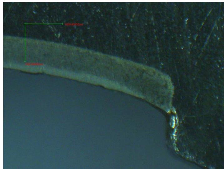
**Slika 22: Oštećenje lančanika u dodiru s tijelom glavčine**
