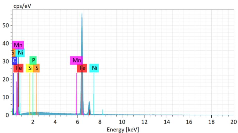
**Slika 36: EDX spektar dobiven analizom zupca lančanika**
