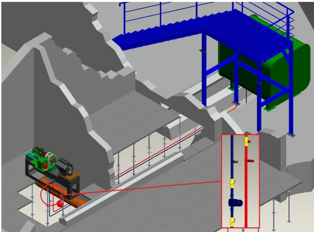
*Slika 5.12. Model laboratorija sa kočnicom i rashladnim sustavom*
