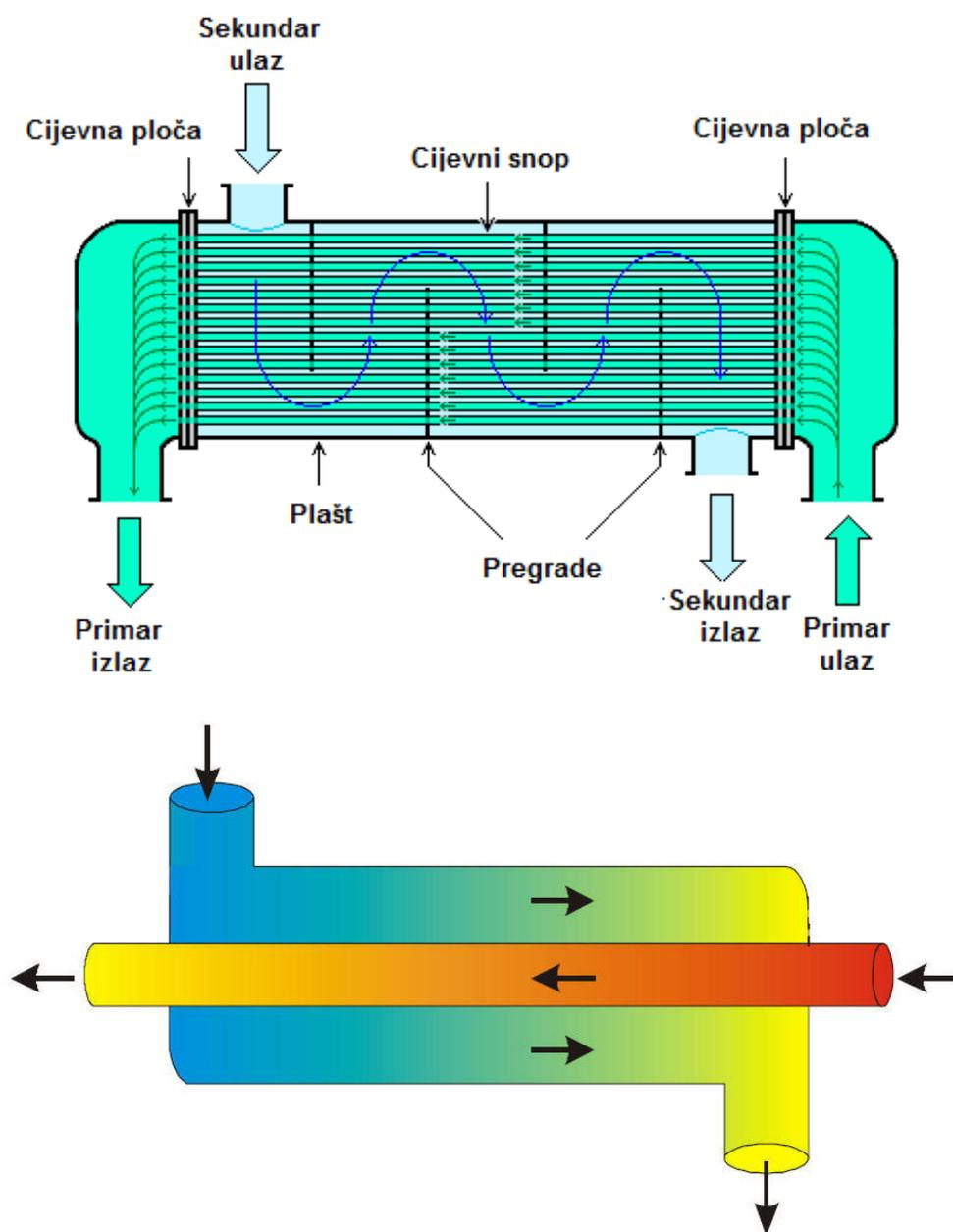
Slika 5.6. Shema protustrujnog izmjenjivača topline
