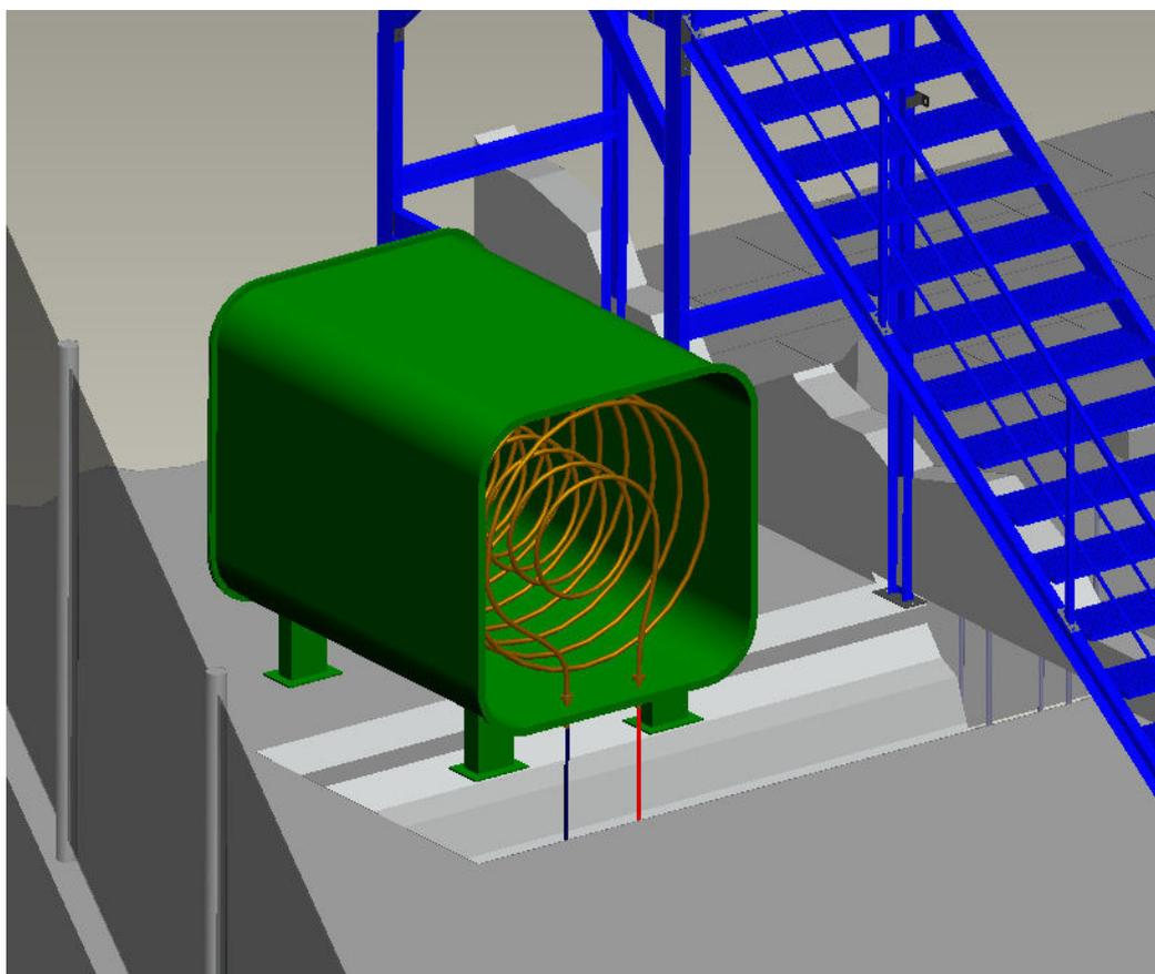
*Slika 5.13. Prikaz izmjenjivača topline (bakrene cijevi) unutar spremnika*
