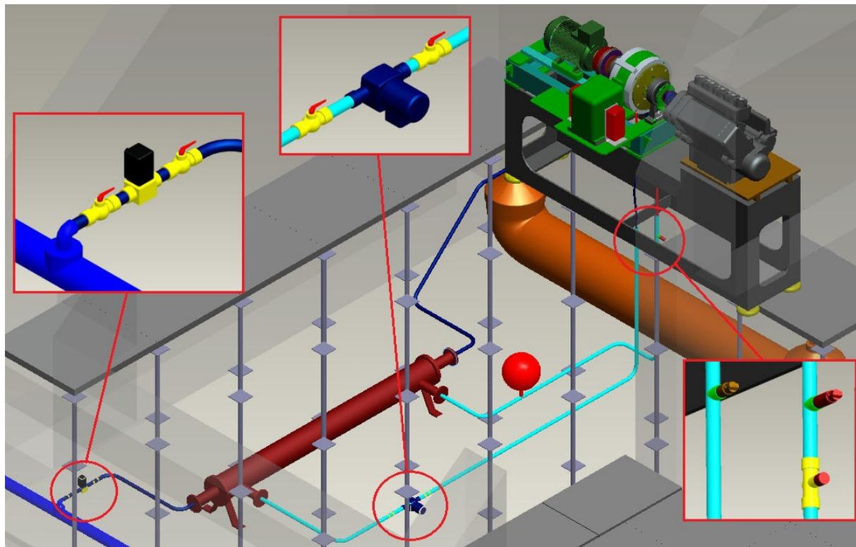
*Slika 5.8 Model laboratorija sa kočnicom i rashladnim sustavom*
