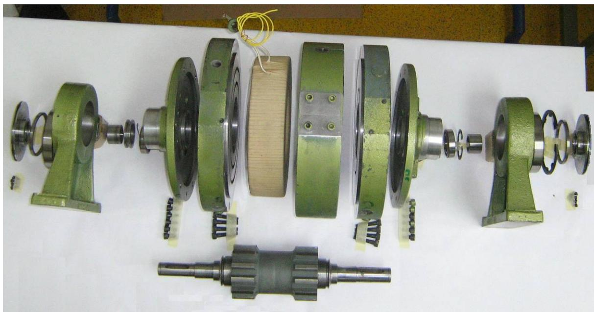
*Slika 1.2. Revitalizacija i priprema dijelova kočnice za slaganje*
