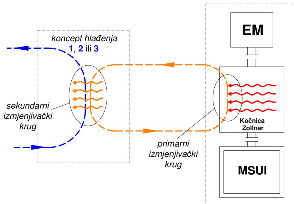
Slika 5.5. Definicija primarnog i sekundarnog kruga rashladnog sustava
