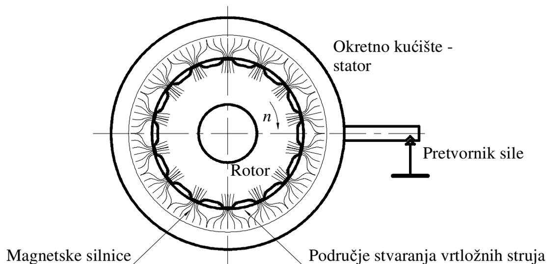
Slika 3.11. Prikaz odnosa vrtložnih sila i pretvornika sile
