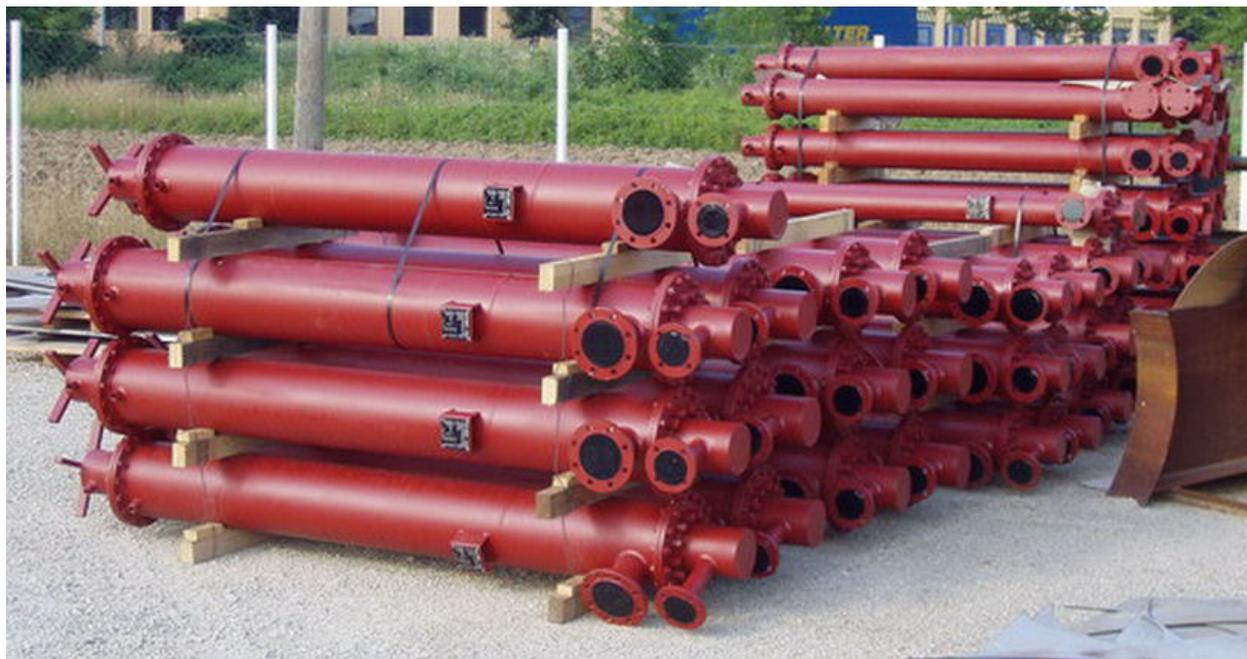
*Slika 5.9. Protustrujni tip izmjenjivača s registrom na izvlačenje*
