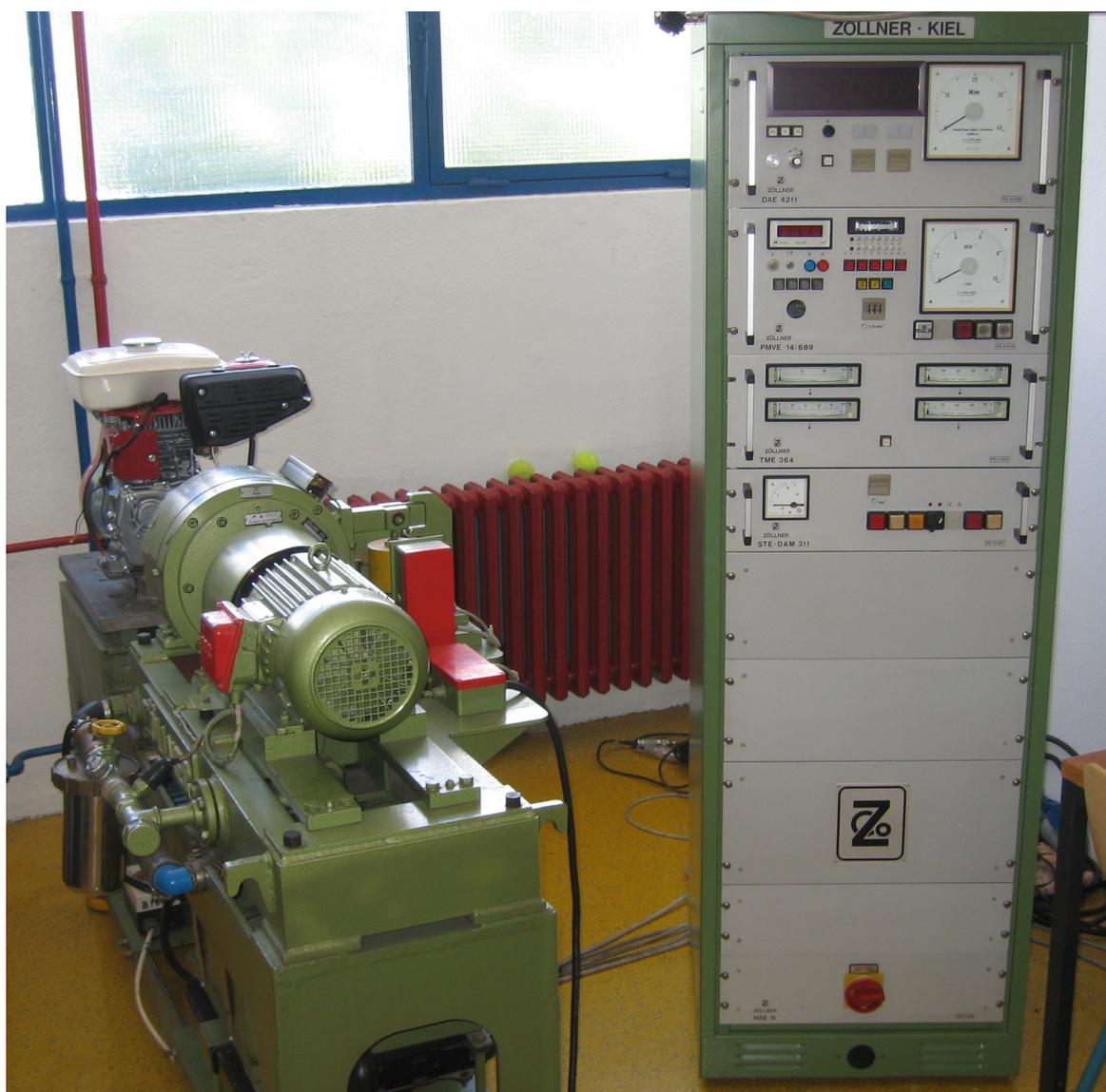
Slika 1.1. Električna kočnica ZÖLLNER tipa VA-100AC DAM4PS
