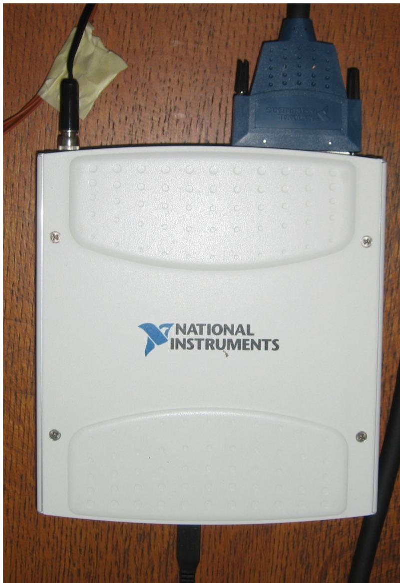
*Slika 6.8. Analogno - digitalni pretvarač NI USB 6251*
