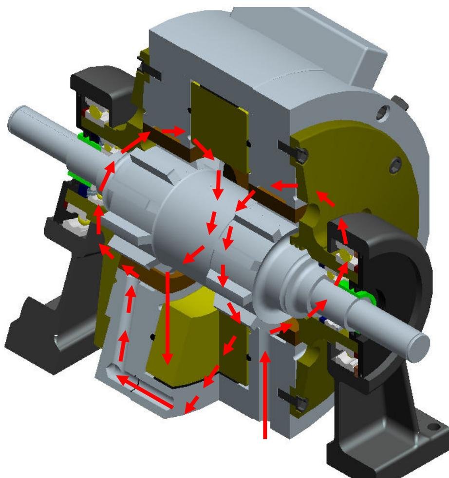
*Slika 4.3. Prikaz relativnog položaja rashladnih prolaza kućišta kočnice*
