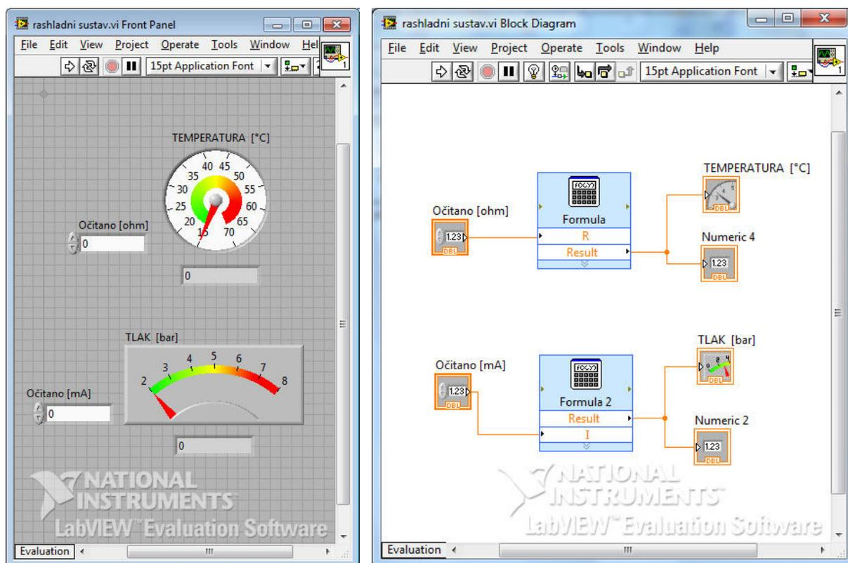
Slika 6.11. Izgled LabVIEW front-panel sučelja i blok dijagrama
