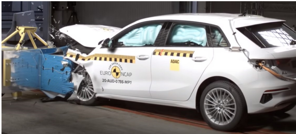
Slika 6. Prikaz oštećenja nosive strukture 2, MPDB test [5]
