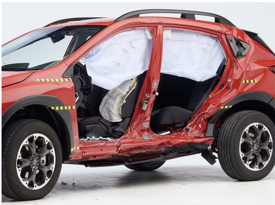
Slika 25. Oštećenje strukture vozila kod bočnog testa [7]
