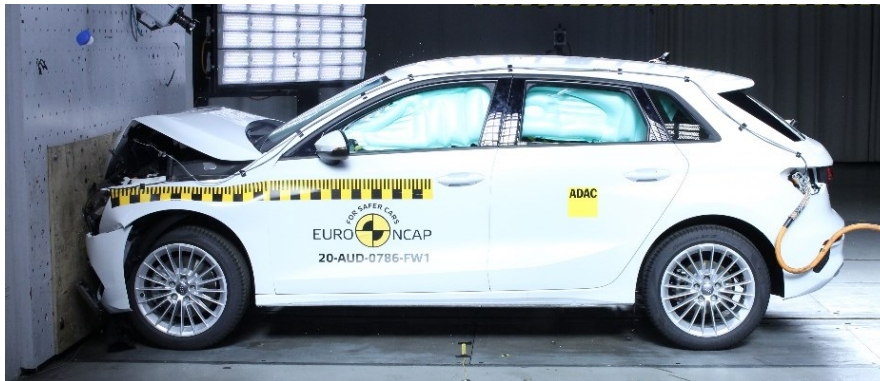
Slika 8. Prikaz oštećenja vozila 1, udar u nepokretnu barijeru [5]
