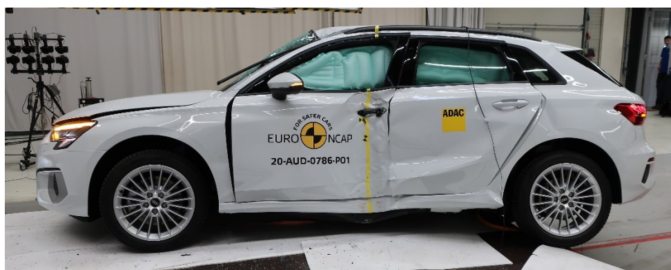
Slika 15. Prikaz oštećenja nosive strukture vozila 2, bočni udar u stup [5]
