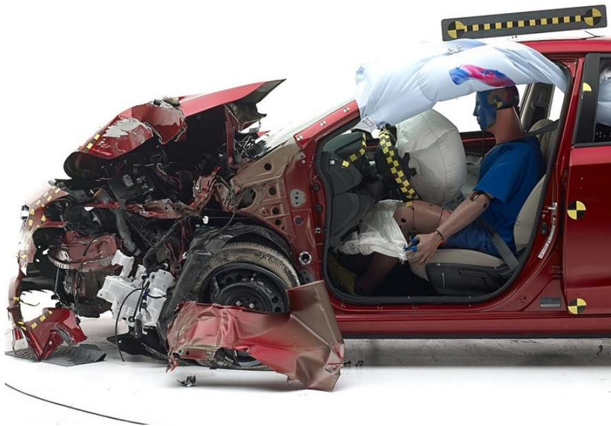
Slika 22. Small overlap test , oštećenje 2 [7]
