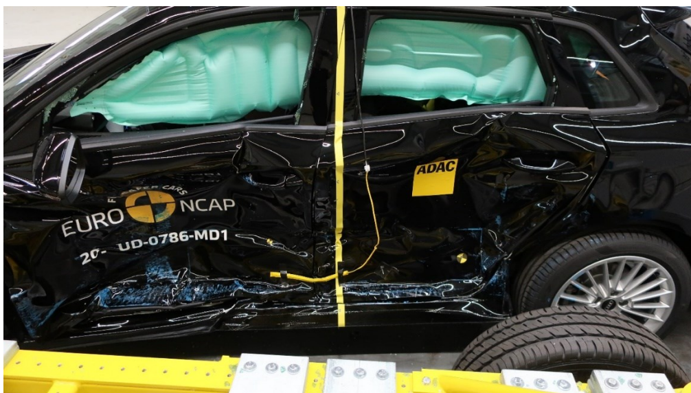
Slika 12. Oštećenje vozila 2, bočni udar [5]
