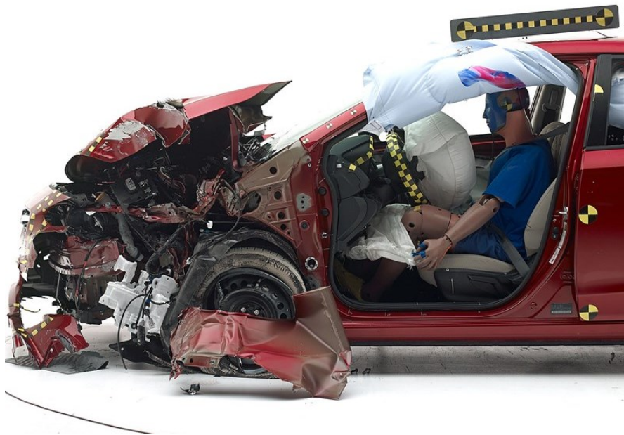
Slika 22. Small overlap test , oštećenje 2 [7]
