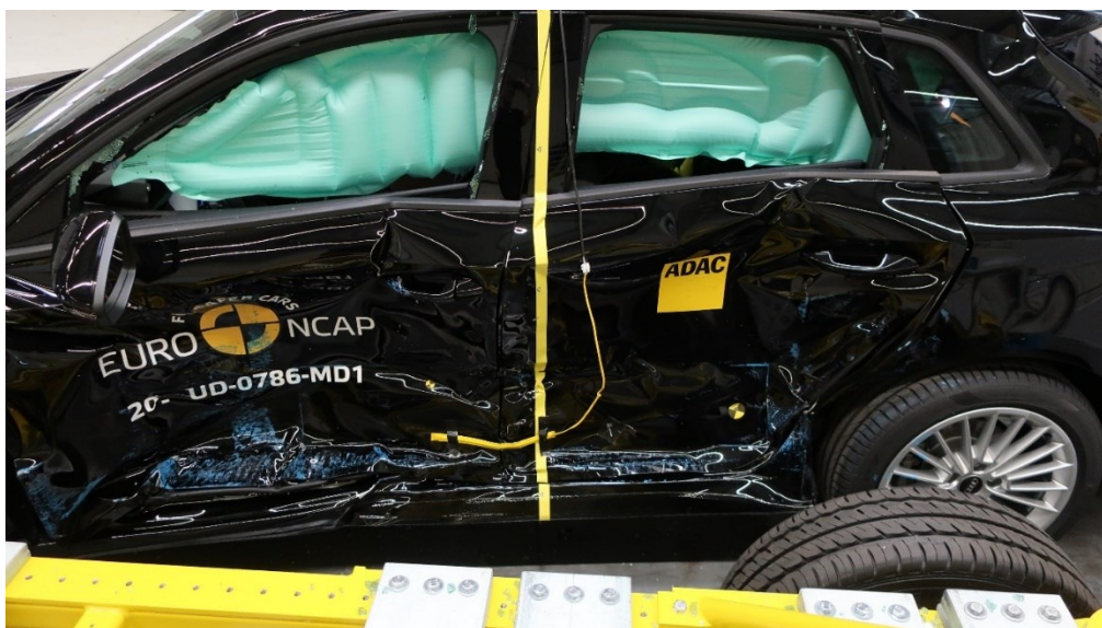
Slika 12. Oštećenje vozila 2, bočni udar [5]
