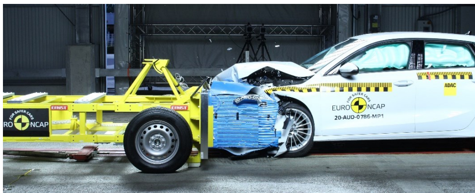
Slika 5. Prikaz oštećenja nosive strukture 1, MPDB test [5]
