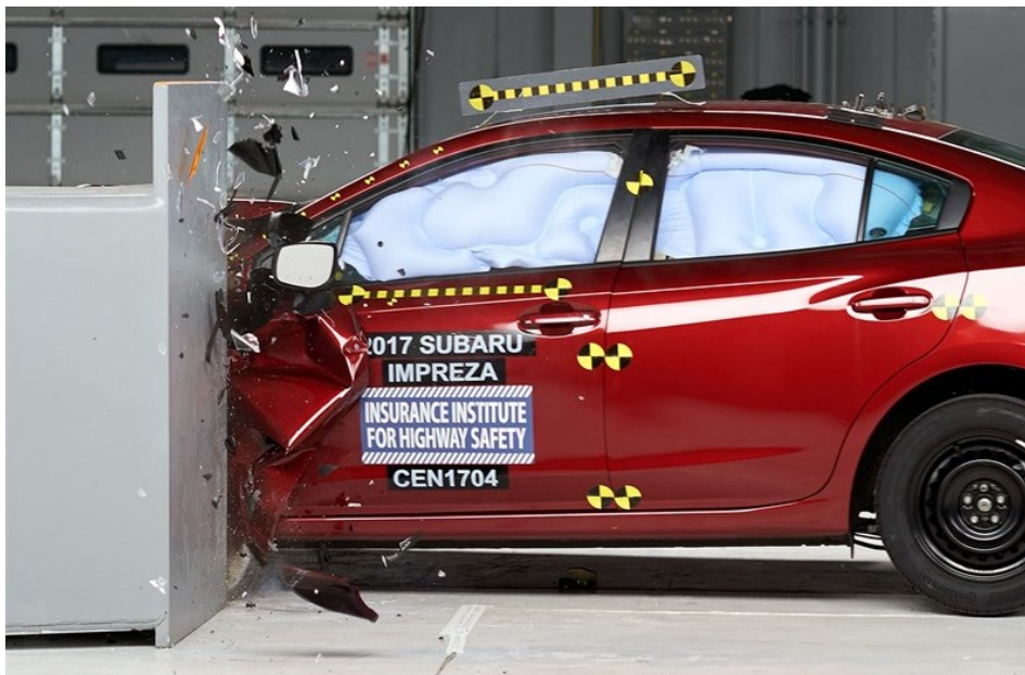
Slika 21. Small overlap test, oštećenje 1 [7]
