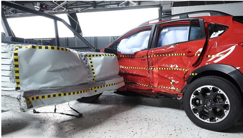
Slika 24. Oštećenje strukture vozila kod bočnog testa [7]
