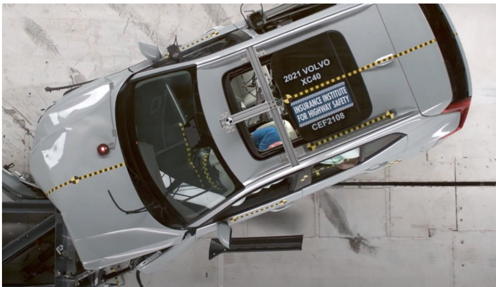
Slika 19. Deformacije nosive strukture kod testa prednji udar sa srednjim preklapanjem [6]
