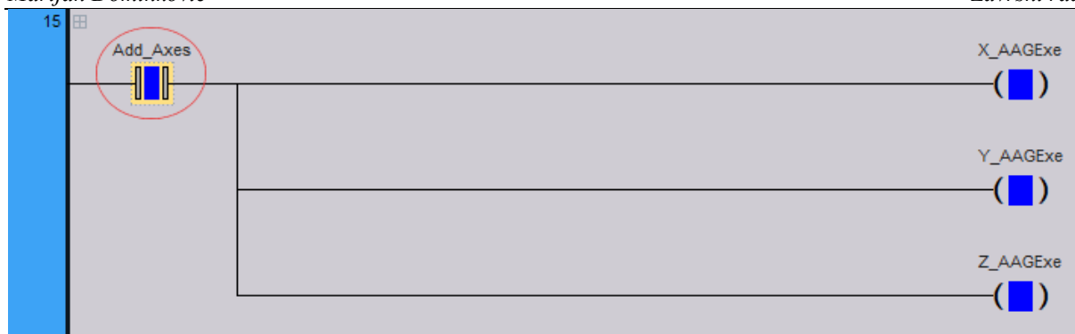
Slika 5.6. – Pokretanje operacije kreiranja grupe osi
