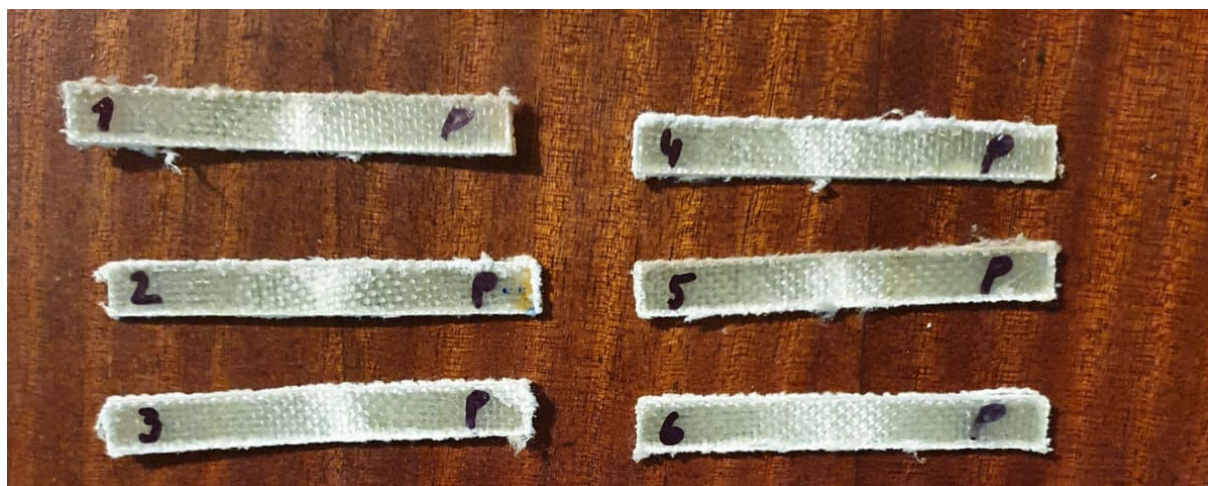
Slika 47. Epruvete kompozita ojačanog polietilenskim vlaknima nakon ispitivanja žilavosti
