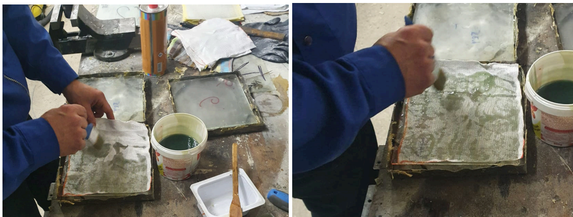
Slika 20. Slaganje slojeva vlakana i premazivanje
