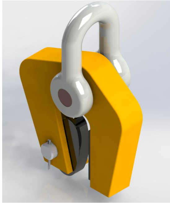
Slika 17. Model samokočne hvataljke
