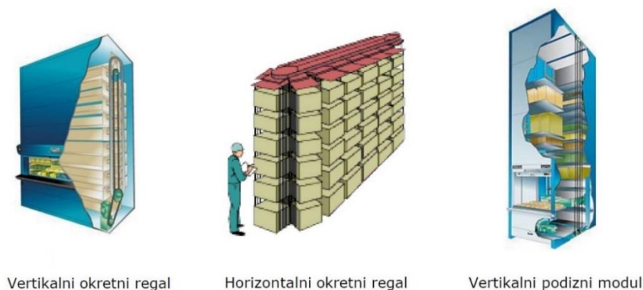
Slika 10. Okretni regali i vertikalni podizni modul
