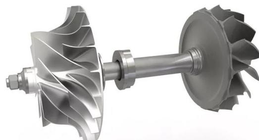
Slika 9. Rotor turbine i kompresora spojeni vratilom [31]
