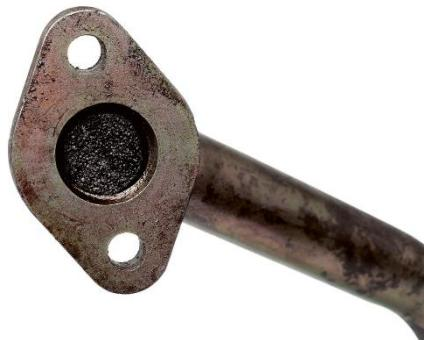
Slika 28. Začepljenje vodova uslijed karbonizacije ulja [11]
