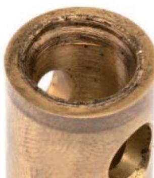
Slika 24. Abrazijska oštećenja čahure ležaja [11]
