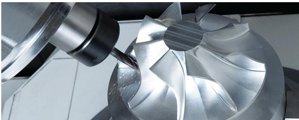
Slika 14. Rotor kompresora izrađen postupkom 5-osnog glodanja [26]
