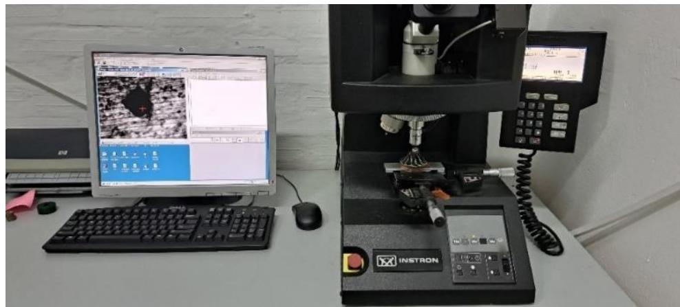
**Slika 44.** Tvrdomjer INSTRON Wilson-Wolpert Tukon 2100B povezan s računalom
