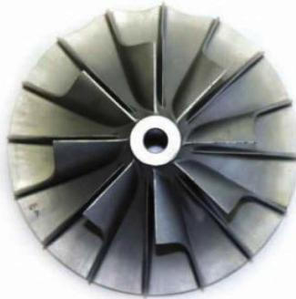
Slika 15. Rotor kompresora s radijalnim lopaticama [15]
