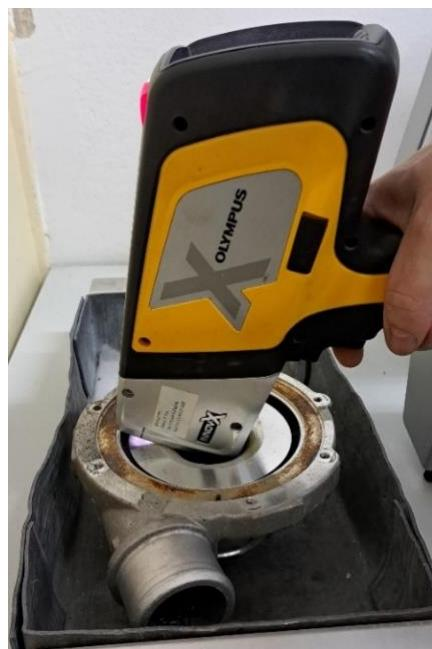
**Slika 43.** XRF analiza kućišta kompresora
