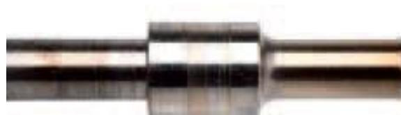
Slika 26. Tragovi trošenja na spojnom vratilu [11]
