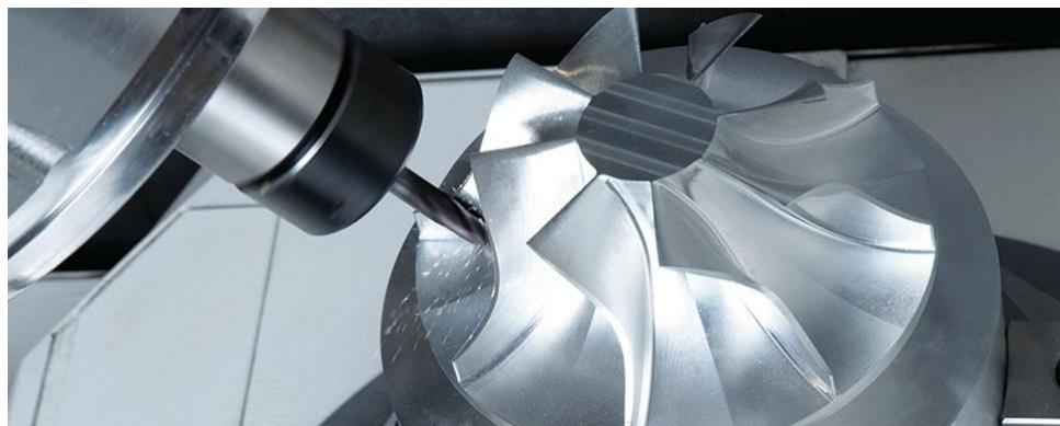
Slika 14. Rotor kompresora izrađen postupkom 5-osnog glodanja [26]
