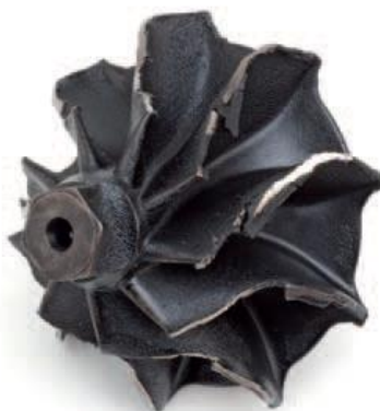
Slika 25. Oštećeni rotor turbine nakon kontakta s kućištem [11]
