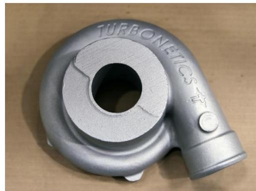
**Slika 19. Odlijevak kućišta kompresora prije strojne obrade [23]**
