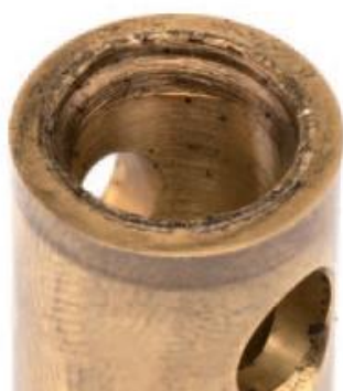
Slika 24. Abrazijska oštećenja čahure ležaja [11]
