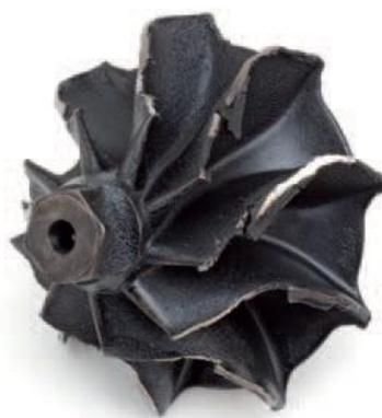
Slika 25. Oštećeni rotor turbine nakon kontakta s kućištem [11]
