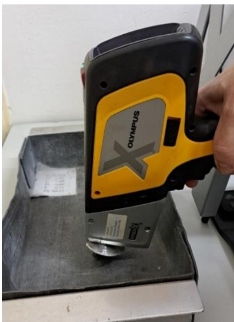
Slika 42. XRF analiza rotora kompresora
