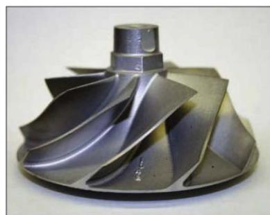
Slika 16. Rotor kompresora sa stalnim promjerom lopatica [15]
