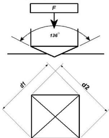
Slika 32. Mjerjenje tvrdoće po Vickersu [2]
