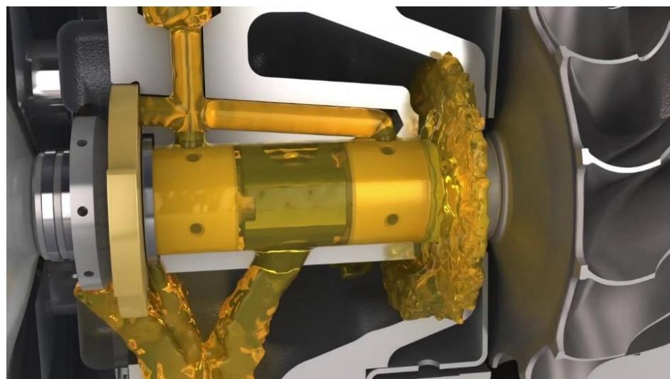
Slika 27. Animacija podmazivanja turbopunjača motornim uljem [24]
