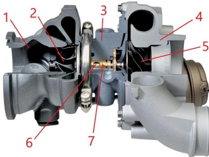
Slika 8. Dijelovi turbopunjača [35]
