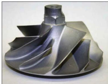
Slika 17. Rotor s naizmjenično kraćom lopaticom [15]
