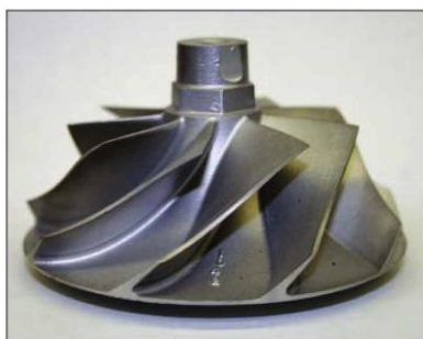
Slika 16. Rotor kompresora sa stalnim promjerom lopatica [15]
