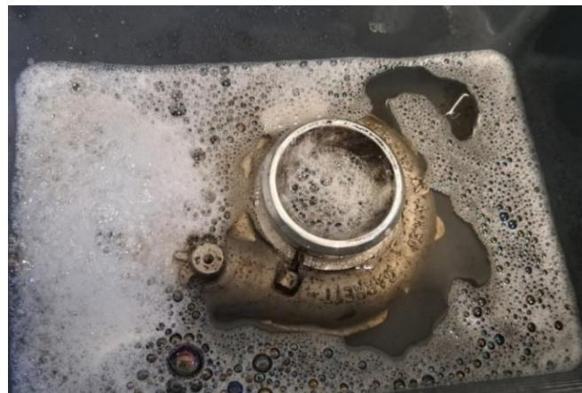
Slika 36. Odmašćivanje kućišta kompresora u sredstvu za odmašćivanje
