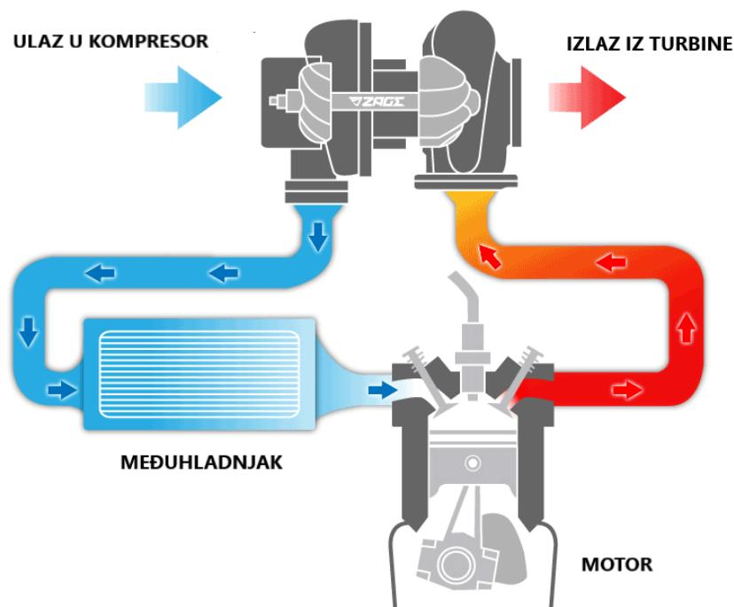
**Slika 7. Dijelovi sustava turbopunjjenja**
