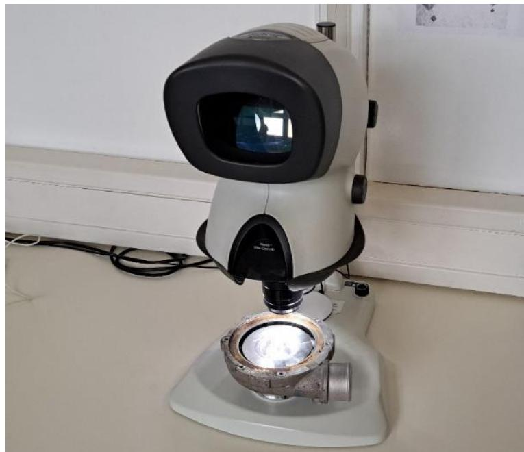
**Slika 53. Stereo mikroskop Mantis Elite-Cam HD**
