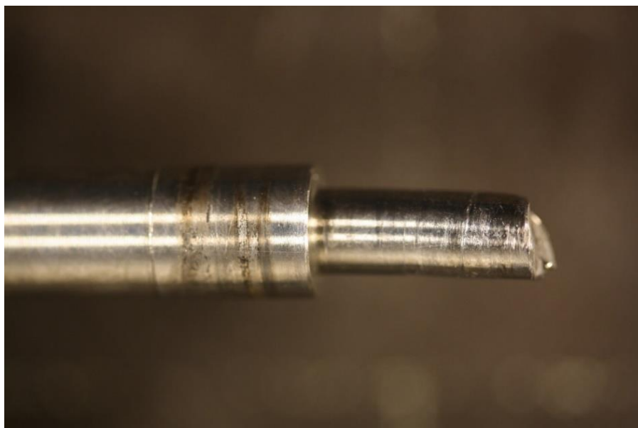
Slika 65. Lomna površina spojnog vratila
