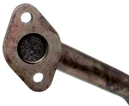
Slika 28. Začepljenje vodova uslijed karbonizacije ulja [11]
