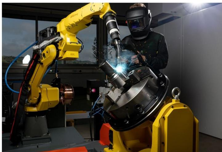
**Slika 21. Primjena pozicionera tijekom robotiziranog zavarivanja [35]**
