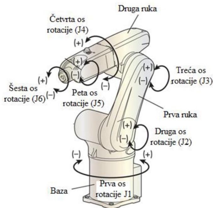
Slika 19. Primjer robota sa šest rotacijskih zglobova [33]
