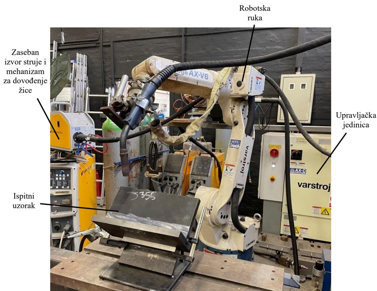
Slika 23. Robotizirana zavarivačka stanica i uzorak prije zavarivanja
