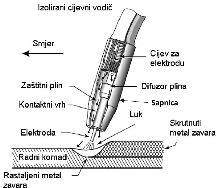
Slika 3. Shematski prikaz vrha pištolja tijekom zavarivanja [11]
