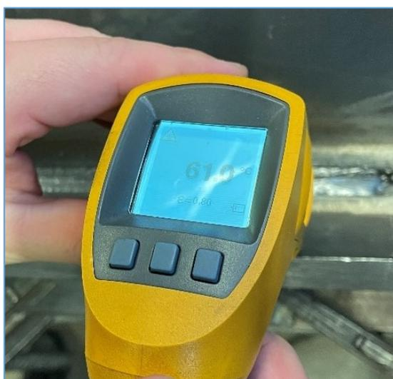
Slika 31. Infracrveni termometar
