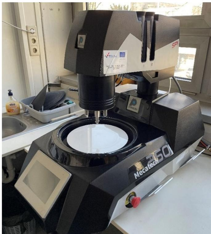
Slika 45. Uređaj za brušenje Mecatech 25
