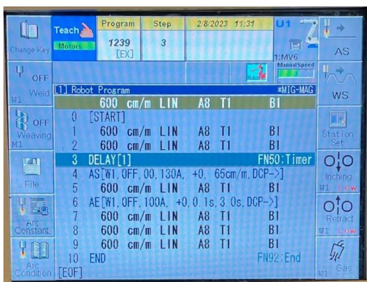
Slika 34. Program za zavarivanje uzorka 1F3
