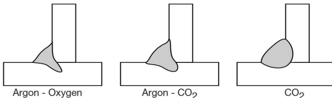
Slika 18. Utjecaj dvokomponentnih mješavina plinova i čistog CO<sub>2</sub> na profil zavara [13]
