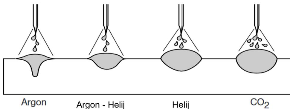
Slika 15. Shematski prikaz profila zavara za određene plinove [13]
