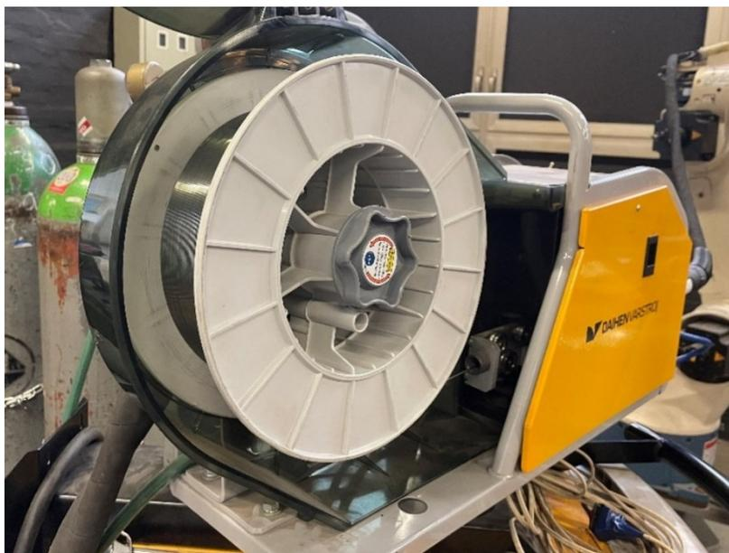
Slika 29. Kolut sa žicom u mehanizmu za dovođenje žice
