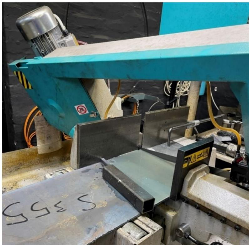
Slika 32. Rezanje ploče osnovnog materijala na tračnoj pili
