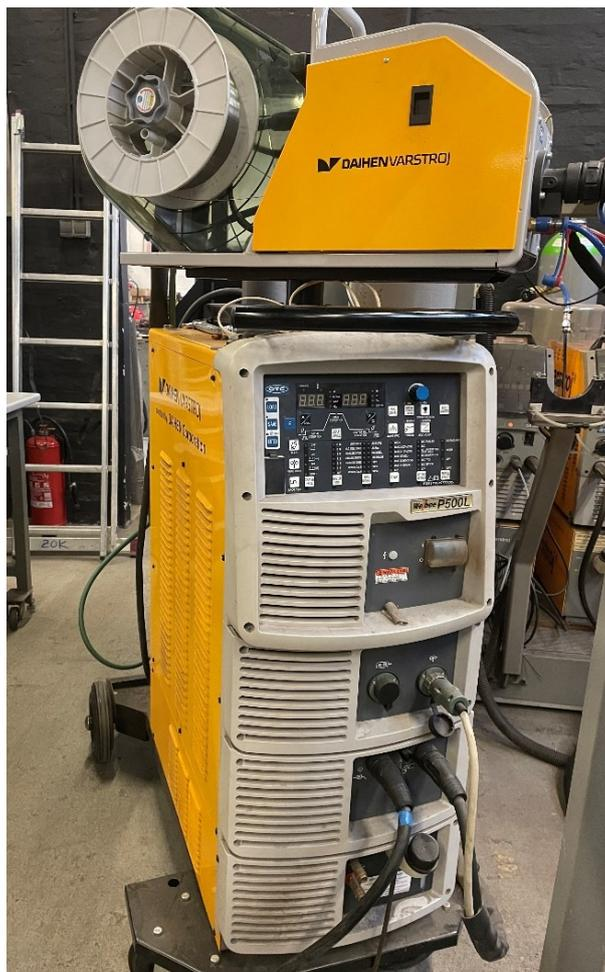
Slika 25. Izvor struje i mehanizam za dovođenje žice
