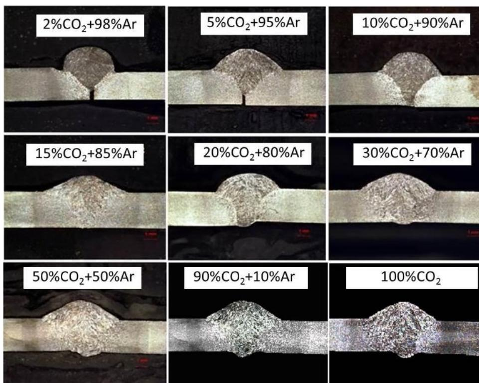
Slika 17. Profil zavara za određene mješavine Ar i CO<sub>2</sub> [23]
