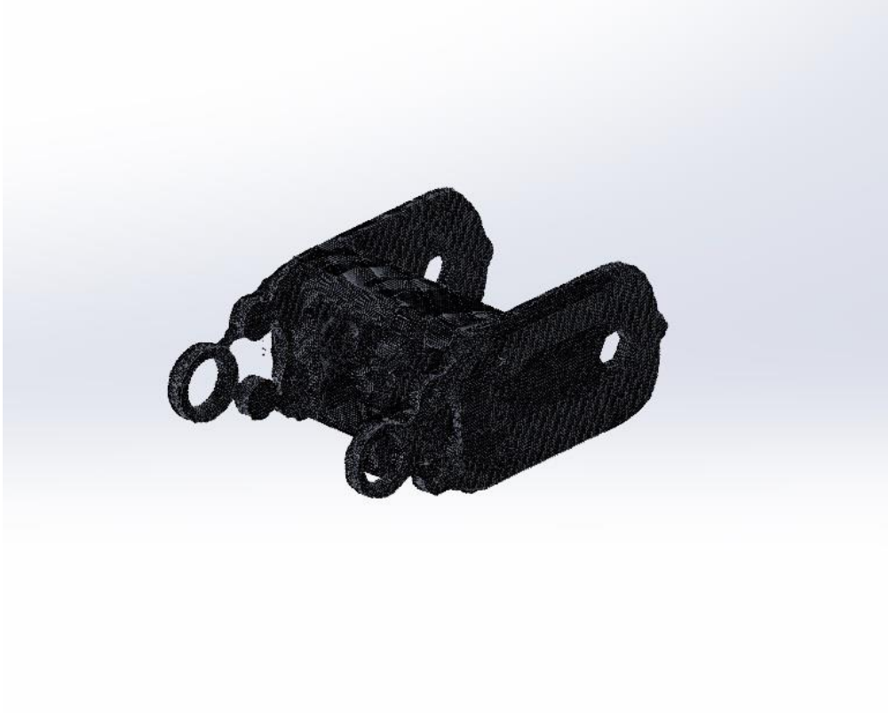
Slika 24. Topološki optimirana podlaktica u programu Solidworks
