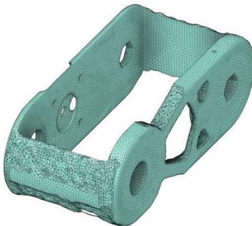
Slika 27. Topološki optimirana nadlaktica u programu Fusion 360
