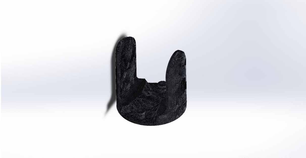
Slika 22. Topološki optimirano rame u programu Solidworks
