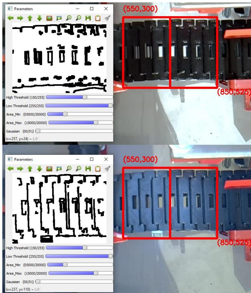
**Slika 19. Usporedba slike s i bez primjene osvjetljenja**
