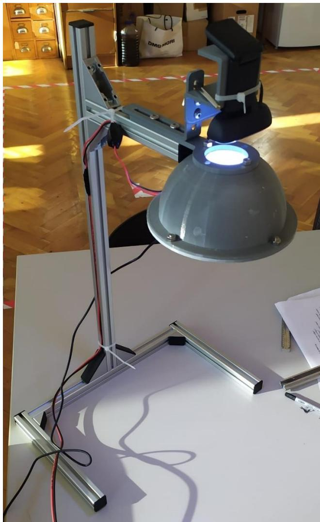
**Slika 18. Nosač s kupolnim svjetлом i kamerom**
